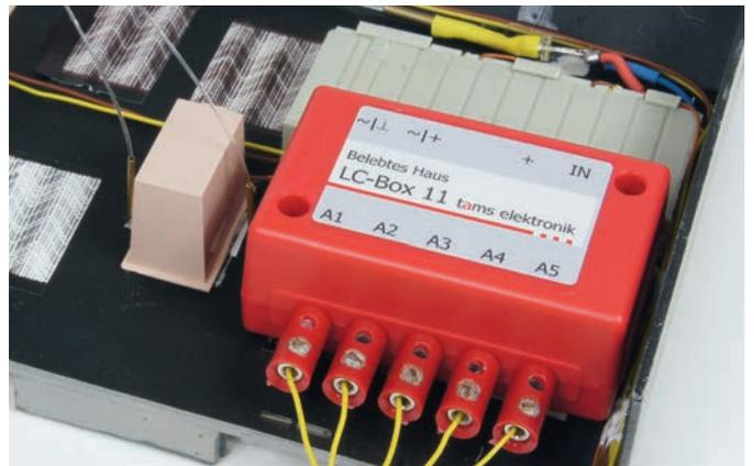
... sowie mit Gehäuse, hier innerhalb eines Gebäudes eingebaut.
