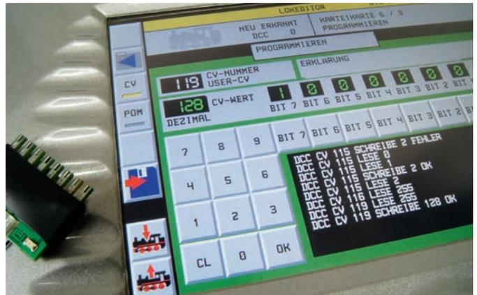
Programmieren lässt sie sich über CVs mit Hilfe einer Digitalzentrale.
