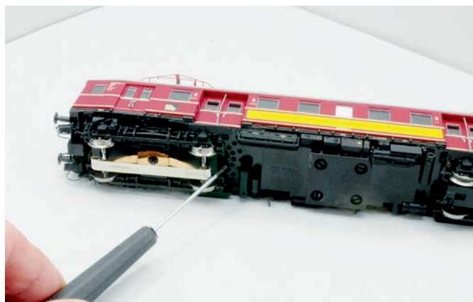
Die Schallöffnungen zeigen: Der Platz für den Lautsprecher ist im Fahrwerk.
