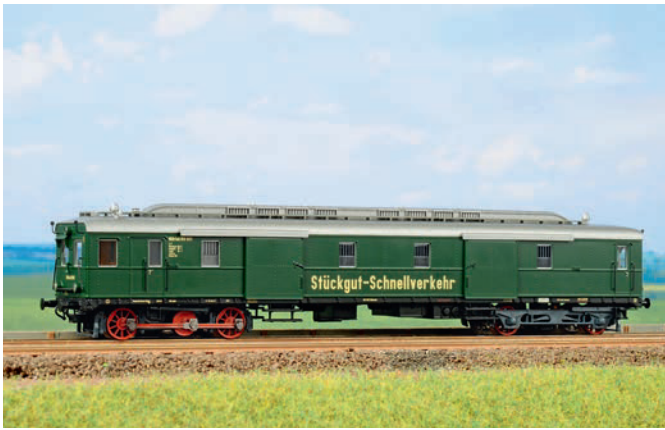
Der VT 10 (hier als VT 69.9 der DB) ist mit vier Schiebetüren ausgestattet.
