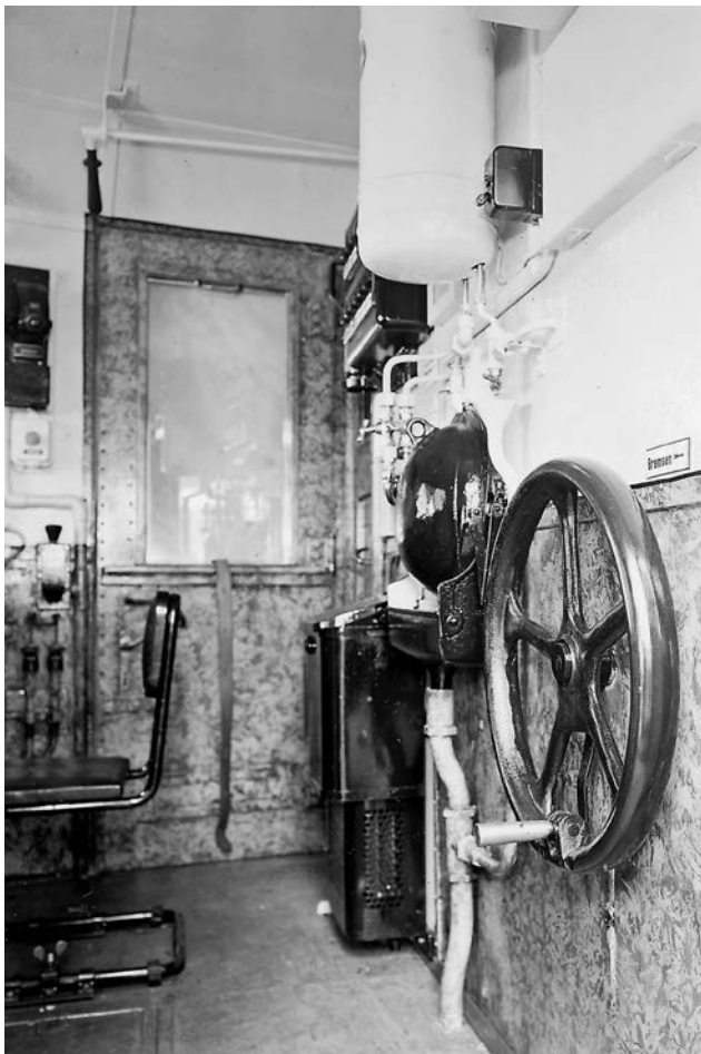
Vorderer Führerraum der E 18 44 (Bild oben). An der Rückwand gab es ein Waschbecken (hier hochgeklappt) mit Warmwasserspender. FOTOS: RBD HALLE, AEG/SLG. ASMUS
