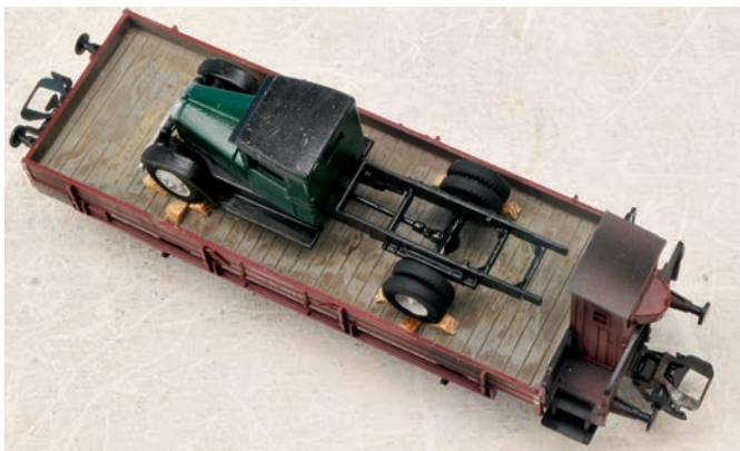
Für jedes Rad sind drei Keile nötig: vorne, hinten und an der Außenseite.
