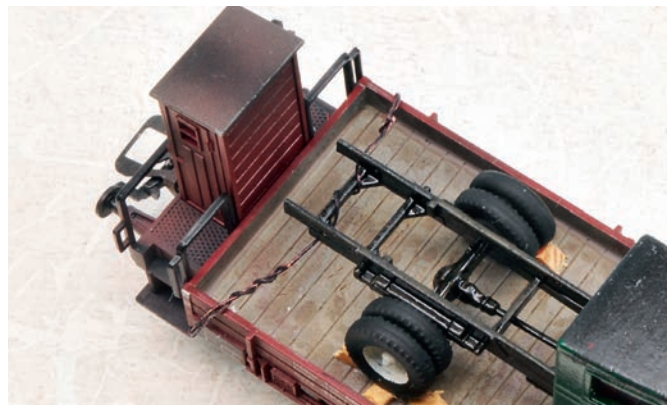
Hinten wird der Rödeldraht um einen Querträger geschlungen.
