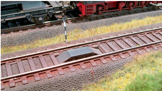
Ferngesteuerte Entkuppler (hier von Roco) verlangen, dass die zu trennenden Fahrzeuge genau darüber platziert werden müssen.
