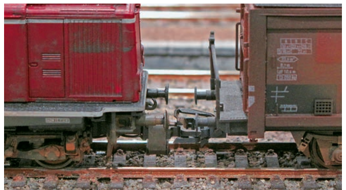
Lokomotiven mit fernsteuerbarer Kupplung (hier eine V 100 von Roco) sind vor allem als ständige Rangierlok eines Bahnhofs sinnvoll.
