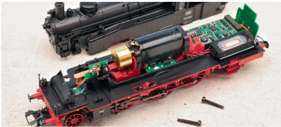
Aufgeräumt: Hinter dem Motor mit Schwungmasse sind Decoder und Lautsprecher untergebracht. Sie werden vom Führerhausboden verdeckt. Vorne die Platinen für Licht und Rauchsatz.
