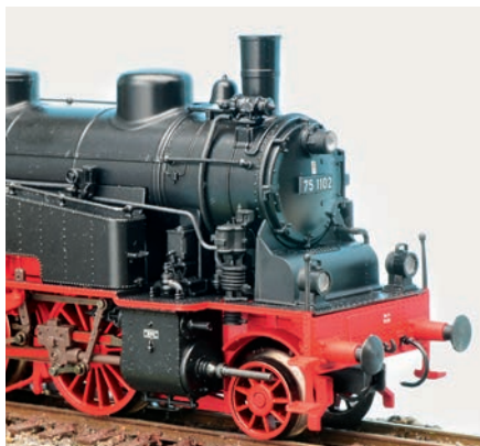
Typisch für die 75.10 sind die zahlreichen Hilfsaggregate neben und auf der Rauchkammer.
