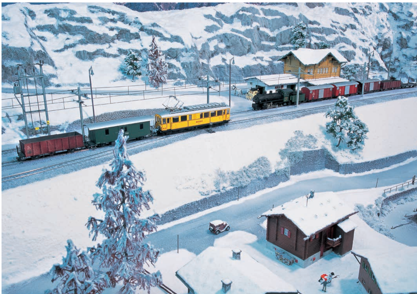
Kreuzung des Bernina-Triebwagens mit einem dampfgeführten Güterzug. Weil die Strecke nur eingleisig ist, muss die G 4/5 warten.
