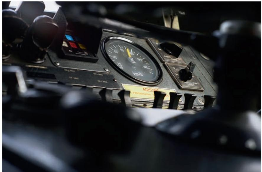
Die 90 Stundenkilometer sind fast erreicht – mehr lässt der Schienenschleifzug am Haken nicht zu. Manche Ausrüstung ist auf dem Führerstand gegenüber früher dazugekommen, die Sicherheitstechnik ist komplexer geworden. Anderes atmet den Geist „echten Fahrens“, wie es Lokführer auf Maschinen der V 160-Familie bisweilen ausdrücken: Handschaltrad, „Knochen“ und Anfahrtable gehören dazu.
