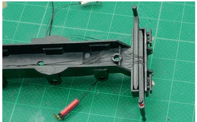
Die Kabel der hinteren LEDs sind über die Stützen zu ziehen.
