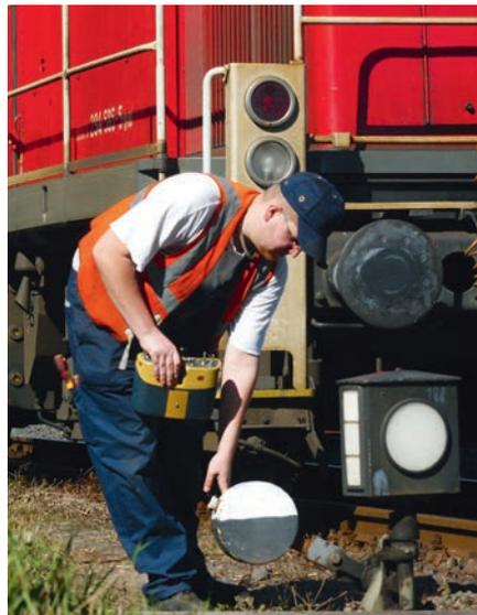
**Januar 1978:** Erste Erprobung der Funkfernsteuerung bei Rangierlokomotiven.
