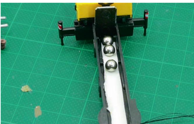
Die Ballastkugeln werden mit Doppelklebeband befestigt.
