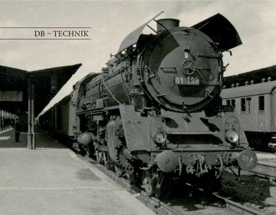
01 199 mit sehr hoch angebrachten kleinen Windleitblechen (Hof, 1946). Foto: Slg. Garn
