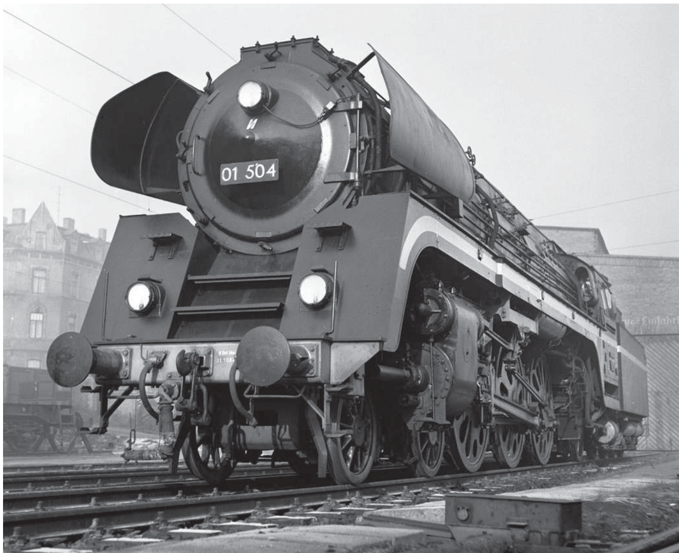
Die 01 504 hat seitliche Laufblechschürzen mit Zierstreifen erhalten. Aufnahme in der VES-M Halle am 7. Dezember 1962. Foto: G. Illner/Slg. Garn
