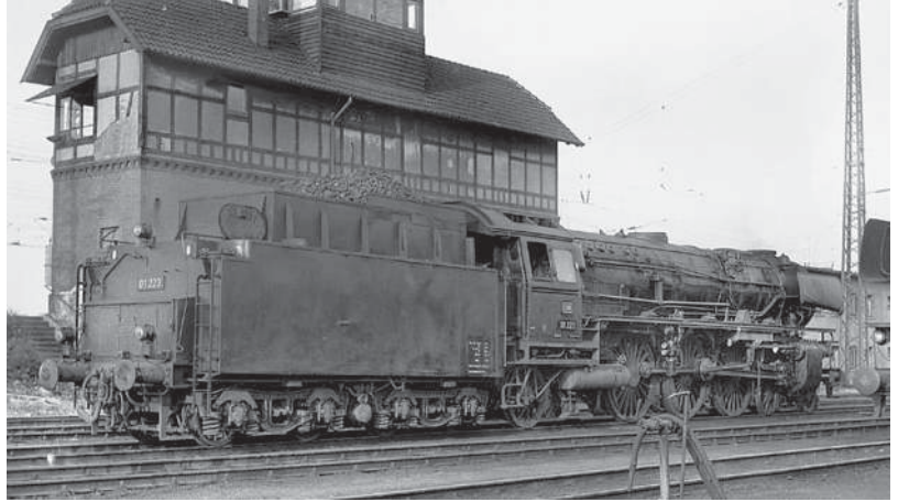
01 223 erhielt 1955 Rollenlagerstangen (23.4.1965). Foto: H. Berkowski/Eisenbahnstiftung
