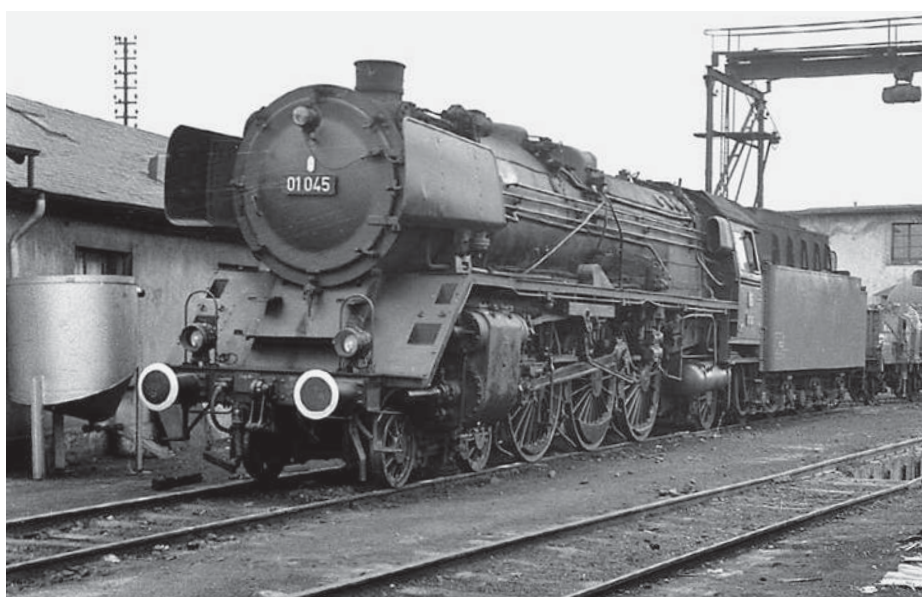
01 045 mit Trittstufen in der Schürze (Luxemburg, 1959). Foto: R. Fell/Eisenbahnstiftung
