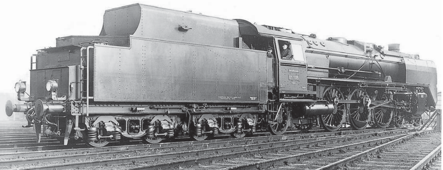
Die im November 1934 abgenommene 01 105 ist gekuppelt mit einem Tender 2'2' T 32 der neueren Ausführung. Foto: W. Hubert/Slg. Gerhard
