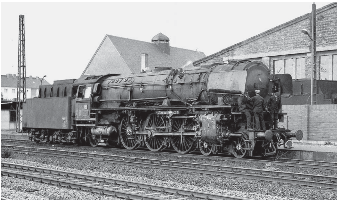
AW Nied: Die exakte Einstellung der Steuerung der 01 216 wird von Arbeitern auf der Pufferbohle per Gehör geprüft (um 1963). Foto: Slg. Jahr
