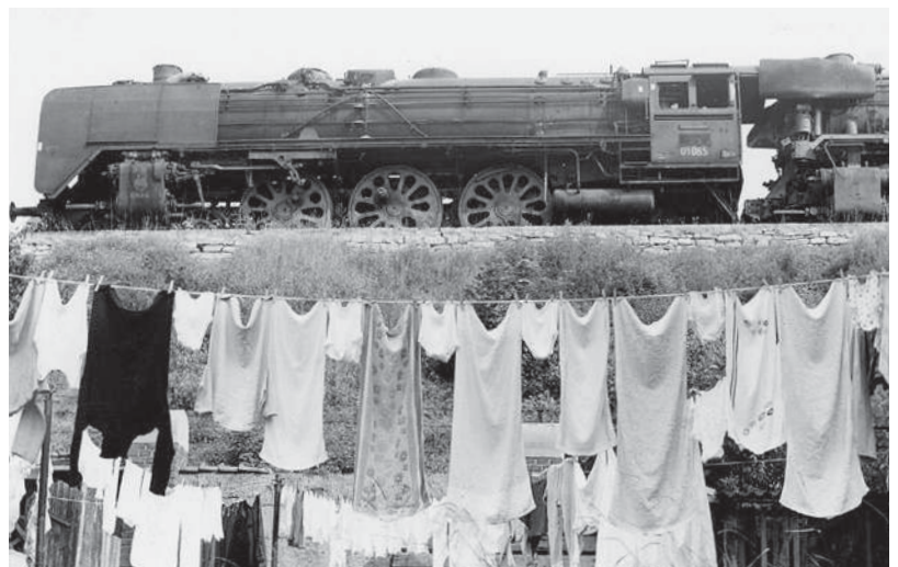
Meiningen 1972: Mit Boxpok-Rädern wartet 01 085 auf die Verschrottung. Foto: Slg. Griebel
