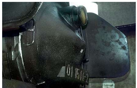
Die kegelige Rauchkammertür der 01 1516. Foto: R. Gam
