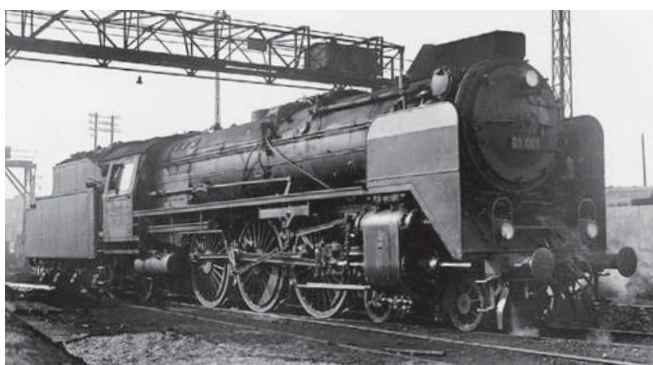
Um 1928 besaß 01 001 testweise zusätzlich zu den mittelgroßen Blechen eine Windleitvorrichtung am Schornstein. Foto: R. Kreutzer/Slg. Griebel
