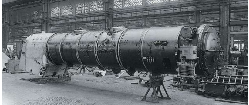
Kessel für die von AEG gelieferten 01 009 und 010 mit einer Rohrlänge von 5,8 m.
