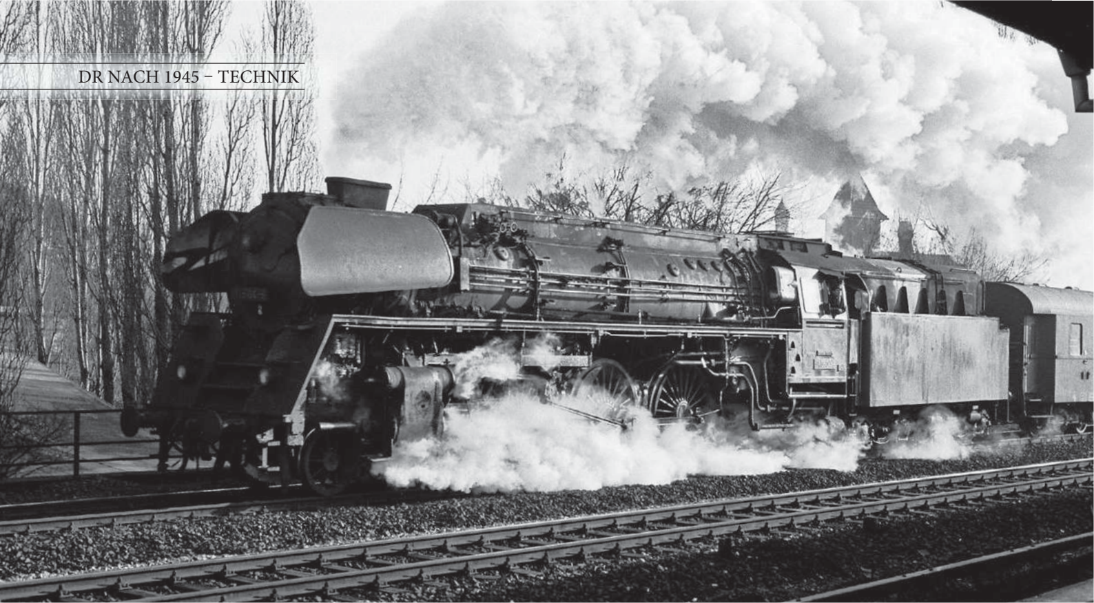
Als einzige 01 5 besaß die 01 504 einen Giesl-Ejektor, erkennbar am Flachschorstein (4. Februar 1971). Foto: L. Hornung/Archiv Steinwasser
