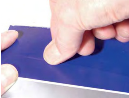
Schablone selbst machen: Hat man kein Kohlepapier, kann man die Kontur auch kräftig durchdrücken.
