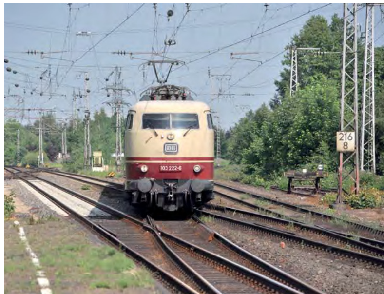
Eine weitere EW-1200, diesmal eine 1:12, wird gerade von 103 222 mit 100 km/h befahren. Die Aufnahme mit der größten Reichsbahnweiche entstand am 3.6.2014 in Salzbergen. Foto: Armin Mühl
