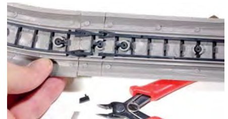
Von unten muss man den Trägerrost kürzen.
