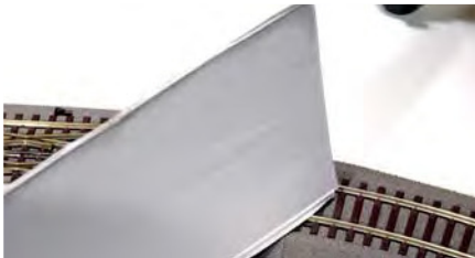
Entlang des Abdrucks wird nun ausgeschnitten.
