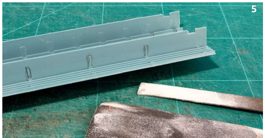
Bild 4: Mit Messer und Feile wird die Schnittkante versäubert. Ein Winkel hilft beim Überprüfen des rechten Winkels.
