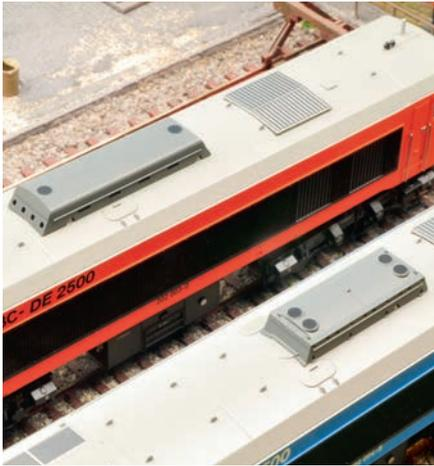
Die Schalldämpferaufsätze sind unterschiedlich.
