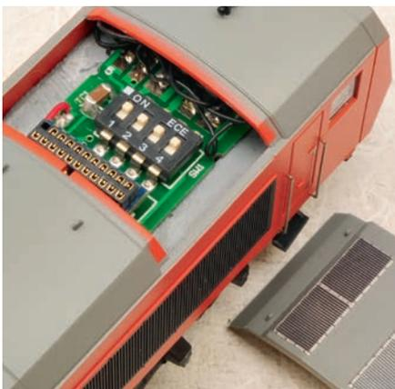
Der Dachaufsatz mit den aufgedruckten Gittern der Bremswiderstände ist abnehmbar. Darunter liegt der Dip-Schalter für die Beleuchtung.
