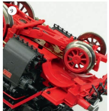
gekürzten Federzungen sind leicht nach außen zu biegen und um etwa zehn Grad zu knicken (Bild 6). Damit sind die Schleifer einbaufertig.
