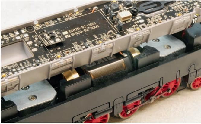
Das Lokinnere: mittig der Motor, links und rechts davon die Getriebe.
