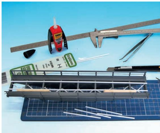
Innen: Bis der Kleber abgebinden hat, erhöhen zusätzliche Gewichte den Anpressdruck.
