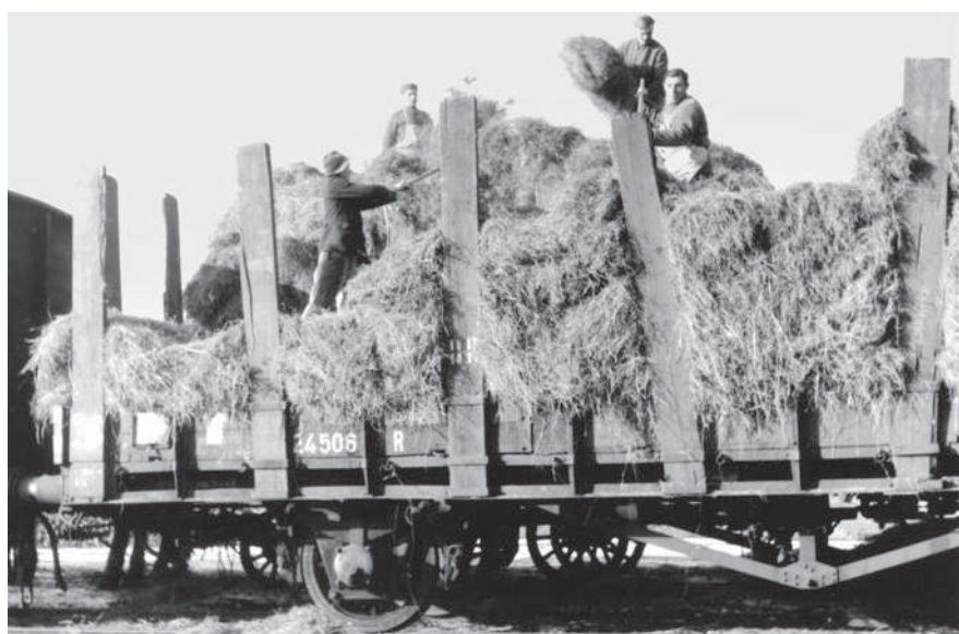
Strohbindel werden in einen R Stuttgart geschichtet. Der Zustand der Rungen dürfte der Kriegszeit (1942) geschuldet sein. Deutlich zu erkennen ist im Vergleich mit dem Foto links oben der Unterschied in der Struktur von Stroh und Heu. FOTO: RVM, SAMMLUNG CHRISTIAN GERECHT
