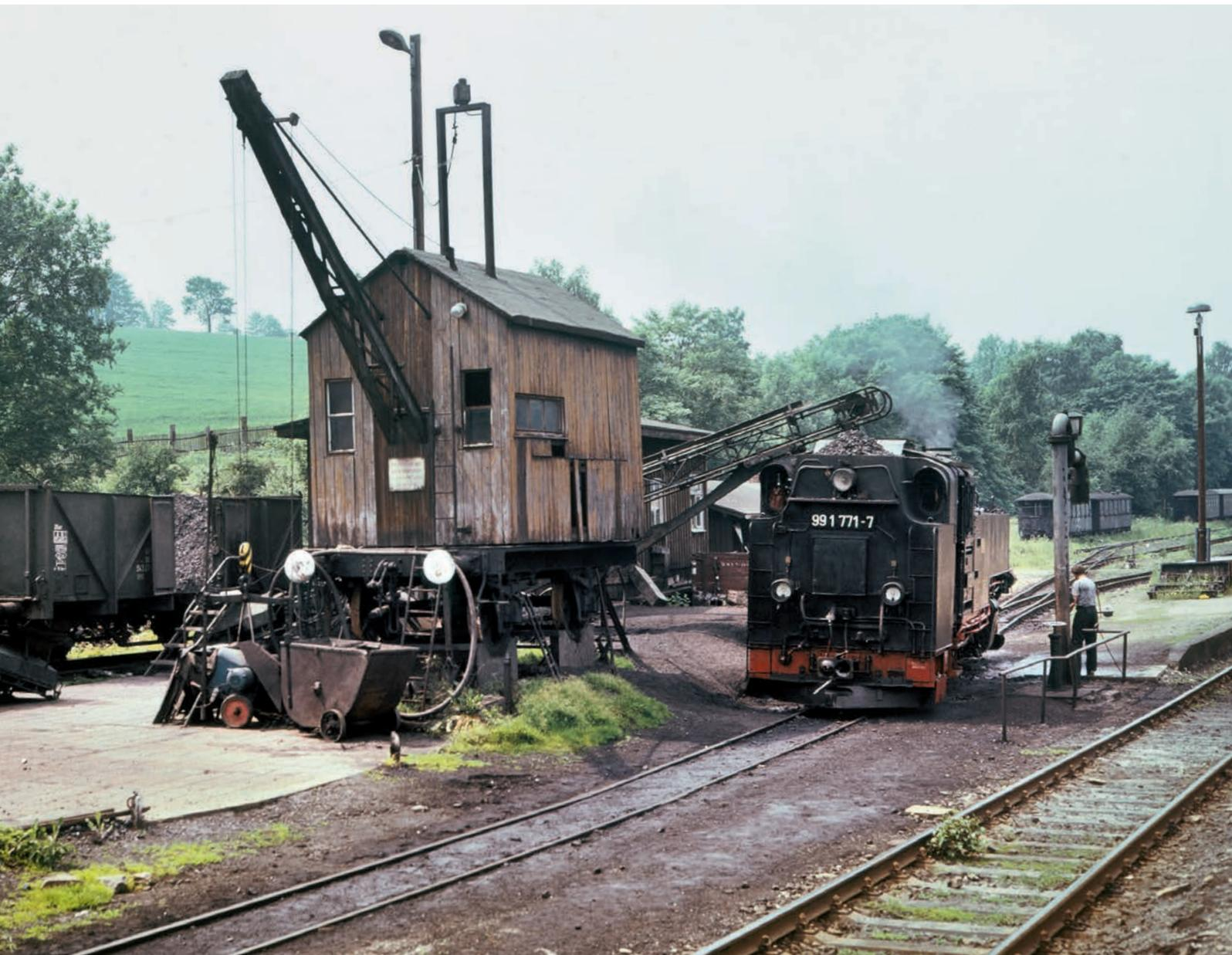
Weil die Schmalspurloks der 750-mm-Strecke Crazahl–Oberwiesenthal keinen üppigen Kohlevorrat mitführten, mussten sie am Ausgangspunkt der Strecke regelmäßig bekohlt werden. Um Schwerstarbeit mit Schippen und Körben zu vermeiden, diente ein auf Betonblöcke gesetzter regelspuriger Kranwagen als Kohlekrane. Diese wohl einmalige, doch hilfreiche Lösung hielt Rainer Heinrich im Juni 1983 in einem Foto fest, das heute längst historischen Wert besitzt.
