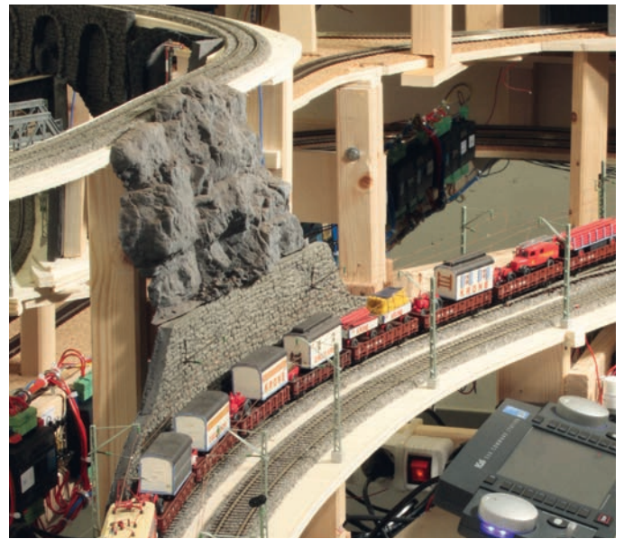
Uncool: Felswand statt Hang an der zu schmal geratenen Anlagenstelle.
