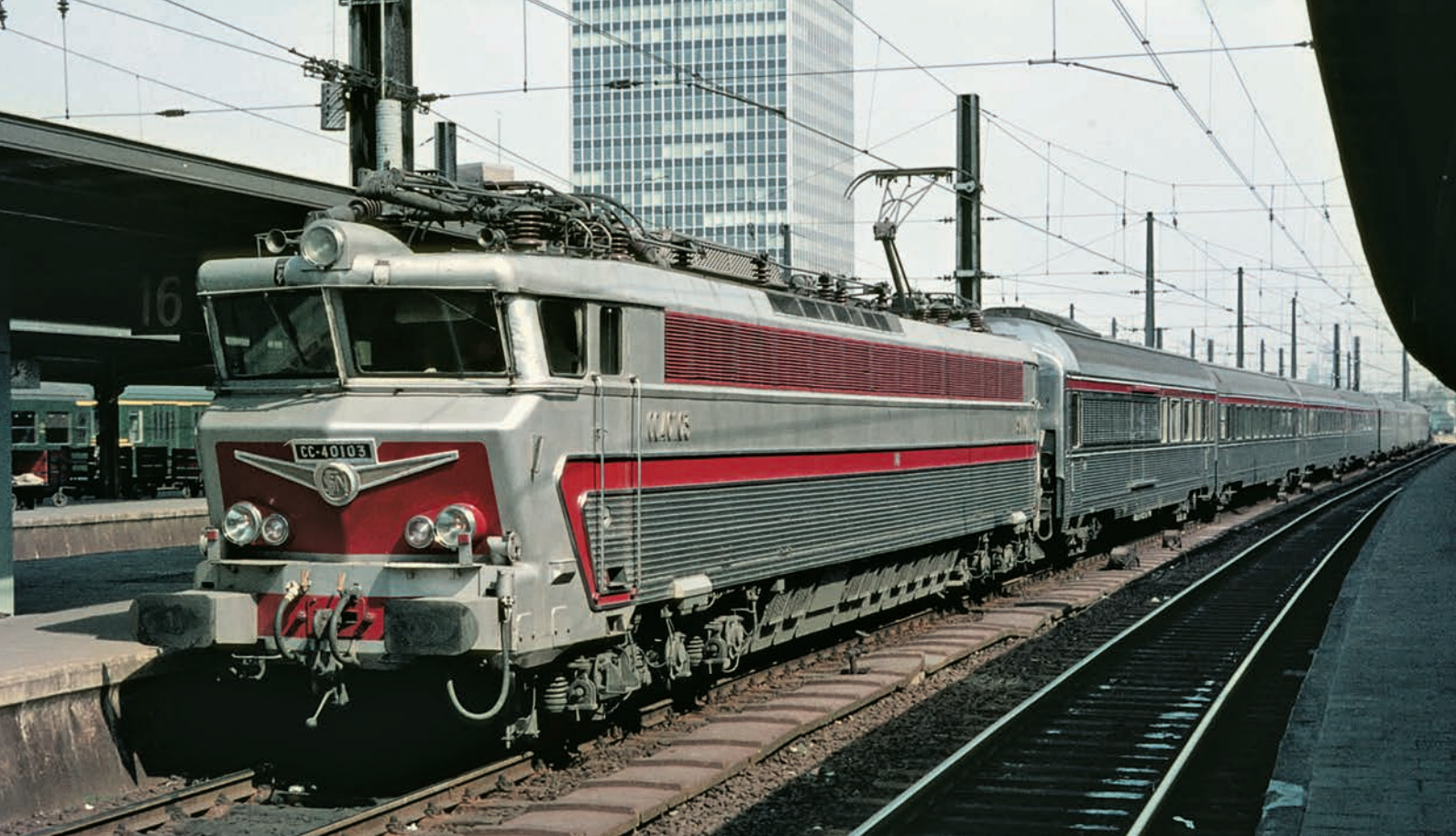
Seit 1964 kamen die neuen SNCF-Viersystemloks der Baureihe CC 40100 vor TEE-Zügen zum Einsatz. Hier die CC 40103 mit TEE „Ile de France“ in Brüssel (1969). FOTO: MAX DELIE
