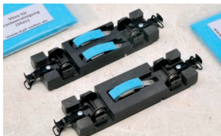
Kleine mit Doppelklebeband befestigte Streifen Aldi-Putzvlies bilden das Reinigungsvlies.
