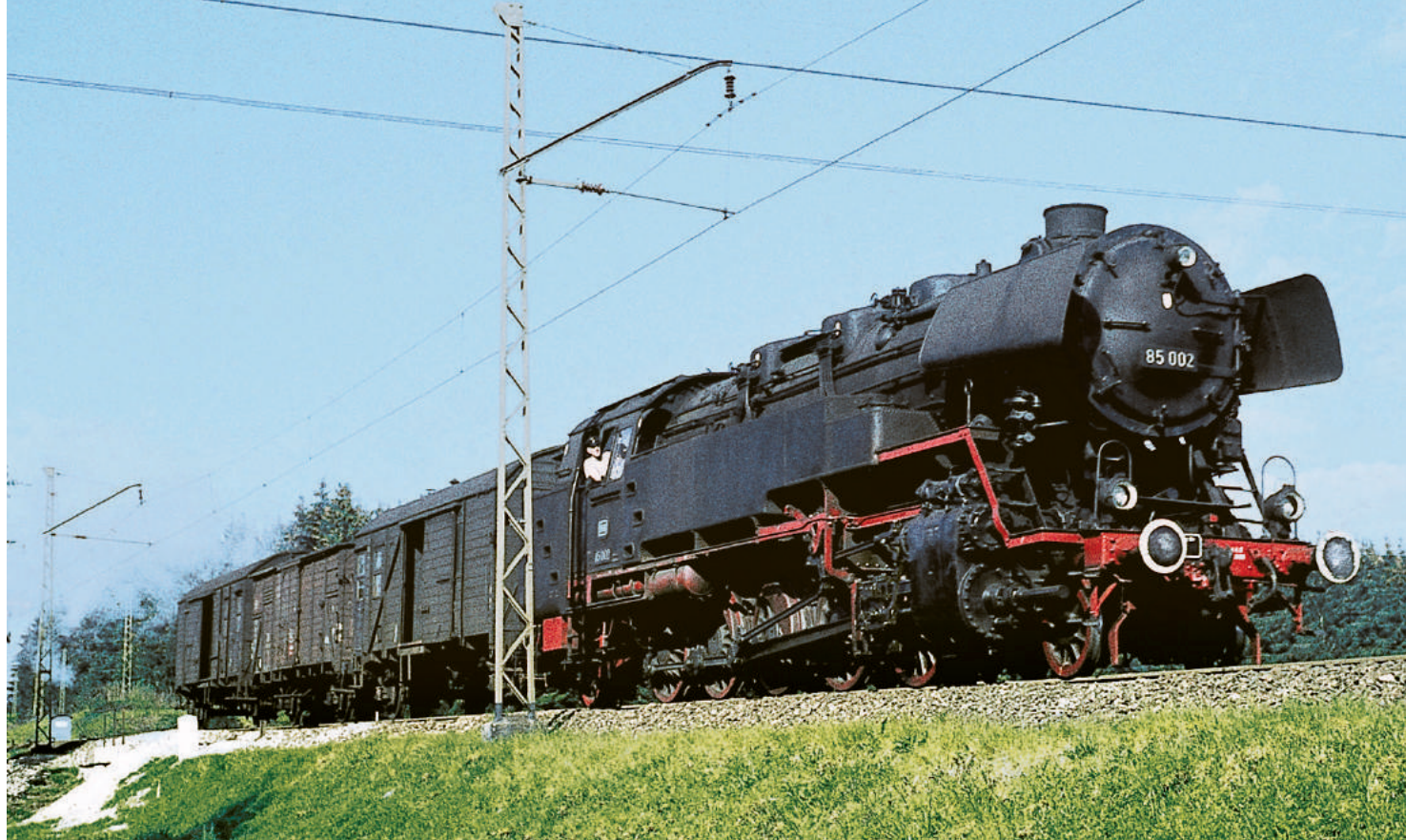
An einem sonnigen Maimorgen des Jahres 1959 rangiert die 85 002 im Bahnhofsbereich von Titisee. In den 50er Jahren erhielten die 85er Windleitbleche der Bauart Witte. FOTO: DR. ROLF BRÜNING
