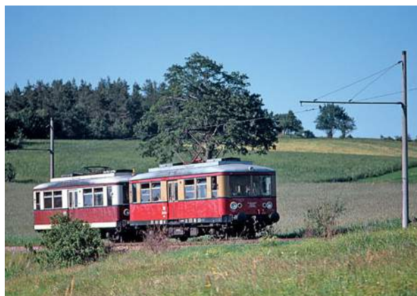
Auch die Oberweißbacher Bergbahn ist mit 600 V Gleichstrom elektrifiziert (279 203 und 279 205; Juli 1991). Foto: M. Werning
