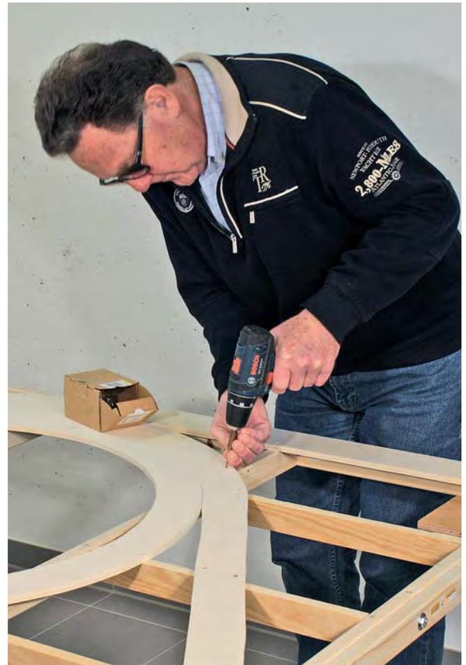
*Die Gleise liegen bereit und werden nach Plan auf den Holzplatten für die Trassen ausgelegt. Für das Ausschneiden der Trassen ist die Realität maßgebend, nicht die Planung. Daher werden die Schnittlinien vom ausgelegten Gleis abgenommen.*
