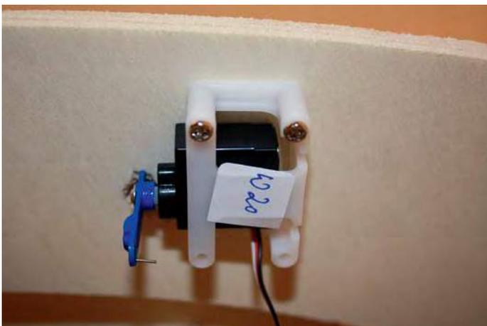
Zum Antrieb der Weichen dienen handelsübliche Servos. Die ESU-Einbausätze aus Halterungen und Federstahldraht für die Bewegung machen die Anwendung einfach. Mit wenigen Schrauben ist der Einbau schnell erledigt.
