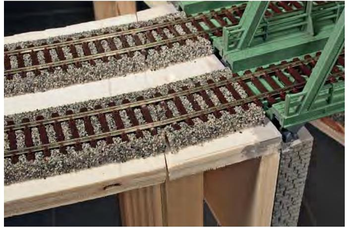
Ein Vorteil der Bettung ist, dass sie die Gleise etwas abfedert. So sind diese weich gelagert, was sich z.B. positiv auf das Fahrgeräusch auswirkt.
