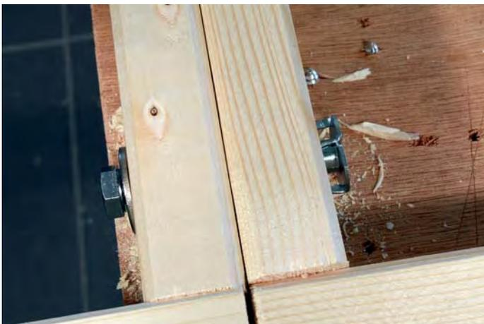
*Stück für Stück werden die Schrauben in die Einschlagmuttern gedreht. Diese ziehen sich dabei selbst ins Holz und „verkrampen“ sich mit dem Kranz aus Metallspitzen.*
