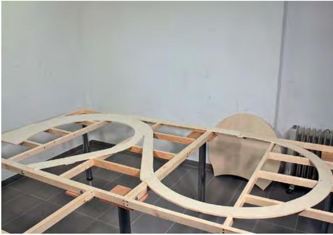
Auf die jetzt befestigten Trassen werden die Gleise erneut ausgelegt. Wo es sich wie hier bei der großen rechten Kehrschleife anbietet, wird Flexgleis an Stelle fester Gleisstücke eingesetzt. die Gleise werden über die Rahmen-grenzen hinweg verlegt.
