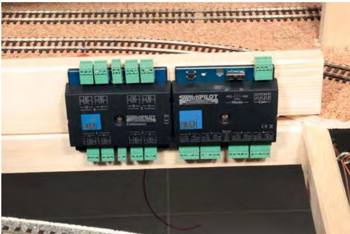
Für das Schalten von Weichen und Signalen sind Decoder vom Typ SwitchPilot zuständig. Diese Bausteine gibt es in zwei Varianten: für normale Magnetspulen-antriebe und für Servoantriebe. Zusätzlich kann man die Decoder um Relais-Schaltstufen erweitern.
