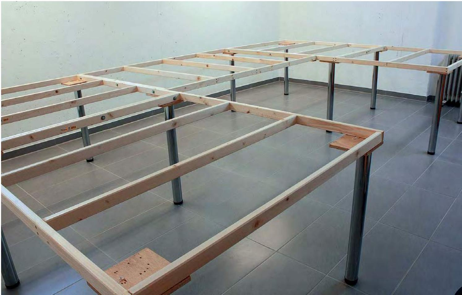
Die folgenden Schritte wiederholte ich dann für alle Schrauben einer Rahmen-seite parallel, sodass die Rahmen gleichmäßig zueinander gezogen wurden. Mit einem Schraubenschlüssel zog ich die Schlossschrauben verschachtelt fest. (Nach DIN passt für eine M8-Schraube eine Schlüsselweite von 13 mm). Dies wiederholte ich so lange, bis zuerst die Kramen und dann auch die ganzen Einschlagmuttern tief in das Holz hineingezogen worden waren.
