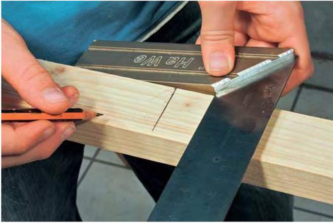
Die späteren Sägesschnitte werden genau angezeichnet. Nach dem Sägen werden passende Löcher vorgebohrt und die Leisten an den Enden miteinander verschraubt.
