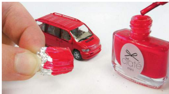
Nach dem Abformen erfolgt eine Lackierung im Grundfarbton des Unfallfahrzeugs. Ein Pinsel tut es hier auch.
