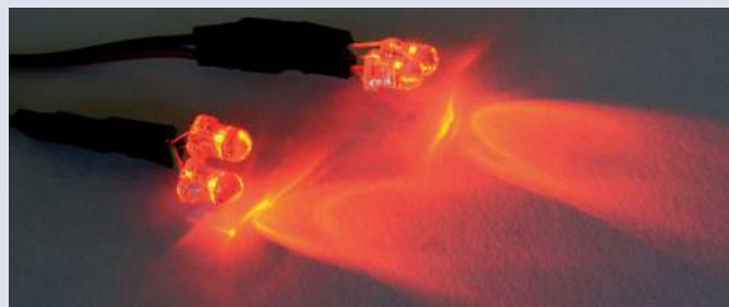
Ein flackerndes Feuer kann auch mit sogenannten „Flacker-LEDs“ erzeugt werden. Eine externe Steuerelektronik kann dabei entfallen.
