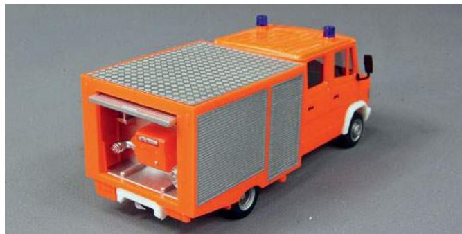
TSF-W auf Basis des MB Vario als Herpa-Modell. Zusätzlich zum klassischen TSF ist hier ein kleiner Wassertank mit an Bord.
