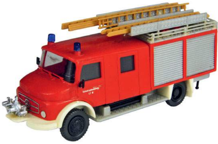
Ein Löschgruppenfahrzeug LF 16 TS auf Basis des MB LAF 1113 als Preiser-Modell (31280). Der Aufbau stammt von Lentner. Auch im Modell vorhanden: Die extra starke Vorbaupumpe mit 3 B-Abgängen
