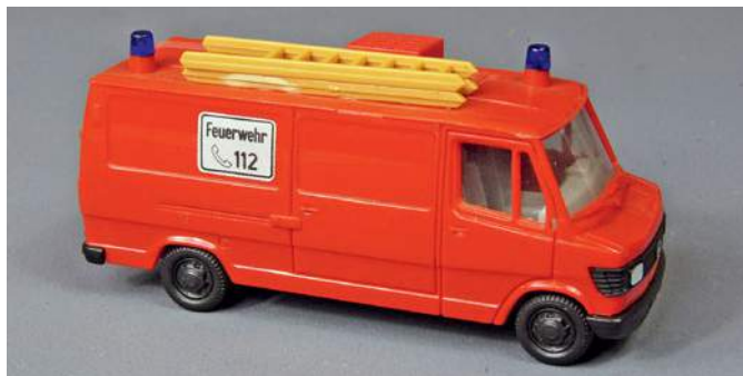
Der Mercedes Sprinter 207D als Tragkraftspritzenfahrzeug. Die eingeschobene Tragkraftspritze (TS) lieferte 800 Liter Wasser in der Minute.
