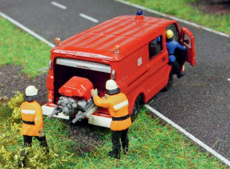
Tragkraftspritzenfahrzeuge besitzen statt eines Wassertanks eine eingeschobene Feuerlöschkreiselpumpe, auch Tragkraftspritze (TS) genannt.
