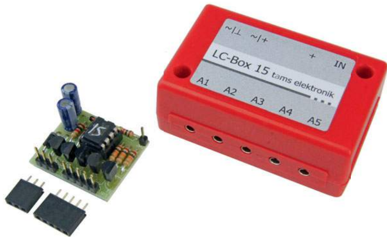
Realistische Blaulichteffekte lassen sich mit den Steuermodulen LC-15 bzw. der LC-15 Box von Tams erzeugen.
