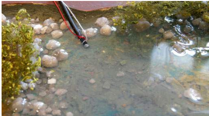
Abhängige Löschwasserversorgung: Die A-Saugleitung liegt mit der Ventilleine und der Halteleine realistisch unter der Wasseroberfläche.
