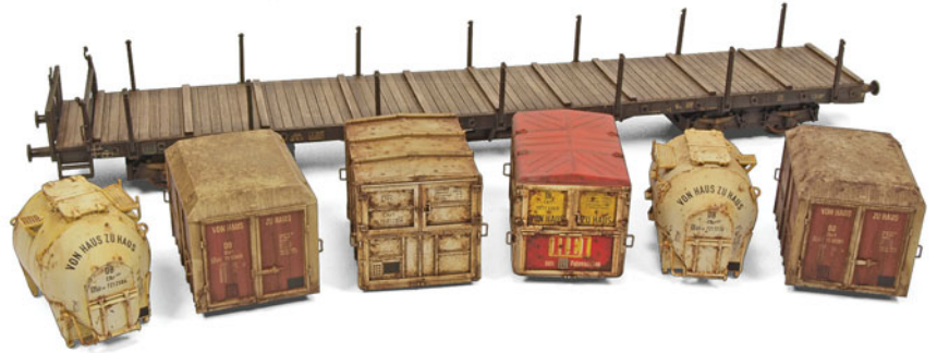
Die sechs Wechselbehälter und der Waggon (ein SSIm 25 von Liliput) nach der farblichen Gestaltung. Für die Ladefläche kam ein Set für Holz von Lifecolor zum Einsatz. Die Drehgestelle wurden mit Pigmentfarben behandelt.
