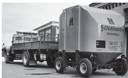
Silocontainer (11 m³) für Braumalz von 1958. FOTO: FELDSCHLÖSSCHEN GETRÄNKE AG
