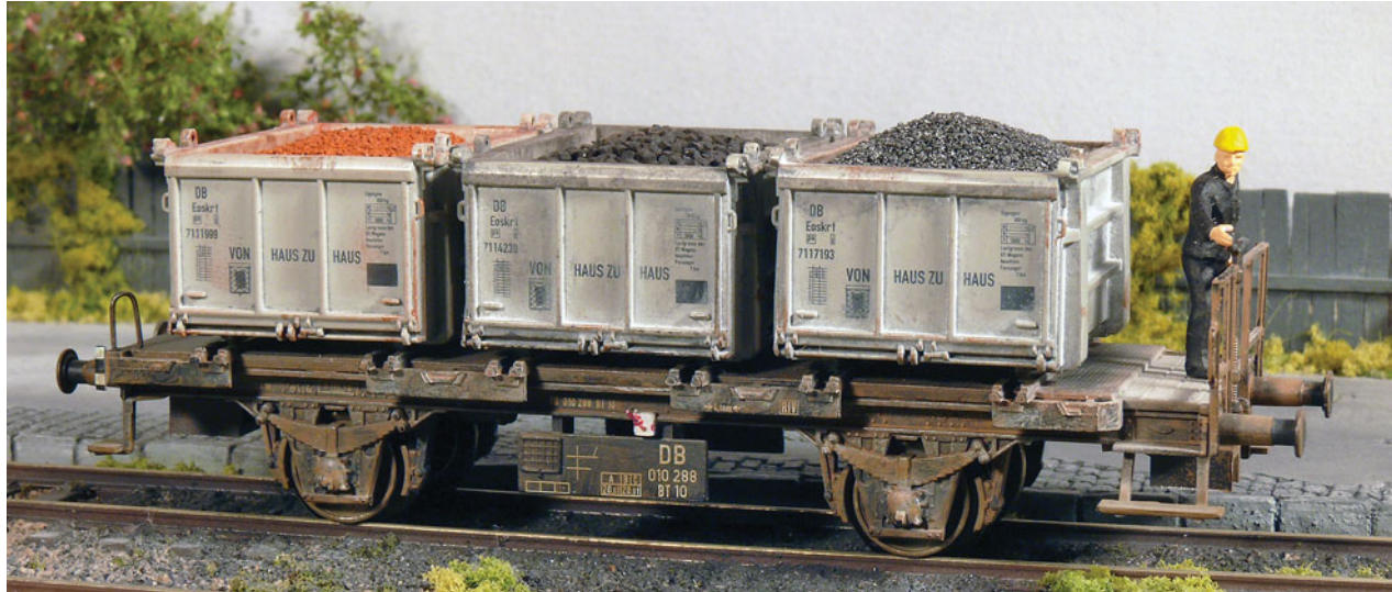
Am beladenen Waggon kann man die charakteristischen Formen der Schüttkegel gut erkennen: praktisch flach beim Ziegelbruch, leicht gewölbt bei den Briketts und deutlich spitzkegelig bei Anthrazit.
