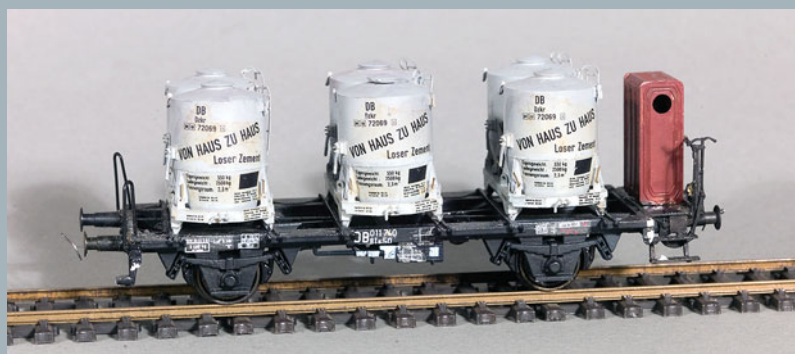
Neben der Übergangsbühne erhielt dieser Wagen ein zusätzliches Bremsenhaus in Wellblech-Ausführung.
