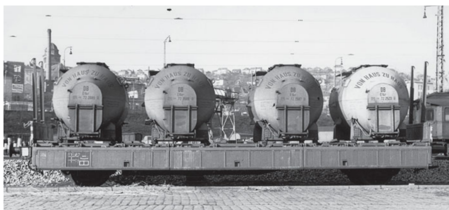
Die Waggon vom Typ Btms 33 entstanden aus Wagen der Gattung Rmms 31. Foto: F. WILKE/SLG. CARSTENS
