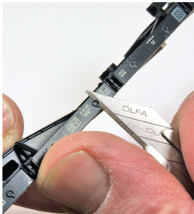
Um die Behälter vorschriftsgemäß befestigen zu können, werden die am Wagen angespritzten Zurrösen abgekratzt.
