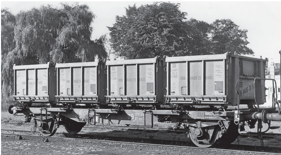
Die vier Stände des BTms 55 sind mit Eoskrt 021-Behältern beladen. Sie waren mit rund 6200 Einheiten die häufigste offene Behältertype. FOTO: W. HOLLNAGEL/SLG. CARSTENS
