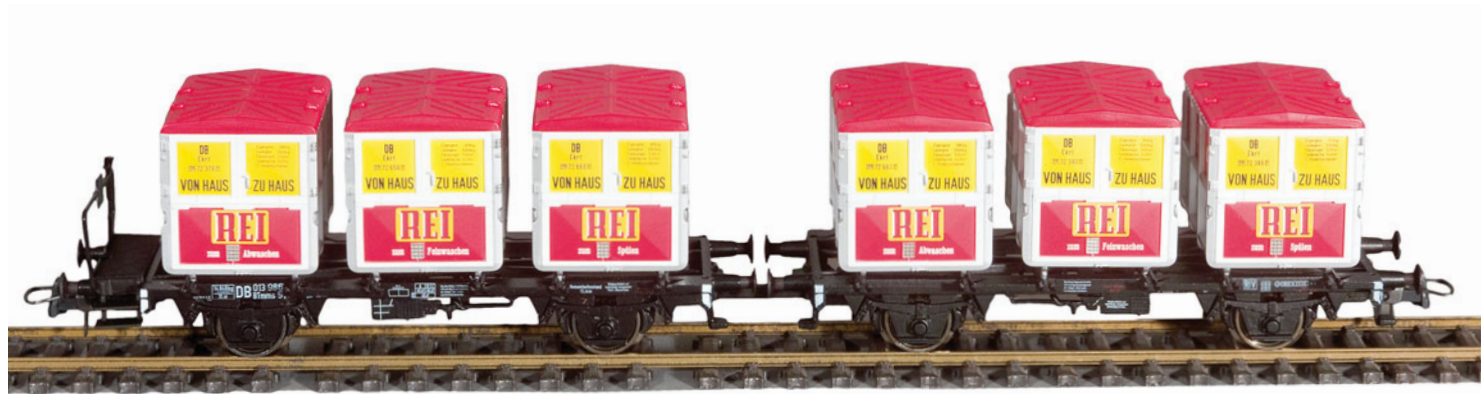
Ein Roco-Modell des BTmms 51 aus einer späteren Serie mit Etkr-Behältern. Der Vorbildbeschreibung von 1967 entsprechend verfügt einer der Wagen über einen Bremsenstand.
