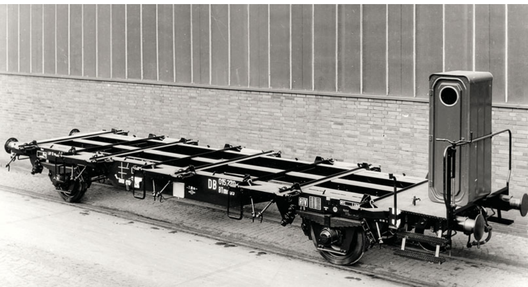
In den Jahren 1955 bis 1958 baute SEAG als Weiterentwicklung der BTs 50 insgesamt 2438 vierständige BTms 55. FOTO: WERKFOTO SEAG/ SLG. WESTERMANN
