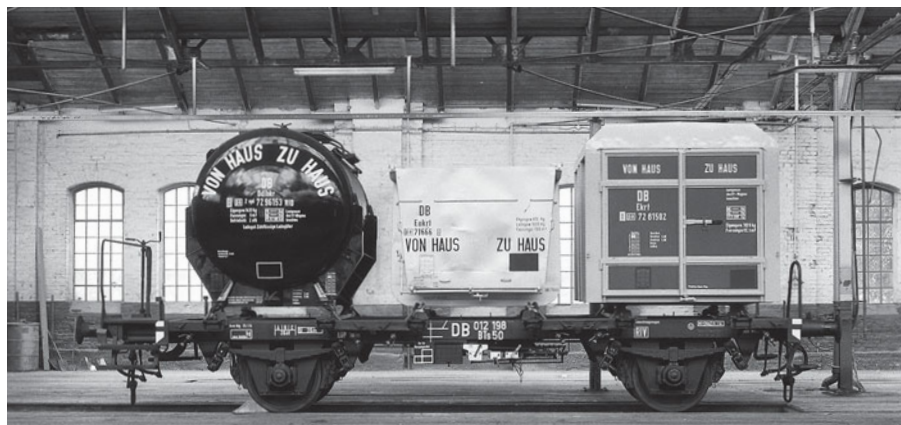
Rechts: BTs50 mit einem Ddihkr für zähflüssige Güter (links), einem Eokrt (Mitte) und einem Ekr. FOTO: P. DRIESCH
