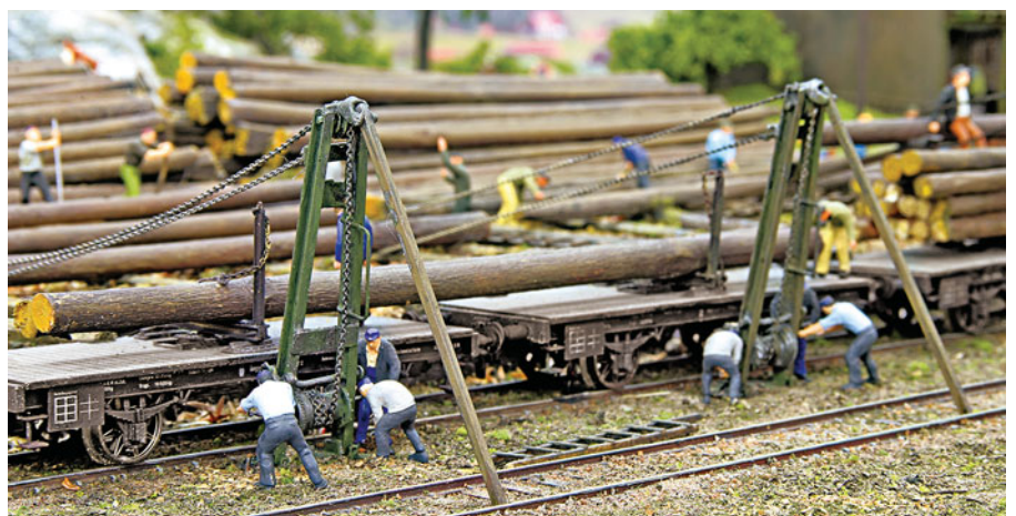
Mit gemeinsamer Muskelkraft mussten die Arbeiter die Spindeln aufkurbeln und so den mit Ketten eingespannten Stamm zentimeterweise Richtung Drehschemel bewegen.
