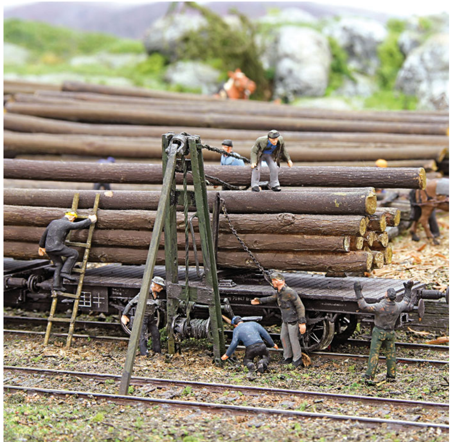
Über gesonderte Ladebäume und Spindeln wurden die Stämme per Muskelkraft und über schräggelagerte Stämme — als Rutschen — auf die Drehschemel der Langholzswagen gezogen.
