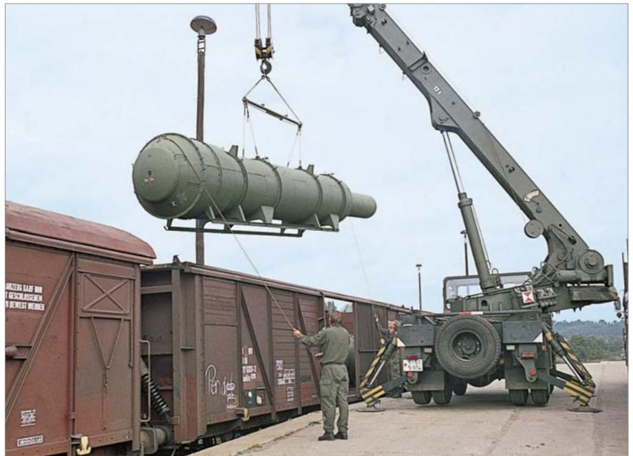
Verladung eines Raketenbehälters von einer Seitenrampe aus mit Hilfe eines Autokrans vom Typ ADK 125/3 in einen Tbekks-Wagen im Bahnhof Krossen im September 1992. FOTO: HARALD GRAFE
