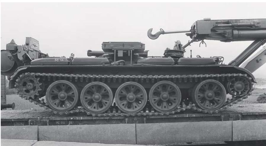
■ Standardverladeklötze A zwischen den Laufrollen des Vollkettenfahrwerks eines Brückenlegers BLG 60M. Diese Befestigungsart konnte nur mit sehr stark gelockerter Kette erfolgen und war aus diesem Grunde kaum gebräuchlich.
