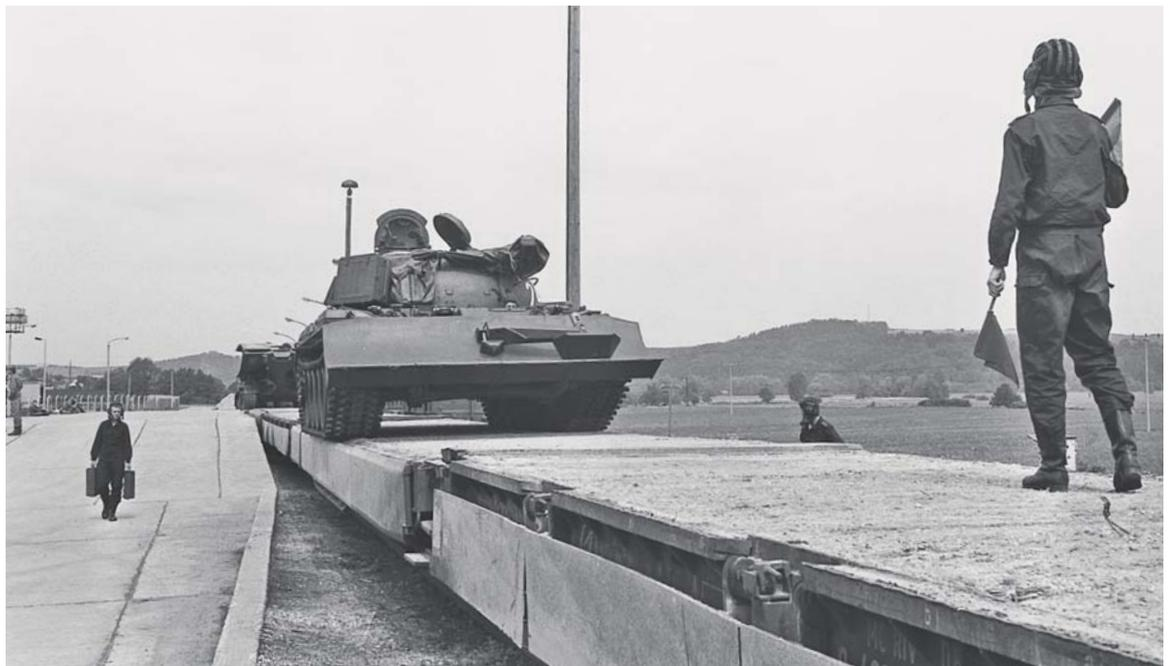
das Fahrzeug dann zurück in die UMK, dabei mussten sich die Befestigungsdorne der UMK vollständig in den Wagenboden drücken. Dies wurde auch durch den Wagenmeister mittels heftigem Rütteln am Keil geprüft, denn oft waren die Wagenböden durch das Befahren mit Kettenfahrzeugen und das Eindrücken der UMK-Dorne stark zerfasert und die Dorne fanden keinen richtigen Halt mehr.
