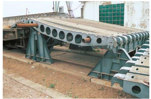
■ Beschädigte ZLR 60/1 nach Abziehen eines bei Beschussversuchen 1994 in Meppen zerstörten T72. FOTO: HARALD GRAFE
