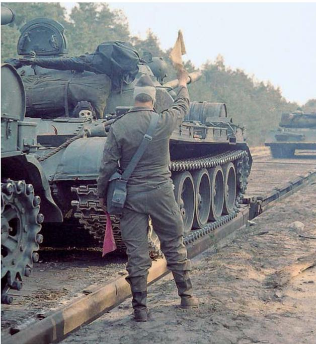
■ Auffahren eines Panzers T55 auf einen Samm-Wagen unter erschwerten Bedingungen. Die Funkantenne wurde bereits demontiert, das Fla-MG ist verpackt am Turm befestigt. Panzerfahrer und Einweiser tragen Schutzmasken FOTO: MILITÄRHISTORISCHES MUSEUM DER BUNDESWEHR/GEBAUER
