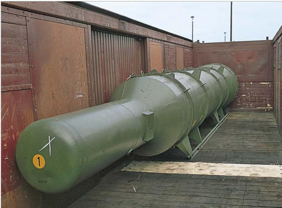
■ Transportbehälter mit Rakete noch unbefestigt in einem Tbekss-Wagen. Vor 1989 wurden für solche Transporte Ea-Wagen genutzt und die Raketen mit Planen abgedeckt. FOTO: HARALD GRAFE
