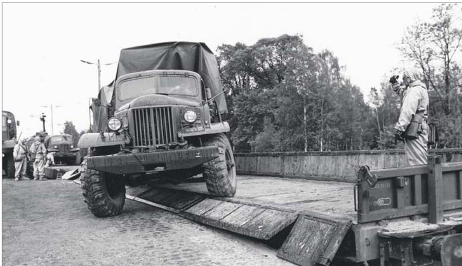
■ Entladung einer Fla-Raketeneinheit im Juni 1978 unter den angenommenen Bedingungen eines Kernwaffeneinsatzes: SIL 157 mit Sattelaufleger fährt von einem Samm über die umgelegten Seitenbordwände (mit Holzfüllung) auf die Seitenrampe. FOTO: MILITÄRHISTORISCHES MUSEUM DER BUNDESWEHR/GEBAUER
