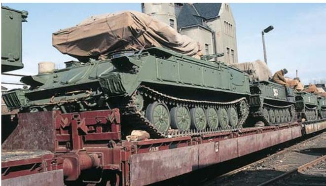
■ Samms-Wagen mit Fla-Raketenstartrampe 2P25M1 im März 1992 in Weimar. Deutlich zu erkennen sind die zusätzlichen Konsolen über den abgeklappten Seitenwänden. FOTO: HARALD GRAFE
