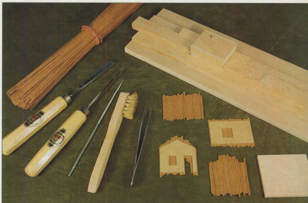
Bild 48 (rechts): Das benötigte Werkzeug samt Baumaterial. Die vier Wände des Holzschuppens sind bereits mit Furnierstreifen verleimt. Die ausgeschnittenen Sperrholzplatten mit den Fenstern und der Türöffnung sind vorbereitet.
