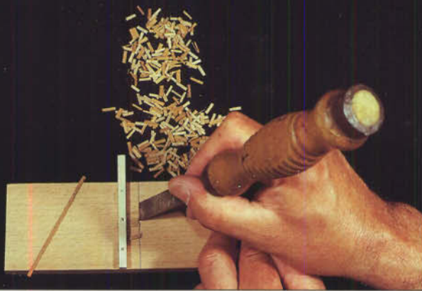
Bild 42: Das Ablängen der Schindeln geschieht auf der selbstgebauten Lehre mit einem scharfen Stecheisen.
