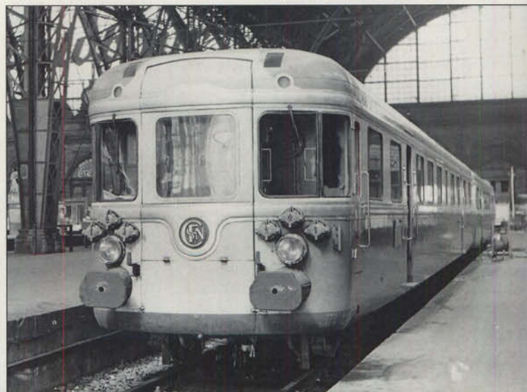
Bild 6: Die SNCF-Dieseltriebzüge vom Typ RGP 1 (Normalausführung) gelangten als FT 1101/1124 von 1956 bis 1961 bis nach Frankfurt (Main). Hier die Führerstandsseite des Steuerwagens (wie bei der TEE-Version mit Übergangsmöglichkeit). FT 1124 nach Metz steht am 6. April 1958 in Frankfurt Hbf zur Abfahrt bereit. Foto: DB (Trost), Sammlung Ernst
