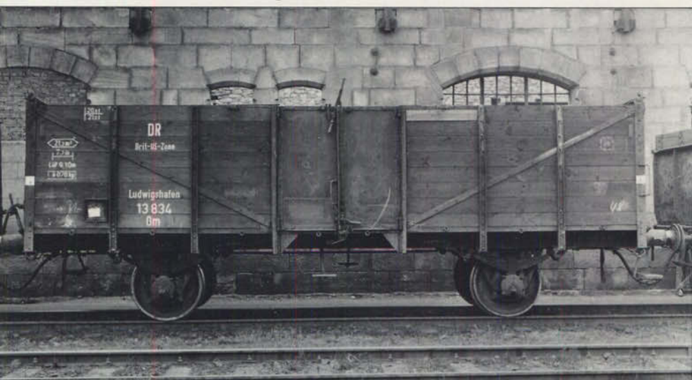
Bild 2: Die Om-Wagen der Länderbahn-Bauarten waren bei der Deutschen Reichsbahn im Gattungsbezirk Ludwigshafen zusammengefaßt. Hier ist ein Wagen nach Musterzeichnung Ild-2 der Preußischen Staatseisenbahnen abgebildet, der nachträglich mit außenliegenden Zugbändern ausgerüstet worden ist. Diese Bauart war Grundlage für die offenen Verbandsgüterwagen nach Musterzeichnung A 10. Foto: R. Klitscher, Sammlung Heidt
