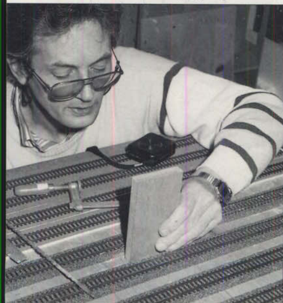
Bild 19: Ein Sperrholzbrettchen wurde auf das genaue Maß zugeschnitten und wird nun eingepaßt. Anschließend geht's mit Uhu-coll an das Verleimen in der Anlagengrundplatte.
