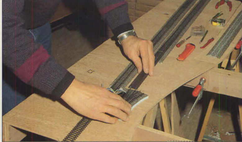
Bild 5: Die Merkur-Gleisbettung für die Weiche des abzweigenden Gleises wird an der Markierung aufgelegt und mit Uhu-coll verklebt.
