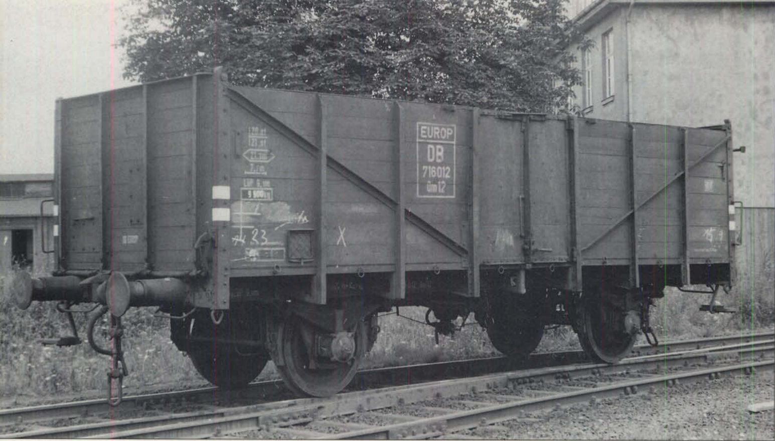
Bild 6: Der Om 12 mit der Nummer 716012 der Deutschen Bundesbahn gehörte Mitte der fünfziger Jahre dem EUROP-Park an. Gut zu erkennen sind hier die neuen Zugbänder aus Winkelprofilen, die an den Eckrungen bzw. an Knotenblechen angeschweißt sind. Weitere Bauartänderungen betreffen die Hülsenpuffer und die Druckluftbremse. Foto: Bundesbahn-Filmstelle Minden (Bustorff), Sammlung Diener
