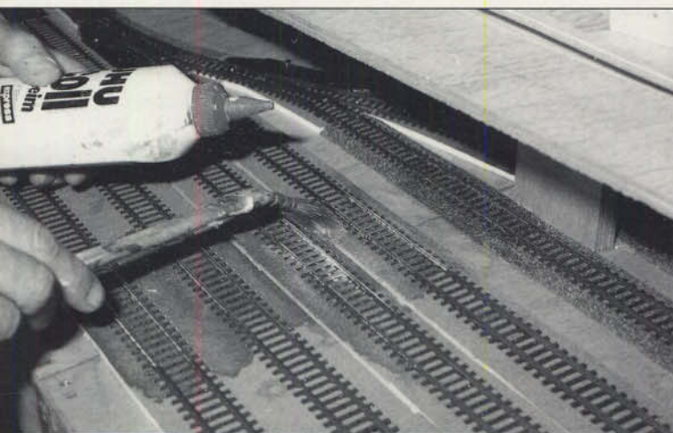
Bild 6: Vor dem Trennen der Gleise an den Stoßstellen der teilbaren Anlage werden diese mit verdünntem Uhu-coll satt eingestrichen. Nach dem Aushärten des Klebers können die so in der Merkur-Bettung fest verankerten Gleise getrennt werden.
