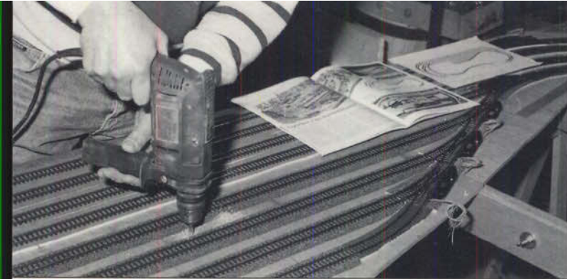
Bild 15: Das Einsetzen der Stützen für das herausnehmbare obere Deck mit dem künftigen AW geschieht in folgenden Schritten: Zuerst werden im Bereich der Stützen mit einer Bohrmaschine und einem 8-mm Bohrer Löcher für das Arbeiten mit der Stichsäge gebohrt. Anschließend kann ...
