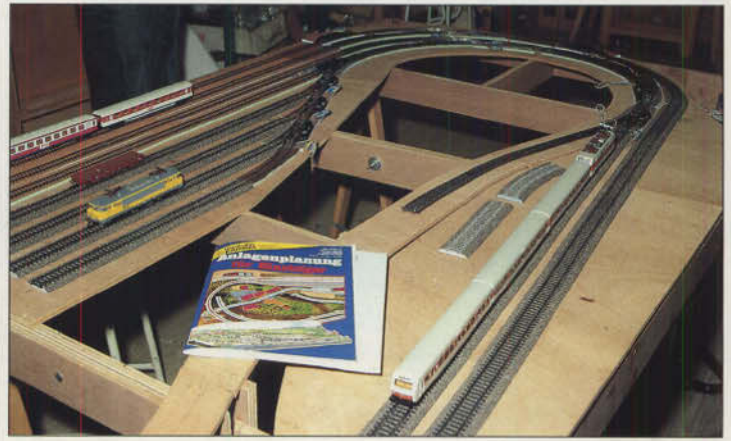
Bild 9 (oben): Die offene Rahmenbauweise erlaubt auch nach der Fertigstellung einen Zugriff von unten zu den verdeckten Streckenteilen. Auf unserer Anlage werden nach einem provisorischen Kabelanschluß die ersten Versuchsfahrten durchgeführt, um eventuelle Fehler bei der Gleisverlegung rechtzeitig vor dem Weiterbau zu erkennen.
