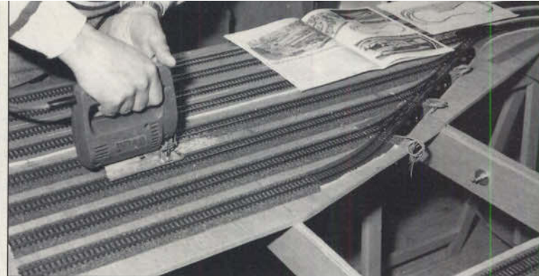
Bild 16: ... mit derselben das mit einem Filzstift markierte Rechteck in den Maßen der vorgesehenen Sperrholzstütze ausgesägt werden. Das Sägen sollte von unten erfolgen; die hier angewandte Arbeitsweise dient lediglich der besseren Demonstration dieses Arbeitsschritts.
