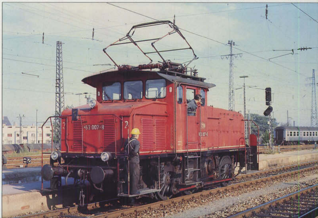
Bild 16: Anlässlich der Grundüberholung 1960/61 sind u.a. folgende Änderungen vorgenommen worden: Die Führerhäuser erhielten ein drittes Fenster in den Frontseiten sowie Seitenfenster neben den Einstiegen. Für das Rangierpersonal wurden über den Pufferträgern Bühnen bzw. Übergänge angebaut. Foto: H. Obermayer
