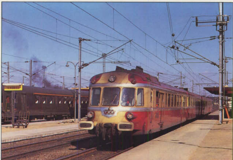
Die TEE-Dieseltriebzüge der SNCF (Seite 62): Für den TEE-Einsatz stellten die SNCF Mitte der fünfziger Jahre zweiteilige Dieseltriebzüge in Dienst, die von 1957 bis 1965 u.a. als TEE "Parsifal" bzw. "Paris-Ruhr" zwischen Paris und Dortmund zum Einsatz kamen. (Aufnahme: TEE 168 "Ruhr-Paris" in Tergnier) Foto: G. Laforgerie
