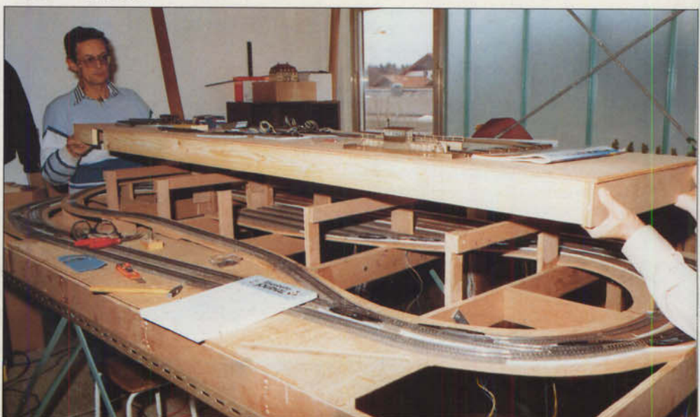
Bild 20: Das inzwischen vorgefertigte Oberteil für die Gleisanlagen des künftigen Ausbesserungswerks wurde probenhalber schon einmal auf das vorbereitete Stützgerüst aufgesetzt. Wir sind zufrieden; alles paßt zu voller Zufriedenheit, und der Weiterbau nach "oben" kann beginnen.
