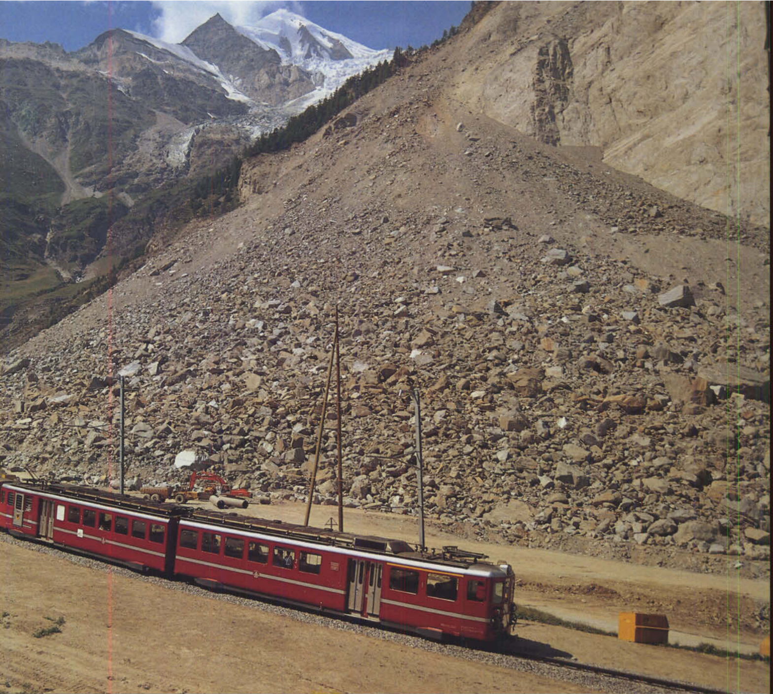
Bild 4: Vom selben Standpunkt aus aufgenommen wie Bild 6, zeigt sich im Vergleich deutlich die große Leistung der Bahnbauer. Der neue Zahnstangenabschnitt hat eine Steigung von 120 ‰.
