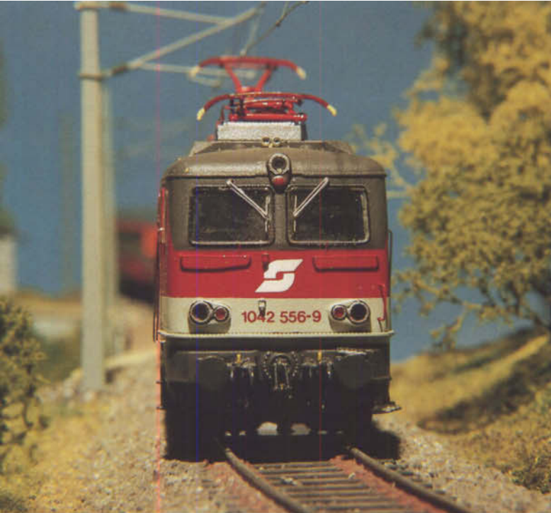
Bild 1: Das Ergebnis der Umbauarbeiten an der neuen 1042 der ÖBB, die aus einem Lima-Modell entstand, kann sich sehen lassen. Beachtenswert sind die zierlichen, aus Messingdraht und Litze selbstgebaute Scheibenwischerattrappen.
