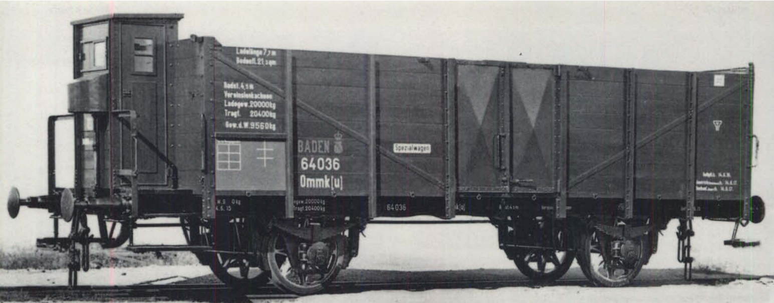
Bild 1: Der Ommk[u] Baden 64036 wurde am 14. Juni 1915 abgenommen und ist hier im Ablieferungszustand zu sehen. Er verfügt über eine Handbremse und – im Gegensatz zur Wagenbeschreibung – über Speichenräder. Werkfoto Waggonfabrik Rastatt, Sammlung Diener
