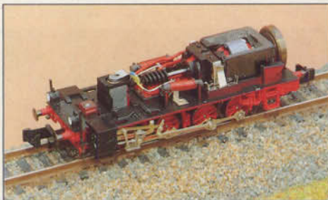
Bild 18: Fahrwerk der 98 811 von Fleischmann in der Baugröße N. Die freie Motorwelle trägt eine kleine, dennoch aber wirksame Schwungscheibe.
