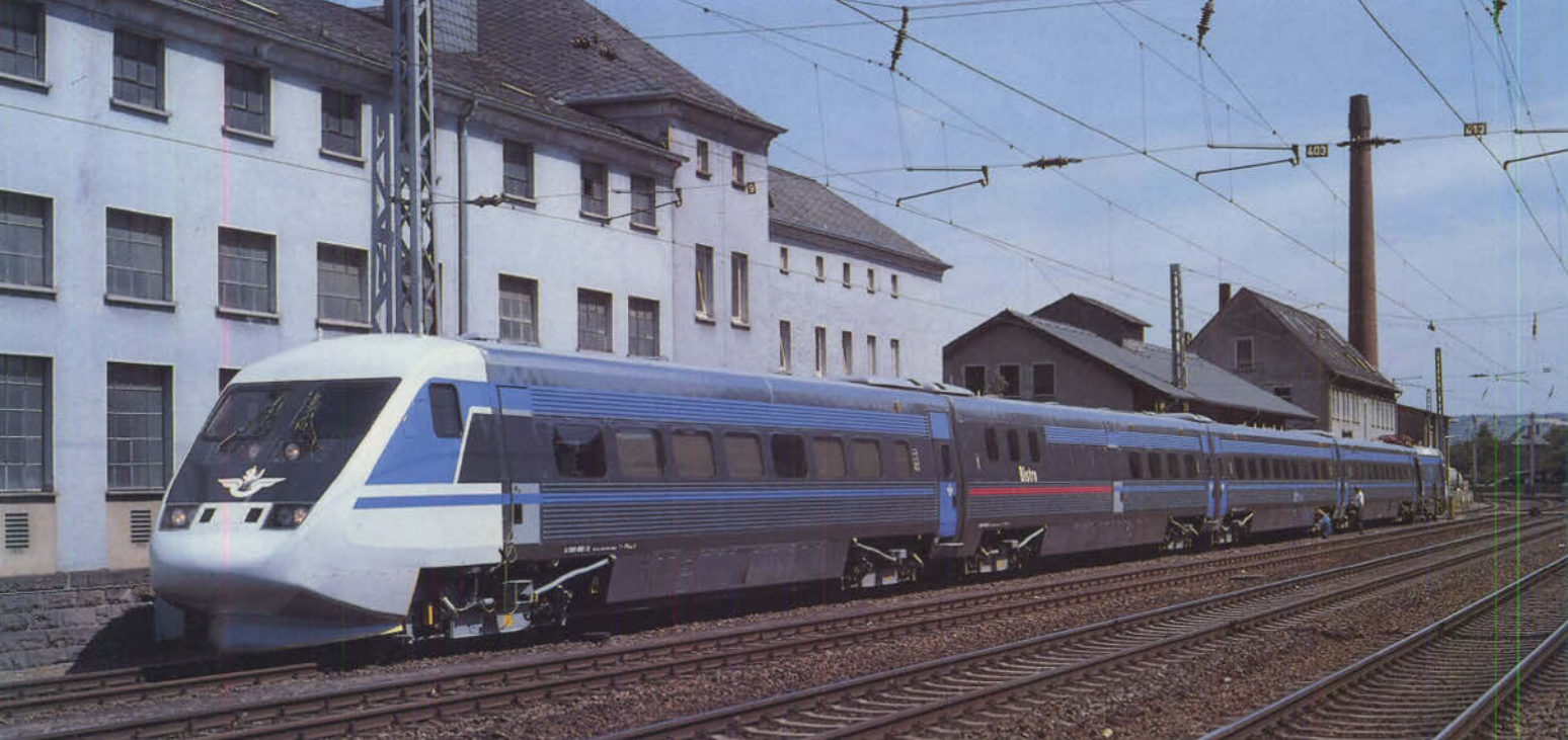
Bild 4: Auf diesem Foto (Bw Trier, 13. Juli 1991) erkennt man deutlich die Stützgestänge der Pendelhydraulik. Diese ist auch im Steuerwagen, nicht jedoch im Triebkopf eingebaut. Foto: G. Dollwet
