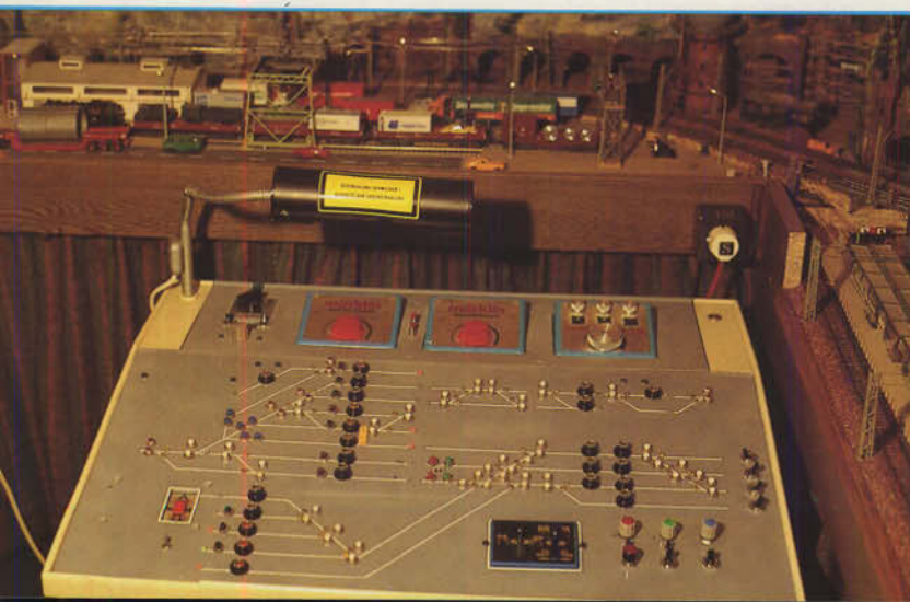
Bild 6: Das Gleisbildstellpult entstand aus einem alten Schreibtisch. Es läßt sich über Rollen an jede Stelle der Anlage bewegen.
