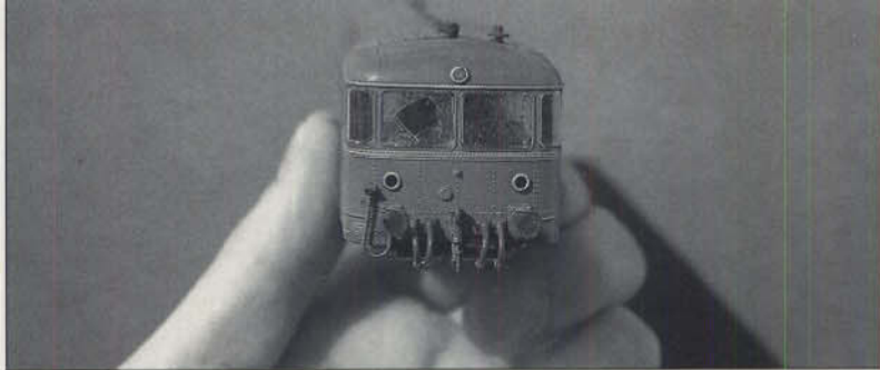
Bild 15: Nach dem Abziehen der Abdeckfolie sind die Spuren des Scheibenwischers auf der Frontscheibe sichtbar.
