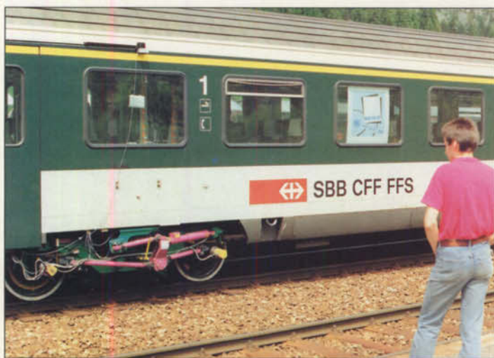
Eine besonders kostengünstige Lösung für neigbare Wagenaufbauten verspricht das vor einiger Zeit in der Schweiz getestete "Neiko"-System.
