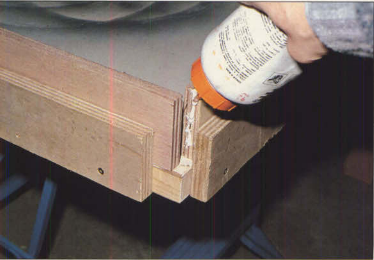
Bild 7: An den Anschlägen werden die Rahmenbretter zusammengeleimt.
