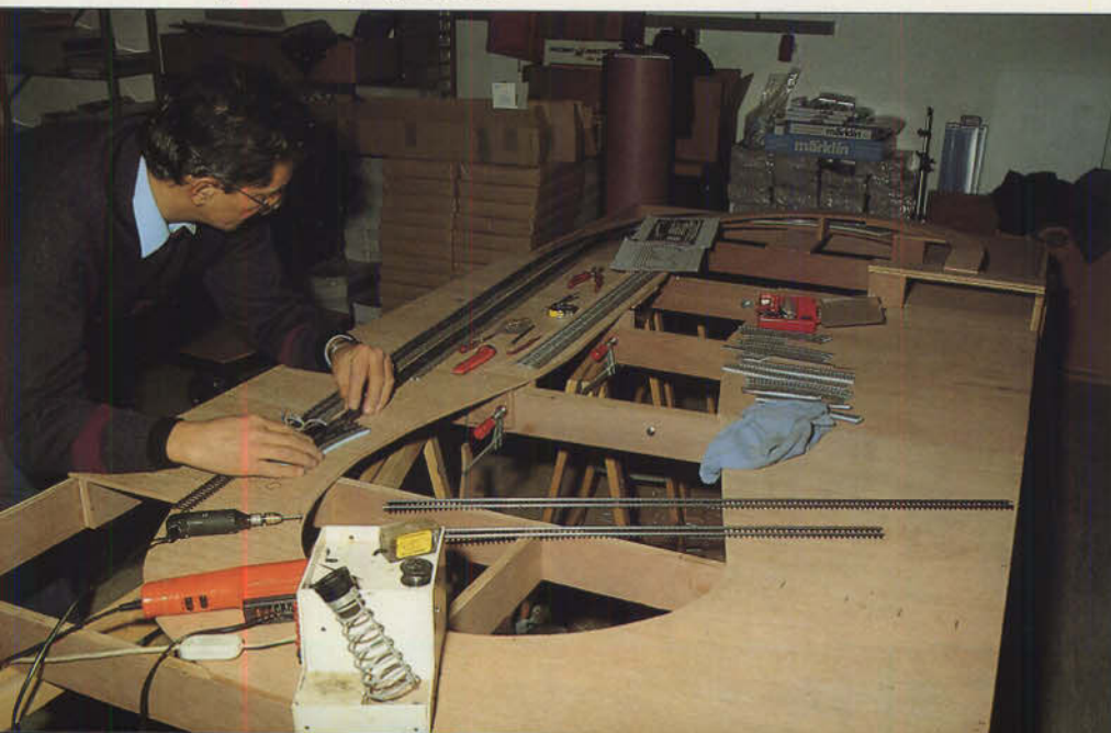
Bild 28: Nach der Gleisverlegung im Vorortbahnhof wird die abzweigende Trasse zum Bw im vorderen Anlagenteil in Angriff genommen.
