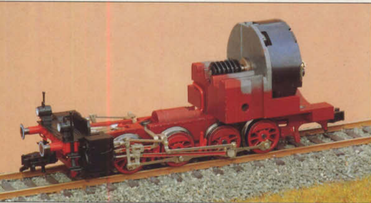
Bild 12: Der einfache, aber bewährte Antrieb der GtL 4/4, der für den Einbau in die Modelle der 98 811 und 812 modifiziert wurde.
