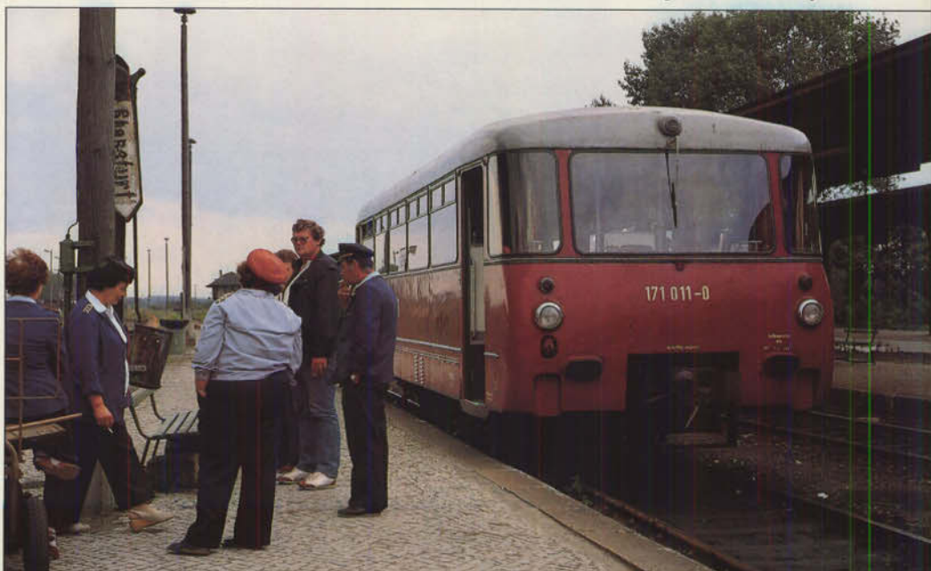
Bild 7: Kleiner Plausch zwischen Zugpersonal und Fahrgästen am Bahnsteig in Blumenberg am 30. Juli 1988. Der Triebwagen 171 011 verfügte zu diesem Zeitpunkt noch über die ursprüngliche Frontscheibe – ungeteilt und leicht gewölbt; sie besteht aus 6 mm dickem Sicherheitsglas. Foto: J. Gutjahr
