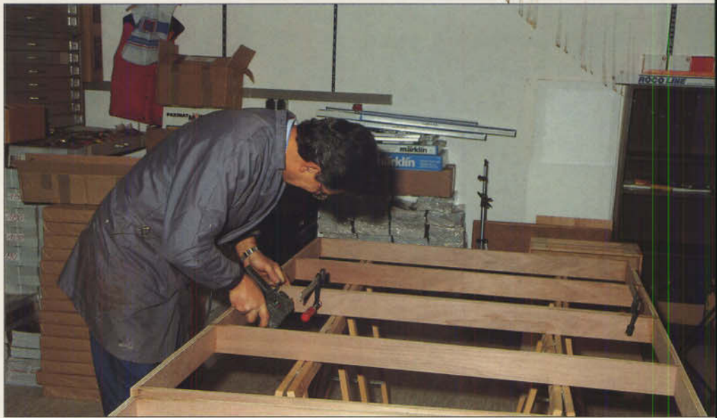
Bild 15 (rechts): Die Bohrungen für die schraubbare Verbindung werden angebracht und die Rahmenteile zu einem Ganzen verbunden.
