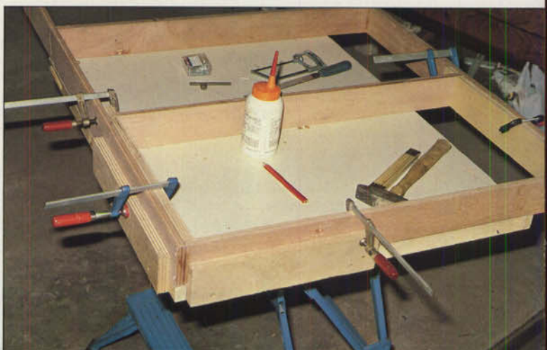
Bild 12: Ein fast fertiger Rahmen während des Trocknens nach dem Verleimen. Der mit den Schraubzwingen an den Montagelehren arretierte Rahmen wird dadurch genau im 90°-Winkel ausgerichtet. Damit entfallen aufwendige Kontrollmessungen.
