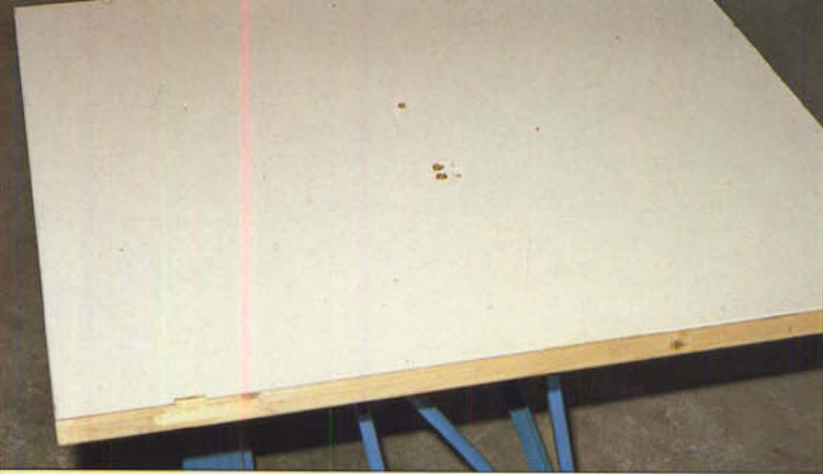
Bild 5: Ein halbes Türblatt oder etwas Ähnliches – es muß aber rechtwinklig sein – dient als Werkbank für den Zusammenbau der Rahmenteile.
