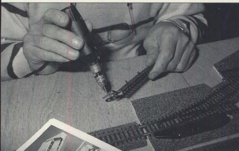
Bild 22: Mittels Bohrzweig und Trennscheibe werden die Kunststoffnippel der Anschlußgleise an der SchiebEbühne entfernt, um einen niveaugleichen Übergang zu erreichen.
