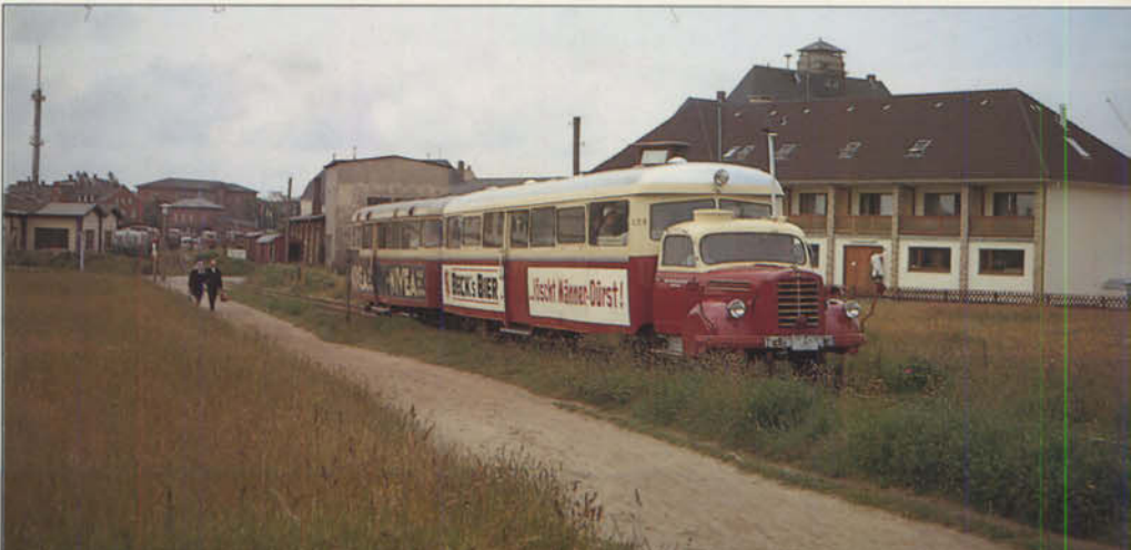
Bild 2: So rollte er unermüdlich über die Insel Sylt – das Unikum eines Triebwagens mit Lkw-Charakter. Fotos: H.-J. Windberg
