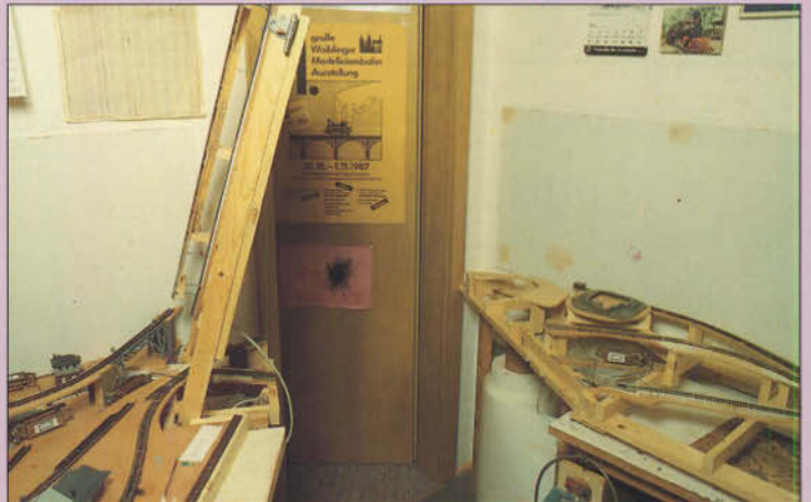
Bild 17: Der Drehpunkt des klappbaren Anlagenelements liegt etwa 20 cm innerhalb des feststehenden Anlagenteils. Dadurch wird Quetschen der Gleise beim Öffnen und Schließen ausgeschlossen.
