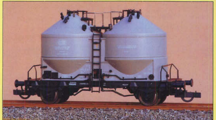
Bild 8: Dritter im Bunde ist der Ucs 909 mit dunkelgrauen Behältern, in denen beim Vorbild das Ladegut Quarzsand befördert wird.
