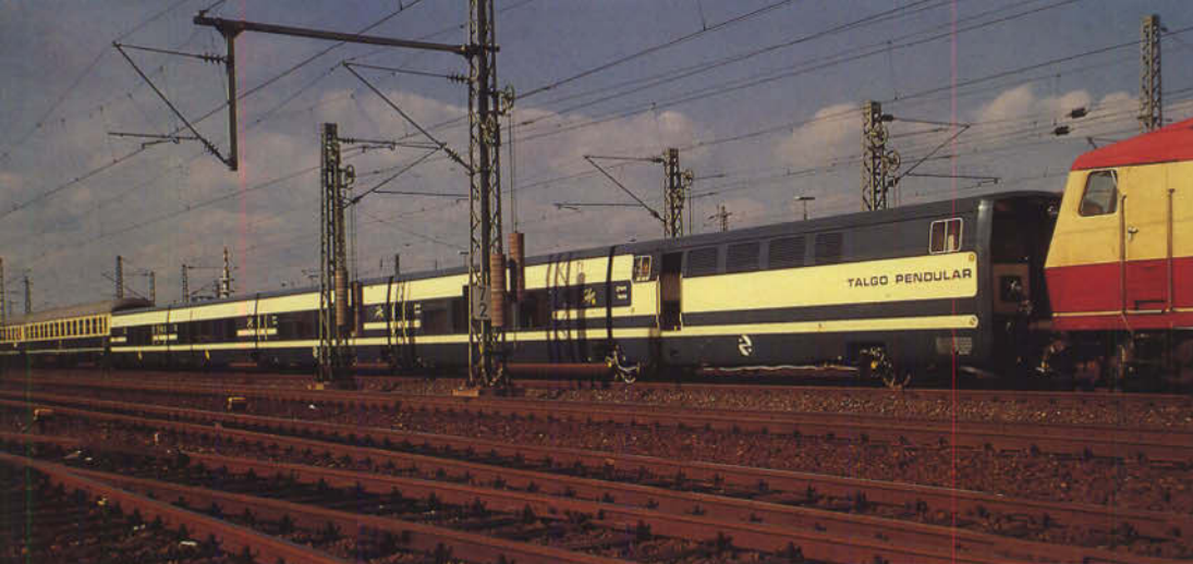
Der spanische Talgo Pendular wieder einmal zu Gast auf Bundesbahngleisen. Er absolvierte Anfang April mehrere Hochgeschwindigkeitsmeßfahrten, gezogen von der DB-Lokomotive 752 001. Das Bild entstand im Bahnhof Wülfel. Foto: Ch. Fricke
