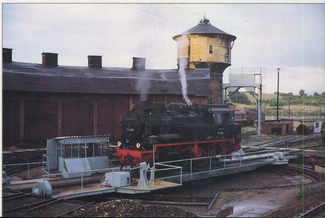
Bild 9: Eine Besonderheit im ehemaligen Bw Gerstungen (heute Est.) ist diese Drehscheibe mit Verlängerungswagen. Foto: U. Tietze
