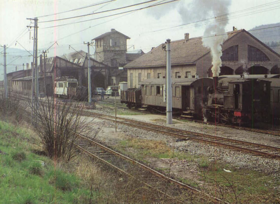
Bild 5: Im Bw Busenbach hat sich die 99 7203 vor einen Bauzug gesetzt. Unscheinbar, aber bemerkenswert ist der Dreisystem-Triebwagen im Hintergrund. Mit diesem umgebauten ex ET 22 der Mühlheim-Badenweiler-Eisenbahn wurden bereits 1958 Gleichrichter-Versuchsfahrten im AVG-Netz (8800 V Wechselstrom, 25 Hz, umschaltbar auf 50 Hz) und dem Netz der Kleinbahn Pforzheim – Ittersbach (1200 V Gleichstrom) unternommen.
