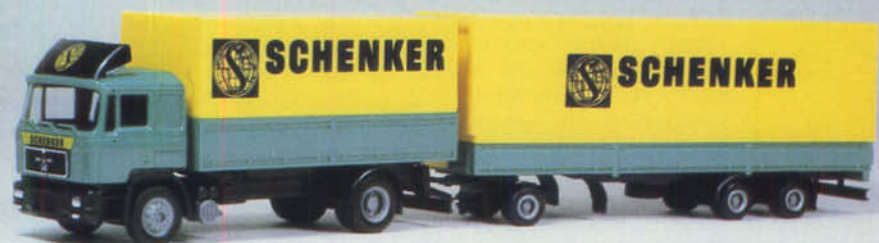
Bild 3: Dem Original exakt nachgebildet wurde der MAN-F-90-Hängerzug Transmaximal mit dem Firmenzeichen der Firma Schenker, dessen spezielle Lenkmechanik einen minimalen Abstand zwischen Zugmaschine und Anhänger gestattet. Die Planen sind abnehmbar.
