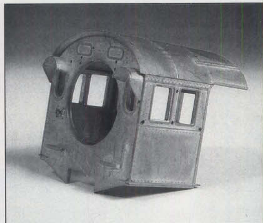
Bild 5: Die sehr detailgetreu nachgebildete Rückwand des Stehkessels in unlackiertem Zustand.
