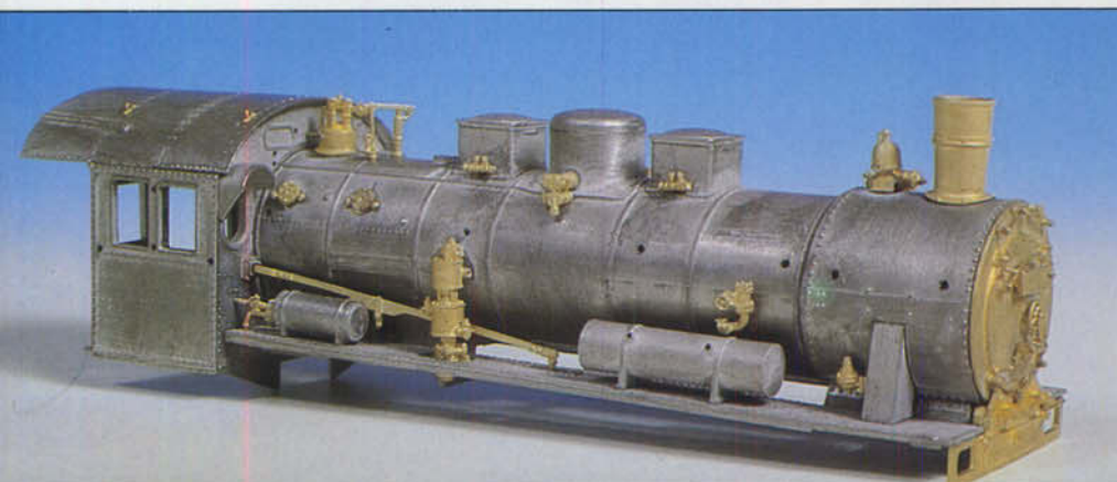
Bild 4: So schaut das zusammengebaute Lokgehäuse mit seinen Messing-Anbauteilen aus; es fehlen nur noch die diversen Leitungen und Griffstangen.
