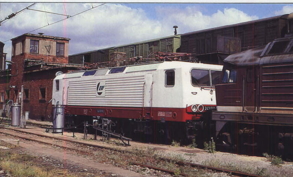
Bild 8: LEW Hennigsdorf kaufte die 243 001 im Jahre 1987 von der DR zurück, um sie als Erprobungsträger für Drehstromantriebstechnik (DAT) zu verwenden. Die Aufnahme vom 26. Mai 1990 zeigt die 243 001 in der aktuellen Lackierung im Bw Berlin Hbf. Foto: M. Krolop
