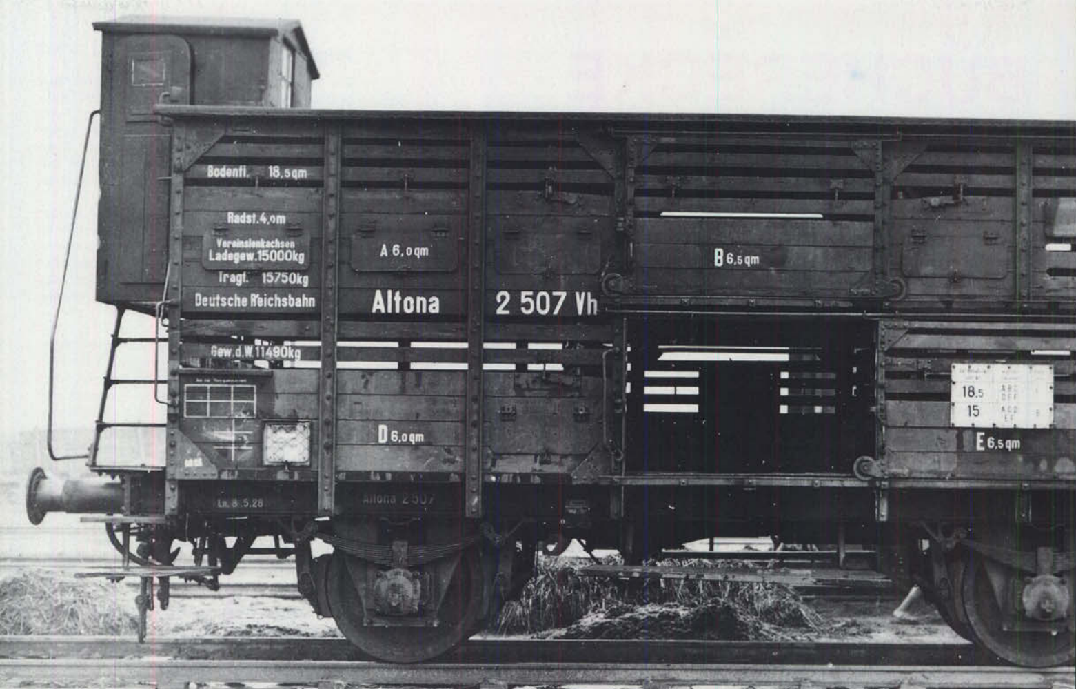
◀ Bild 2: Einen Viehwagen der Wittenberge-Perleberger Eisenbahn nach der preußischen Musterzeichnung Ild 10 zeigt dieses Bild. Der Wagen wurde am 10. November 1910 abgeliefert und in den Park der KED Altona mit der Nummer 18200 eingestellt. Als Privatbahnwagen führt er nicht das preußische Adlerschild. Gut zu erkennen sind die länderbahntypischen Eigenarten dieser Wagenbauart: gewölbtes Bremserhausdach, Unterkasten in Wagenmitte. Reproduktion: F. Willke, Sammlung Heidt
