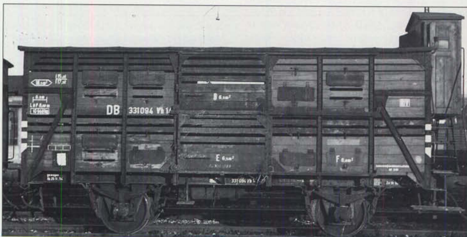
Bild 10: Auffallend hoch sind bei diesem 1954 fotografierten Viehwagen 331 094 der Verbandsbauart die waagerechten Streben der Wagenkastenversteifung in den Endfeldern angebracht. Im Gegensatz zu den übrigen hier vorgestellten Viehwagen besitzt er eine Knorr-Bremse mit G-P-Umstellung, wie an den trapezförmigen Kennzeichen an den Eckrungen zu erkennen ist. Das Bremserhaus weist nicht mehr die ursprünglich überkragende Form auf. Foto: F. Willke, Sammlung Heidt
