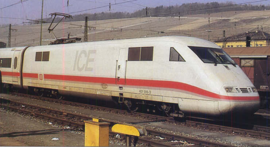
Am 14.3.91 in Würzburg beobachtet: ein ICE mit zwei Stromabnehmern auf dem Triebkopf (401 015). Es handelt sich hierbei um Untersuchungen des kleineren Pantographen für das Schweizer Lichtraumprofil, der aller Wahrscheinlichkeit nach die 19 Züge der zweiten ICE-Serie ergänzen wird und Voraussetzung für Fahrten bis über Basel hinaus ist. Foto: A. Schöpfer
