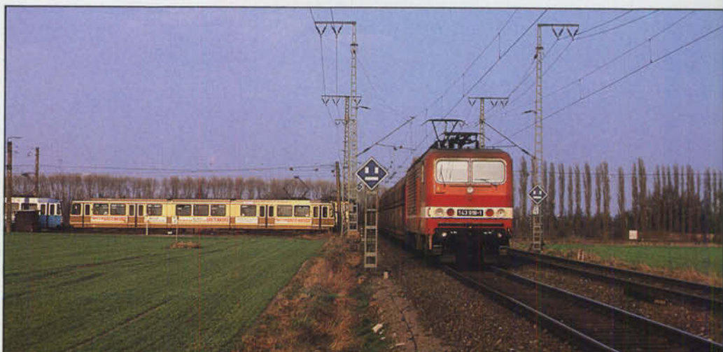
Bild 18: Ein Bahnübergang ganz besonderer Art existiert an der nördlichen Dortmunder Umgehungsstrecke für den Güterverkehr zwischen Dortmund-Obereving und Dortmund-Huckarde Nord: Die Straßenbahnlinien U 45 und U 49 nach Westerfilde kreuzen beim Posten 3 die DB-Gleise. Ein Straßenbahnzug wartet die Vorbeifahrt des von der 143 918 geführten Ganzzuges ab. Foto: M. Hüser
