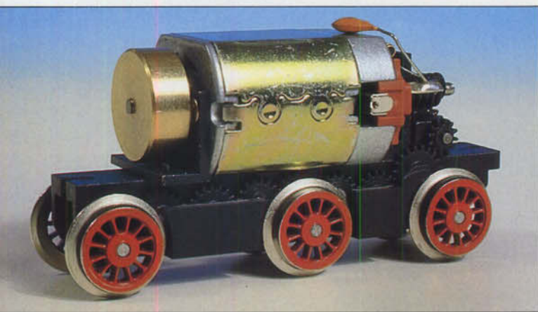
Bild 11: Das lauffertig vormontierte und lackierte Antriebsfahrgestell des Tenders 3 T 18,5 der Baureihe 55.
