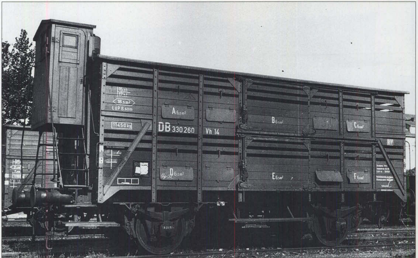
Bild 7: Bei diesem Waggon ist das Bremserhaus vereinfacht worden. Der Wagen 330 260 dürfte unmittelbar nach der Umzeichnung durch die DB im Jahre 1952 fotografiert worden sein. Foto: F. Willke, Sammlung Heidt
