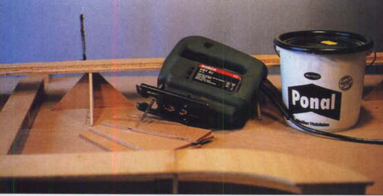
Bild 1: Alle Trassen, also Bahndämme und Straßen, werden aus 6 mm starkem Sperrholz gefertigt. Eine Stichsäge leistet gute Dienste.
