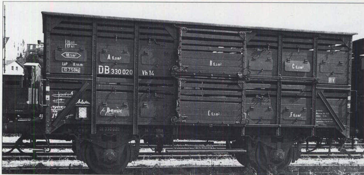
Bild 9: Der DB-Wagen 330 020 der Verbandsbauart besaß früher ein Bremserhaus, erkennbar an dem links überstehenden Untergestell. Die Aufnahme entstand 1952. Foto: F. Willke, Sammlung Heidt
