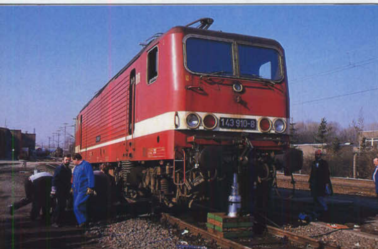
Bild 16: Nicht nur die DB-Lokführer, auch die Hilfszugmannschaften müssen sich erst an die neue Lok von der Deutschen Reichsbahn gewöhnen. Am 14. März 1991 wurde im Bw Dortmund das Wiederaufgleisen einer 243 geübt; "Versuchskaninchen" war die 143 910. Foto: M. Hüser
