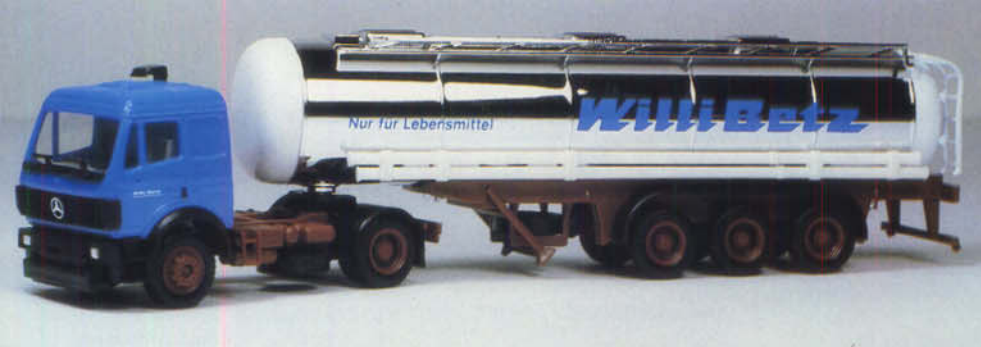
Bild 1: Für Lebensmitteltransporte ist der MB-Tanksattelzug "Willy Betz" bestimmt. Die Zugmaschine besitzt ein kippbares Fahrerhaus. Die Auspuffanlage befindet sich wie bei Gefahrgut-Zugmaschinen unter der vorderen Stoßstange. Der dreilachsige Lebensmitteltankauflieger verfügt über Laufsteg und seitliche Rohrre. Die Aufliegerstütze ist ausklappbar.
