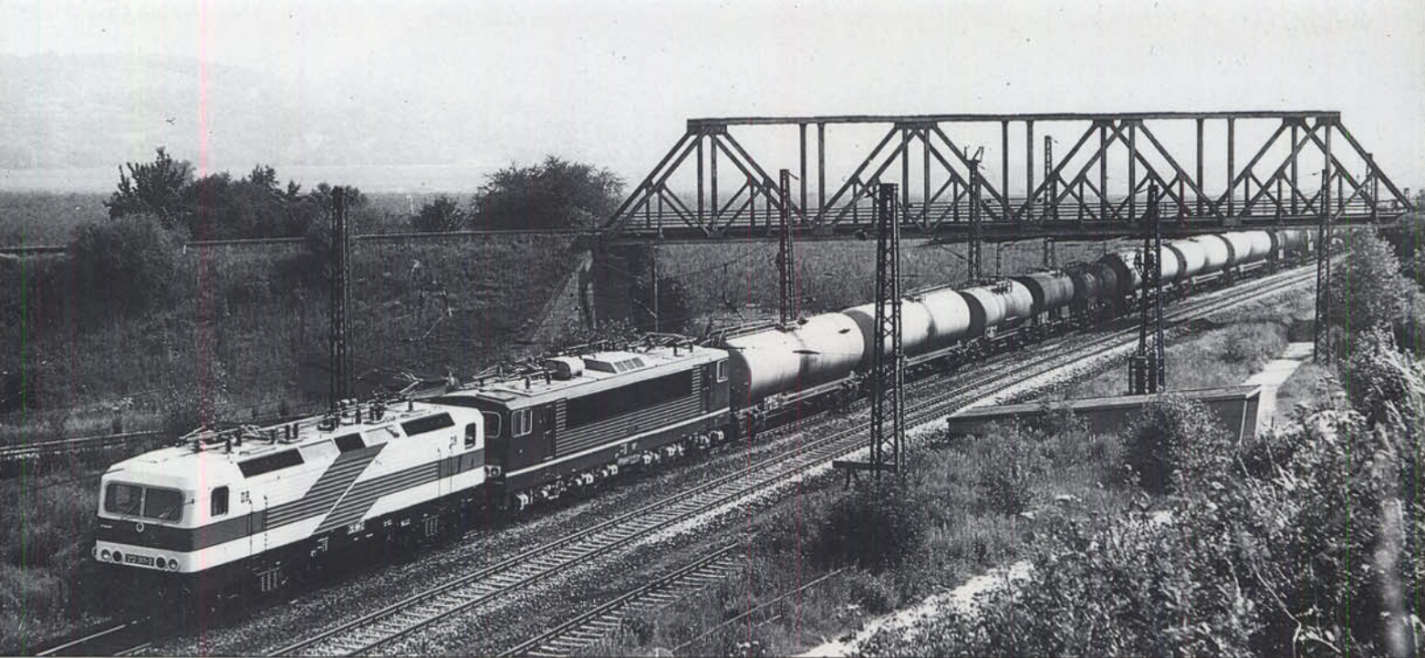
Bild 5: Die Baumusterlokomotive 212 001 wurde auch im Güterzugdienst erprobt. Am 10. Juli 1982 zieht sie hier auf der Strecke Leipzig – Großkorbetha einen Kesselwagen-Ganzzug (und eine abgebügelte Lokomotive der Baureihe 250). Foto: M. Malke
