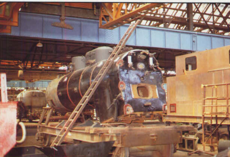
Bild 2: Der ausgebaut Kessel der 91 6580 im Juli 1990 in Bearbeitung.
