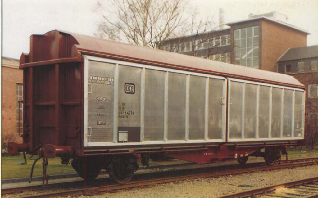
Bild 10: Ein Hbillss 303 (hier die Ausführung Hbikks-t 303 mit der Nummer 21 80 237 5 431-8), die Ursprungsbauart des vorn gezeigten Hochgeschwindigkeits-Schiebewandwagens.
