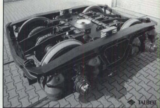
Bild 7: Mit dieser Bremskonstruktion werden auch die Geräuschemissionen vermindert (Bauart DB 675). Foto: Werkfoto TALBOT
