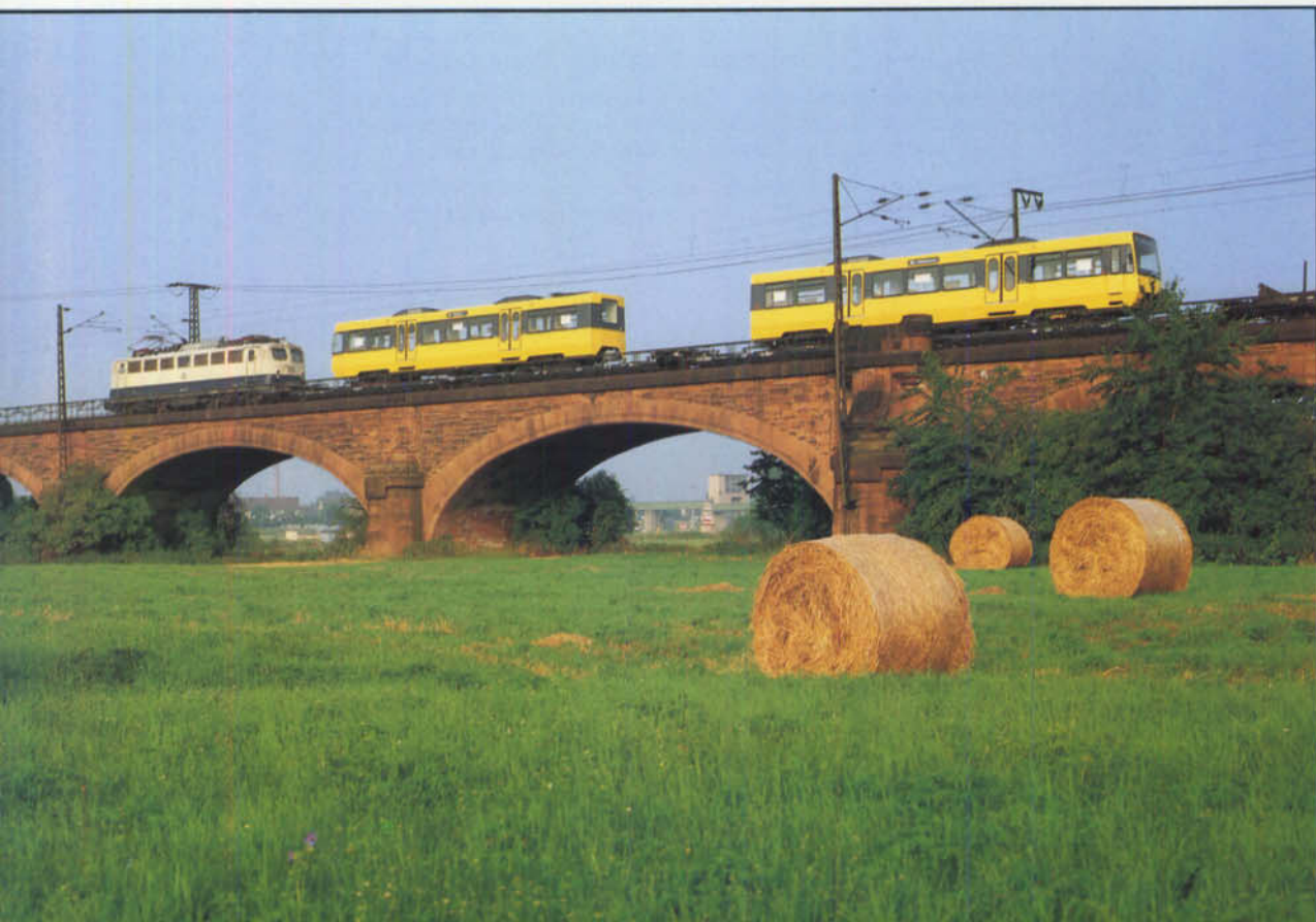
Bild 5: Eine ungewöhnliche Ladung hat der Fotograf am 24. Juni 1989 auf der Mainbrücke bei Mainz-Bischofsheim im Bild festgehalten. Gleich hinter der Zuglok der Baureihe 140 waren an diesem Tag im Dg 54063 Niederflurwagen, beladen mit zwei fabrikneuen Halbzügen für die Stuttgarter Straßenbahnen (Typ DT 8, gebaut von DUEWAG, Spurweite 1435 mm), eingestellt. Foto: J. Seyferth
