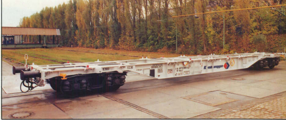
Bild 4: Dieser Sgss-y 703 (P) mit der Aufschrift "Kombiwaggon" veranschaulicht das neue Konzept für Container- und Wechselbehältertragwagen. Die Nummer 82 80 457 0 000-6 (P) verrät aber, daß es sich hier um einen Umbau zum "Vorzeigen" handelt. Die 90 bestellten Wagen dieser Bauart werden alle komplett neu gebaut. Foto: dbp
