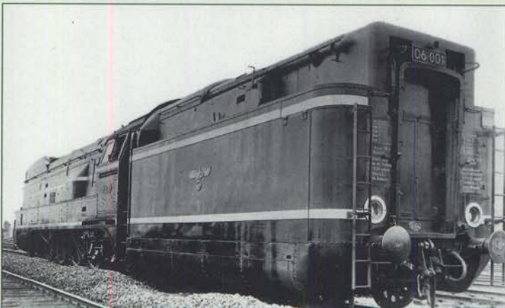
Bild 9: Auch die beiden Lokomotiven der Baureihe 06, hier die 06 001, waren mit den fünfachsigen Stromlinientendern der Bauart 2'3 T 38 St gekuppelt. Foto: H. Maey, Sammlung Dr. Scheingraber
