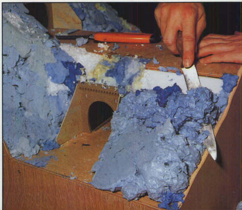
Bild 8: Mit einem großen scharfen Messer werden jetzt die Konturen herausgeschnitten. Hierbei ist darauf zu achten, daß die Hänge nicht zu steil werden.
