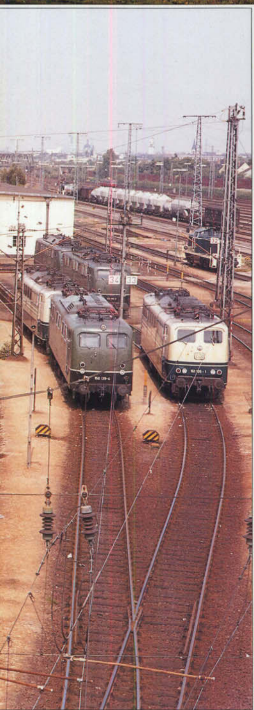
Bild 11: Die Lokomotiven der Baureihe 139 unterscheiden sich von der Baureihe 140 äußerlich durch zusätzliche Lüftungsschlitze im Dachaufbau. Das Foto Sommer 1990 zeigt die 139 165. Foto: H. Obermayer
