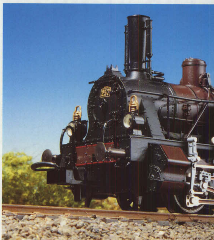
Bild 5: In feinsten Kleinserientechnik war seinerzeit die D VIII von Fuchs gefertigt. Sie stellte eine Nachbildung der schwersten Ausführung der bayerischen C1' dar. Beim Vorbild war sie dazu bestimmt, Züge von Freilassing nach Berchtesgaden über die Steigung zwischen Bad Reichenhall und Hallthurm anstandslos zu befördern. Leider ist das Modell ausverkauft.
