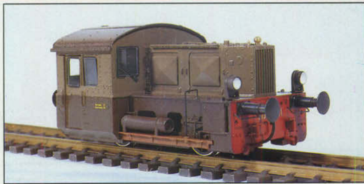
Bild 17: Italienische Ausführung der Brawa-Köf 2 mit geschlossenem Führerhaus.
