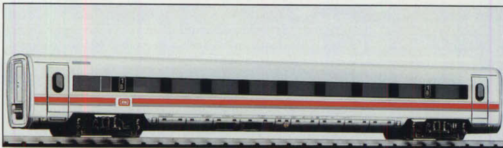
Bilder 72 und 73: ICE-Mittelwagen Avmz 801 (links) und Servicewagen WSmz 804 als Ergänzungsfahrzeuge zu der dreiteiligen Garnitur.
