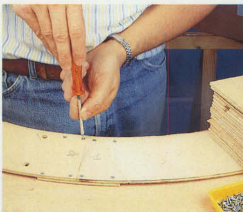
Bild 7: Acht Schrauben verbinden zwei Elemente mit Hilfe eines Sperrholzbrettchens.
