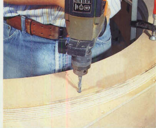
Bild 3: Mit einer elektrischen Bohrmaschine erhalten sämtliche Kreise die für die Stangen erforderlichen Löcher.
