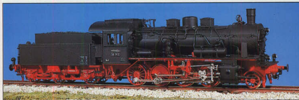
Bild 92: Weinert's BR 56 2 als umgebaute G 8 1 mit Vorlaufachse in DRG- und DB-Ausführung.
