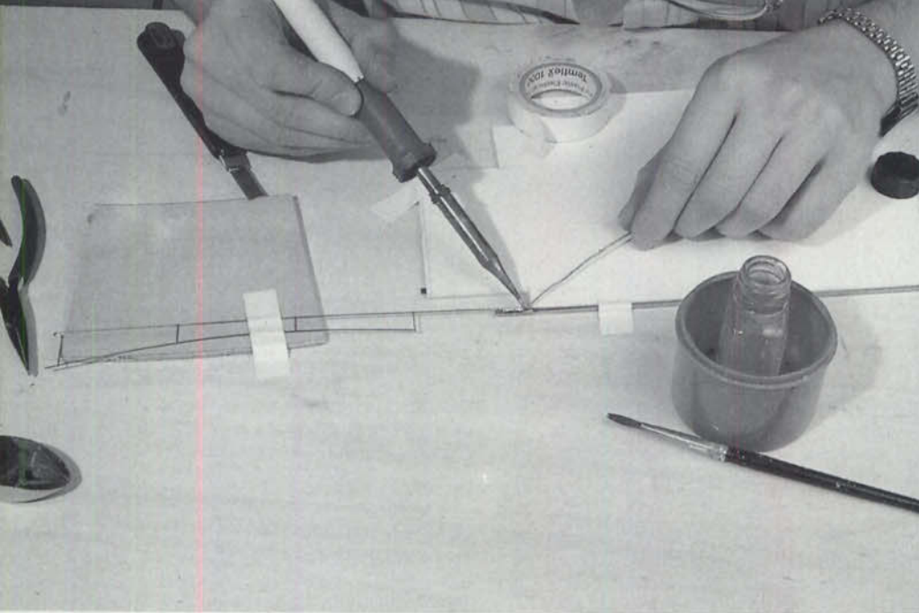
Bild 22: Verlöten der Modell-Oberleitung mit der Schiene, die innerhalb der Gleiswendel als Fahrleitung dient.
