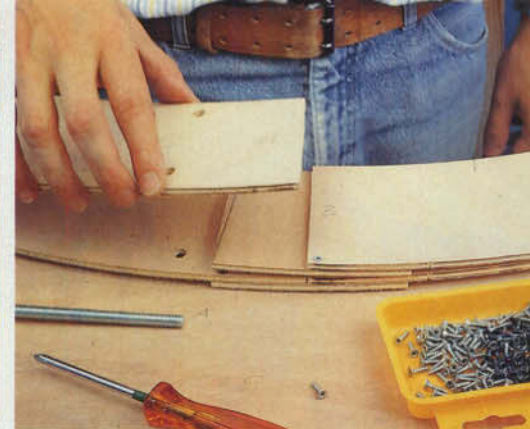
Bild 5: Die Verbindungsbrettchen werden auf der Unterseite der Elemente angebracht.
