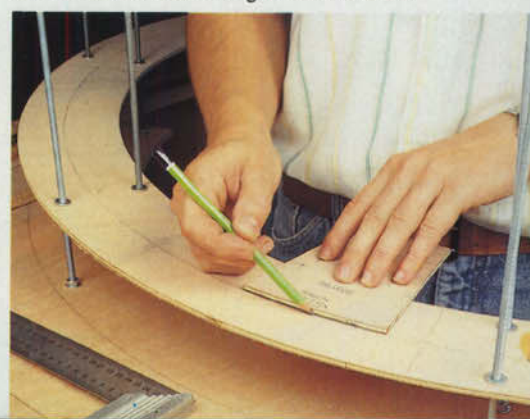
Bild 11: Aufzeichnen der Gleisachse mit Hilfe einer Schablone. Mit derselben Schablone kann der Verlauf der Fahrleitung markiert werden.
