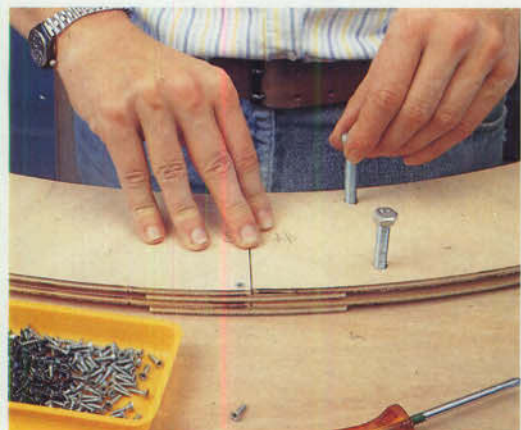
Bild 6: Bolzen, die man in die Löcher für die Metallstäbe steckt, ermöglichen die exakte Montage der Kreiselemente.
