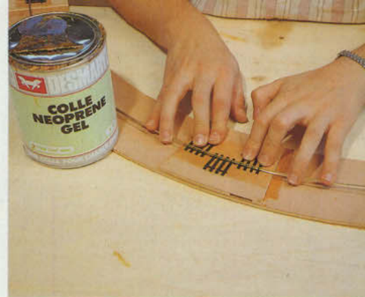
Bild 20: Gemäß dem angezeichneten Verlauf der Fahrleitung wird hier gerade ein Stück Schiene mit Schwellen aufgeklebt.
