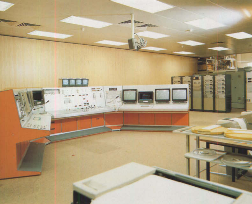
Bild 7: Der Rollprüfstand ist mit diesem Leitpult in der Meß- und Steuerzentrale verbunden. Sämtliche Analyseergebnisse werden hier sichtbar und natürlich auch gespeichert.
