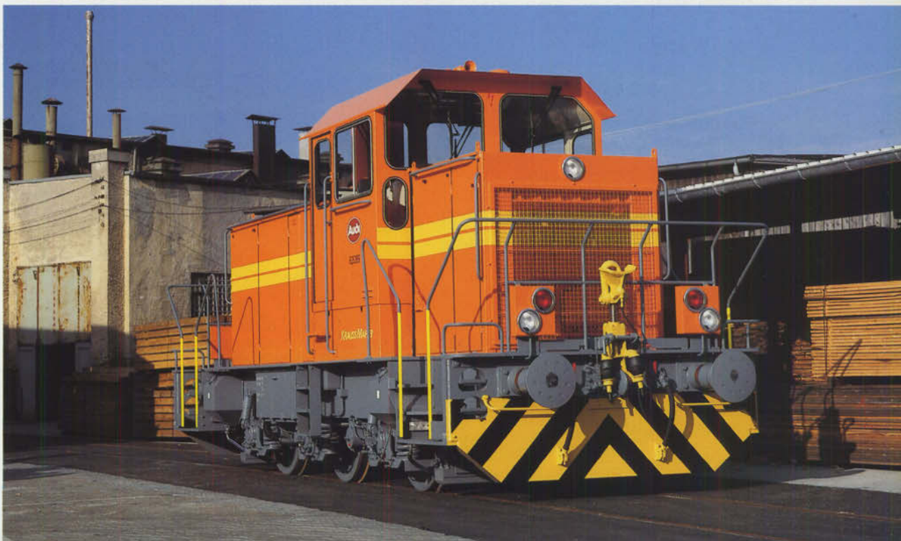
Bild 6: Neue Lokomotiven werden inzwischen ab Werk mit den jeweils erforderlichen Steuer- und Regelsystemen ausgestattet, so auch diese von Krauss-Maffei gelieferte Rangierlokomotive vom Typ MH 05 (Leistung: 505 kW), die bei Audi in Ingolstadt im Einsatz ist.
