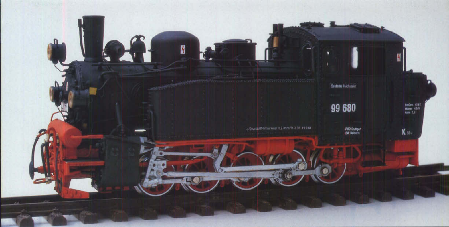
Bild 4: Der Dampfdom wirkt nicht zu groß; er hatte tatsächlich solche Ausmaße.
