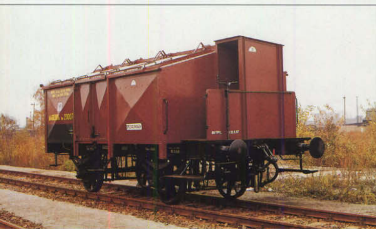
Bild 11: Der vom Raw Dresden rekonstruierte Kalkwagen nach preußischer Musterzeichnung Ild 4 wurde nach Abschluß der Arbeiten am 14.10.1988 dem Verkehrsmuseum Dresden übergeben. Foto: G. Krummbiegel
