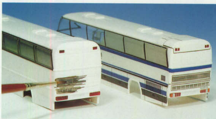
Bild 2: Düninflüssige Farbe wird mit dem Pinsel aufgetragen.
