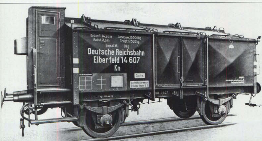
Bild 2: Mit den Anschriften der Deutschen Reichsbahn ist dieser Kalkwagen mit Handbremse Elberfeld 14607 unmittelbar vor der Ablieferung aufgenommen worden. Das Wagengewicht, das Untersuchungsdatum und die Haftpflichtdaten sind noch nicht angeschrieben. Die Aufnahme dürfte etwa 1923 entstanden sein. Foto: Sammlung Diener
