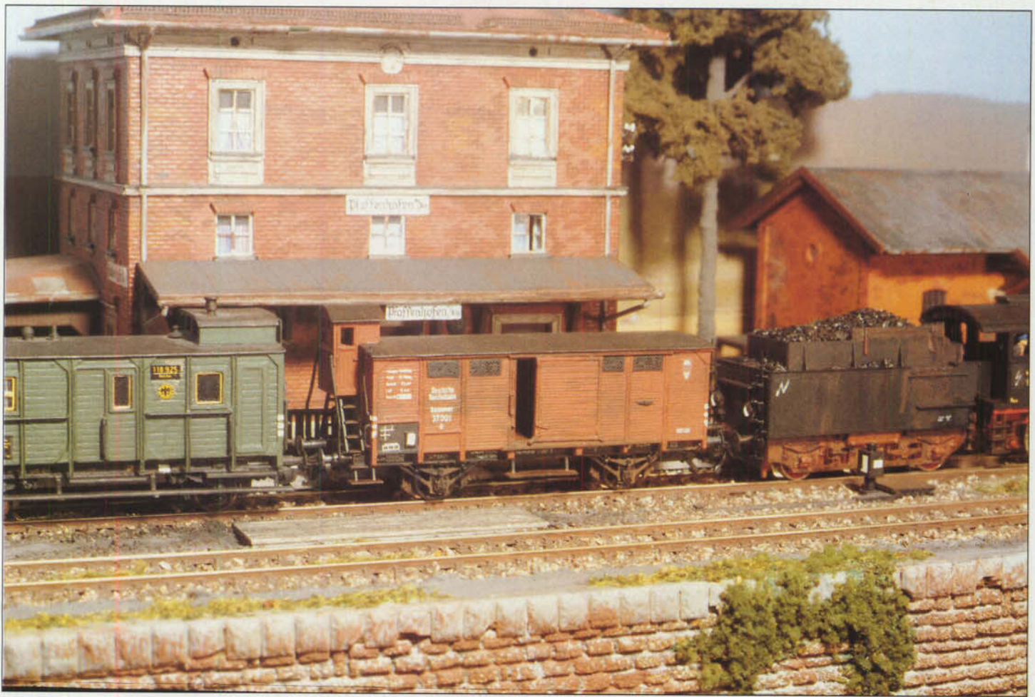
Bild 3: Ein Glm der ehemaligen K.Bay. Sts. B. im Reichsbahnkleid. Grundlage dieses Modells bildete der Trix-Wagen 23623, dessen Achsstand korrigiert wurde.
