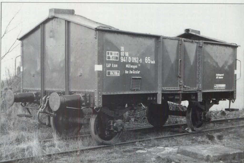
Bild 9: Kalkwagen der Verbandsbauart erhielten sogar noch die international vereinbarten computergerechten zwölfstelligen Kennnummern, wie dieses zum Müllwagen degradierte Fahrzeug des Bw Goslar zeigt, aufgenommen am 4. April 1971. Seine Kennnummer lautet: 30 80 941 0 092-9. Die Klappdeckel, ein Teil des Dachträgers und einige Trittstufen fehlen; an den Stirnwänden sind Signalhalter der UIC-Bauart zu erkennen.
