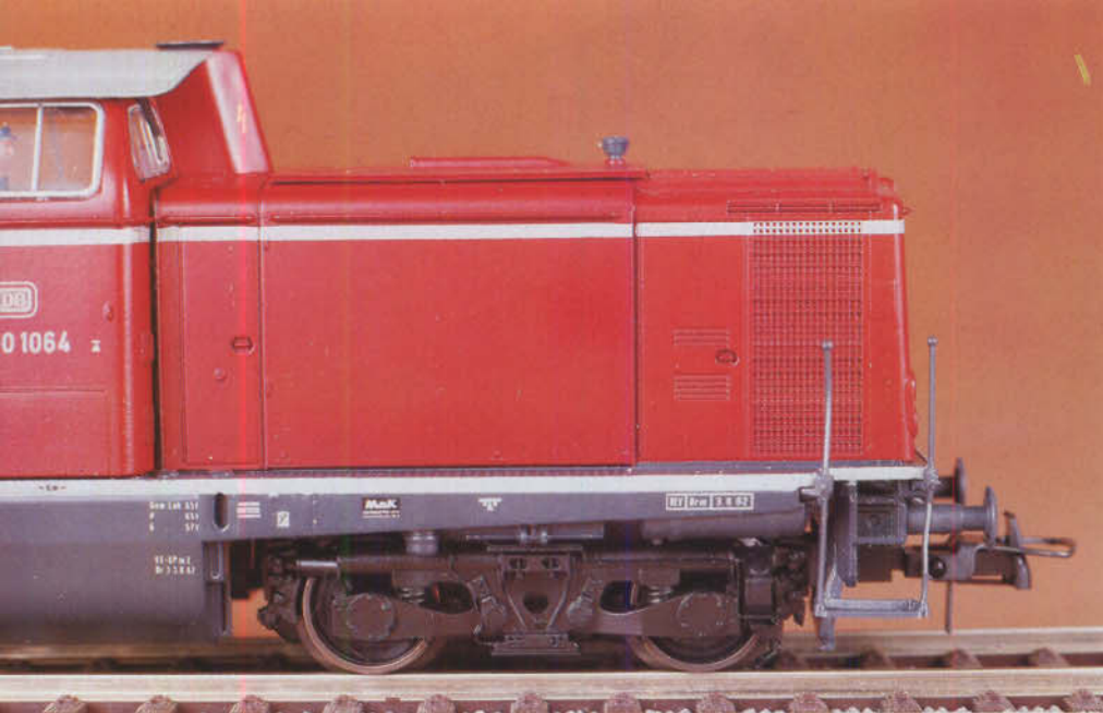
Bild 9: Einfahrt für die V 100 1064. Dank ihrer pendelnd gelagerten Drehgestelle läuft die Lok sehr ruhig.
