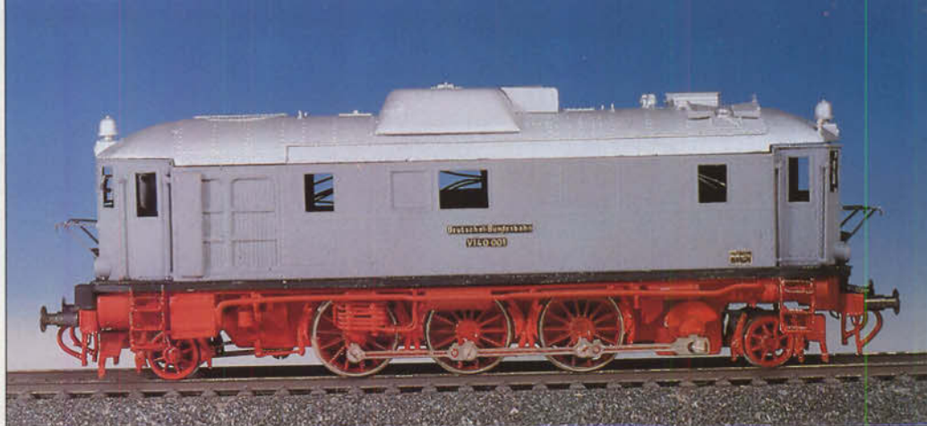
Bild 10: Das Lokmodell besticht durch ein sehr sorgfältig gearbeitetes Fahrwerk mit Blindwelle und Treibstange.
