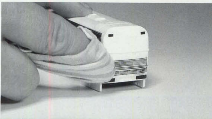
Bild 4: Die wäßrige Farbe wird mit einem Lappen wieder abgewischt. So patiniert man Lüftungsgitter von Fahrzeugen, die beim Vorbild immer verschmutzt sind.
