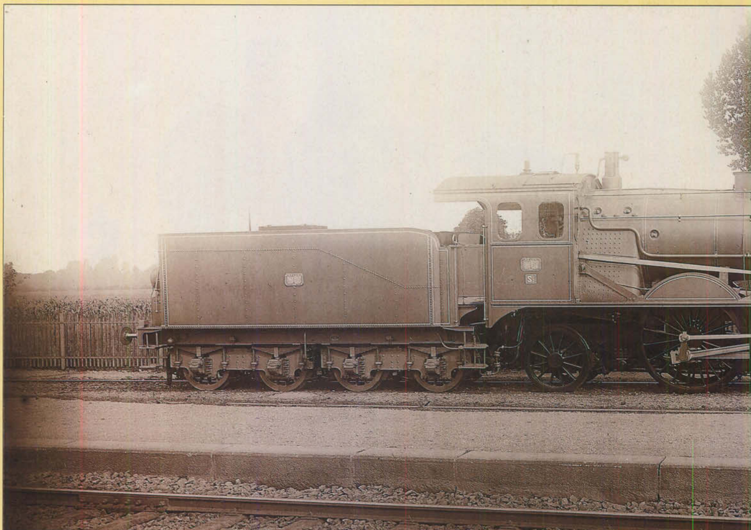
Bild 5: Von den zehn Lokomotiven der Bauform Grafenstaden II sind kaum Lichtbilder bekannt. Umso erfreulicher ist es, daß sich diese prächtige Werkaufnahme aus Grafenstaden in unsere Tage hinübergerettet hat. Die Mainz 450 (gebaut 1904 von Grafenstaden, Fabrik-Nr. 5378) wurde 1906 zur (S 7) Mainz 701.
