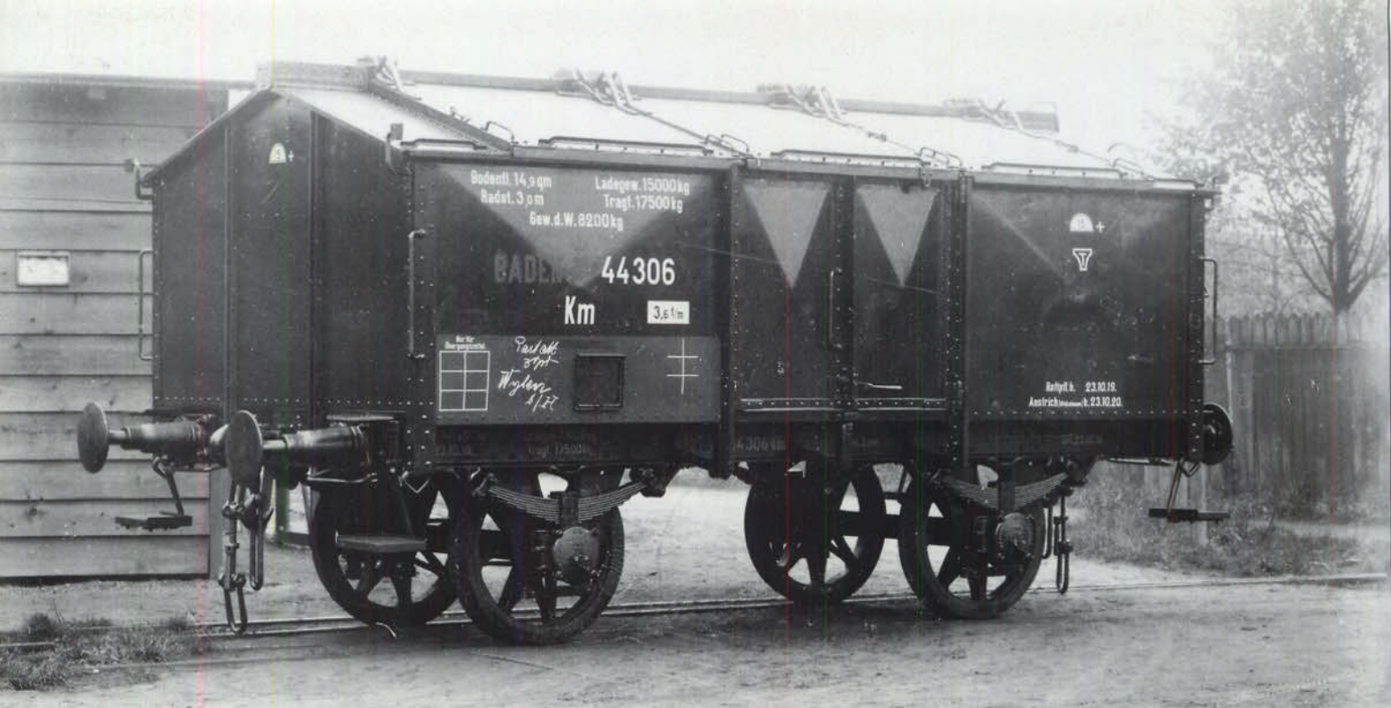
Bild 1: Der badische Kalkwagen Km 44306 der Verbandsbauart wurde am 23. Oktober 1918 abgenommen. Hier ist die Stirnseite mit den zwei Trittstufen aus Riffelblech zu sehen; diese befinden sich unmittelbar über den Puffern. Der Wagen besitzt Speichenräder statt der sonst üblichen Scheibenräder. Werkfoto Waggonfabrik Rastatt, Sammlung Märklin
