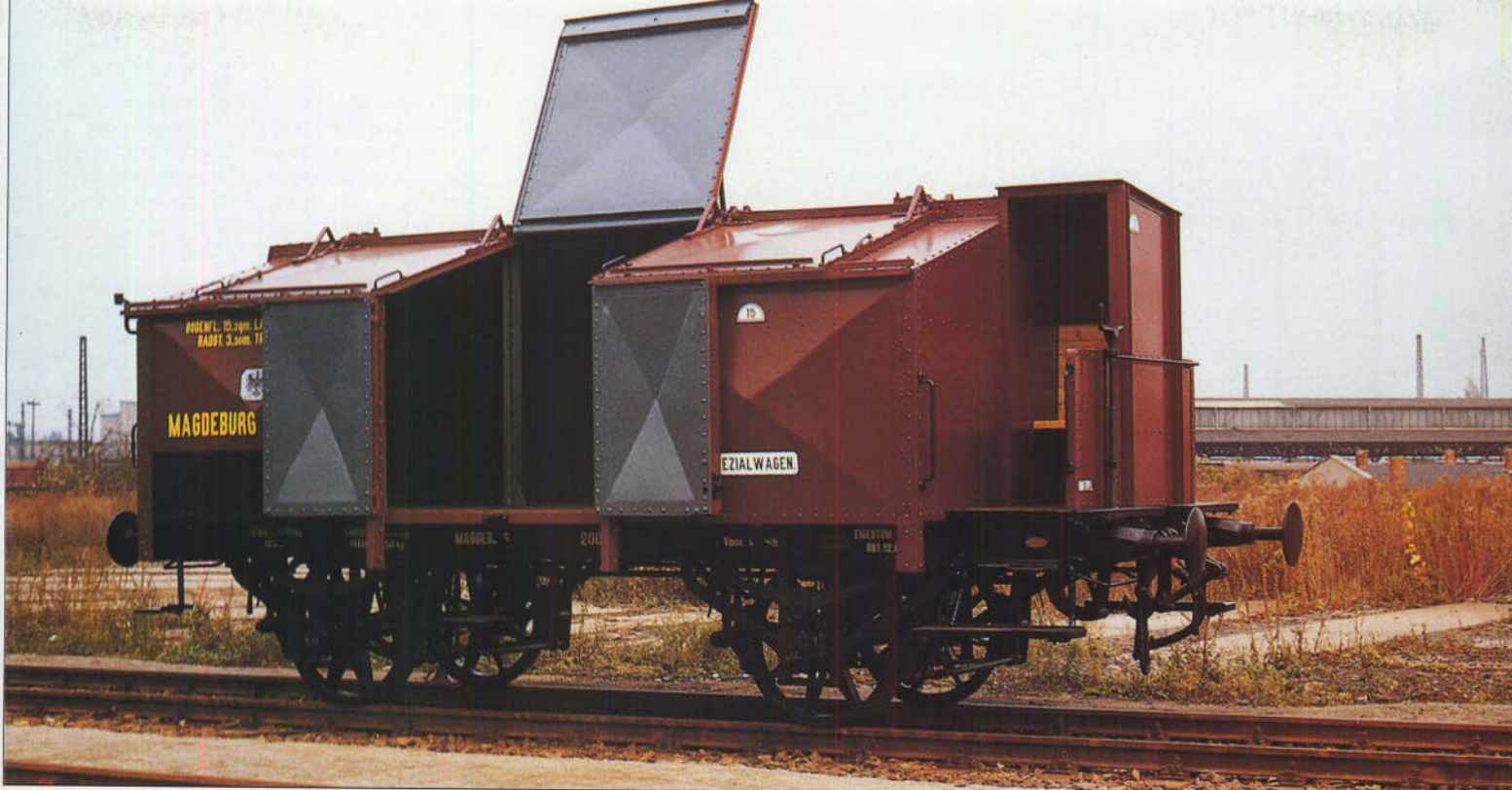
Bild 3: Ein Kalkwagen nach Musterzeichnung Ild 4 der Königlich Preußischen Eisenbahn-Verwaltung wurde von der Deutschen Reichsbahn 1988 restauriert und äußerlich weitgehend in den Zustand von 1896 zurückversetzt. Gut erkennbar sind die preußische Bauform des Bremserhauses und die für alte Länderbahnwagen typischen fachwerkförmigen Achshalter. Foto: G. Krummbiegel
