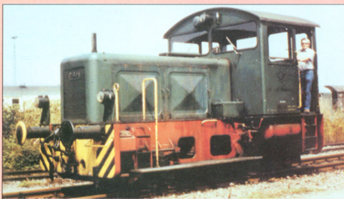
Bilder 6 und 7: Von 1960 an war diese Gmeinder-Diesellok bei der OPD Freiburg im Einsatz. Die Fabrik-Nr. 5247 war zugleich als Lok-Nr. Klein am Führerhaus angeschrieben. Das Farbfoto belegt, daß nicht alles, was bei der Post Räder hat, gelb lackiert war.
