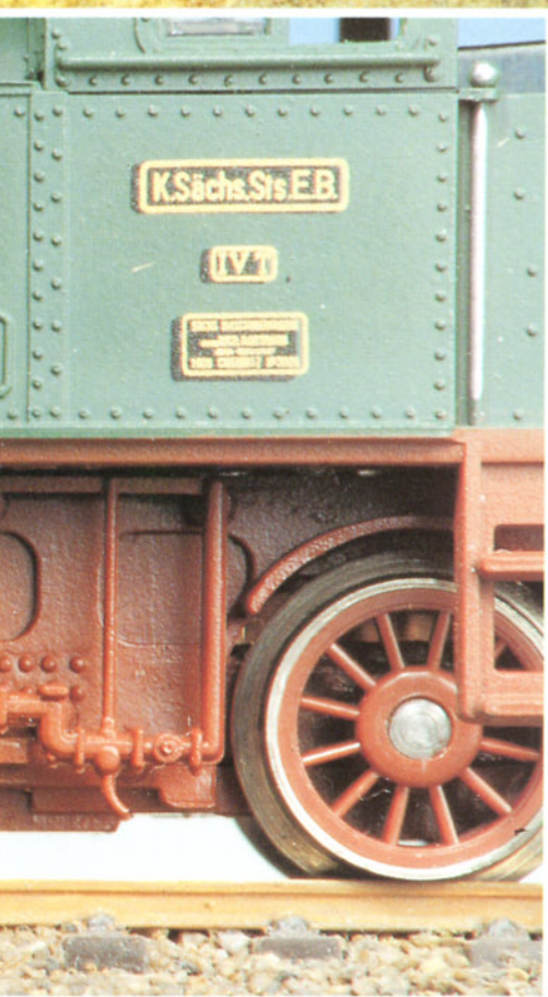
Bild 5: Besonders beachtenswert: die in den Schutzblechen über dem Umlauf vorhandenen filigranen Durchbrüche. Auch ist es gelungen, einen Kolbenstangenabstand von nur knapp 26 mm (exakt müßten es im Maßstab 1:87 24,1 mm sein) zu erreichen. Fotos: K. Heidbreder
