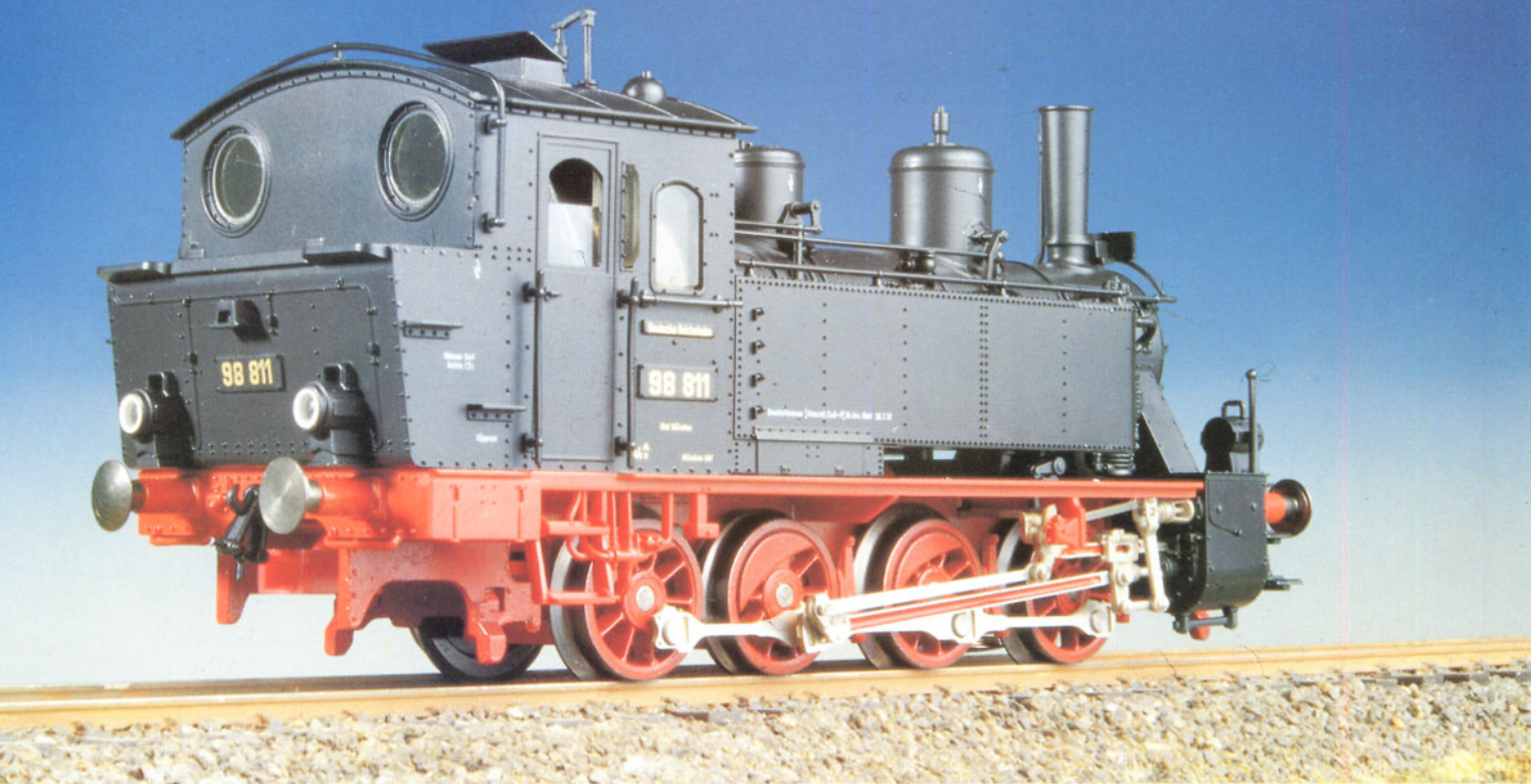
Bild 5: Die erste Bauserie der GtL 4/4 besaß runde Führerhausfenster an der Stirn- und Rückwand. Zur Reichsbahnzeit erhielt sie die kleineren Laternen. Bis Einsatzende behielt sie das Rohr über dem Sicherheitsventil sowie den querliegenden Dachlüfter.
