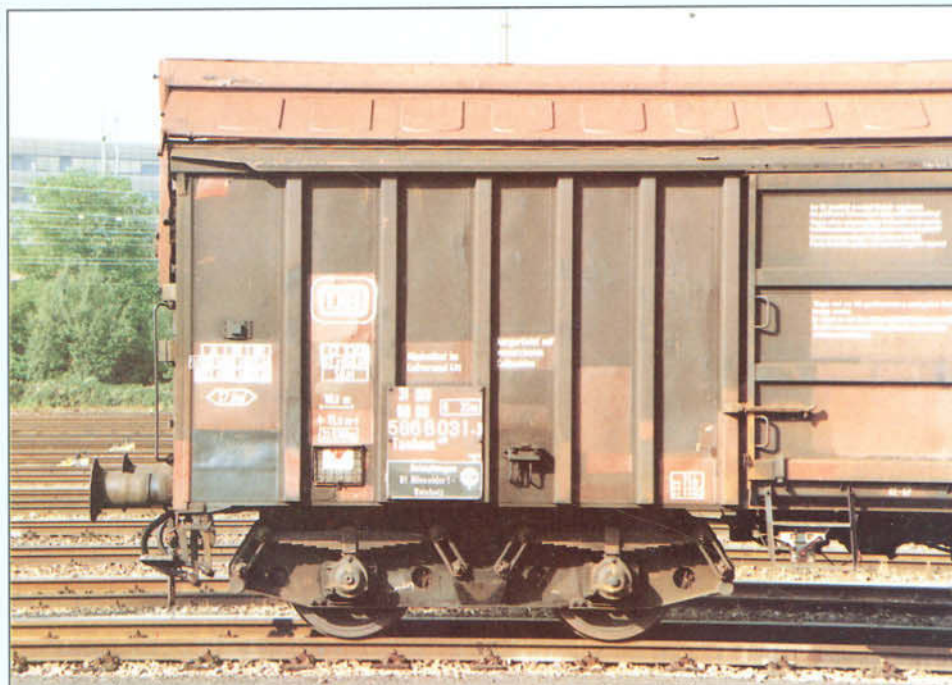
Bild 2: Anchriftentfeld des Taehms 887, der mit versetzbaren Coilmulden ausgerüstet ist.
