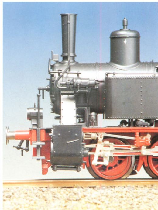
Bild 8: Auch die kleine Schmierpumpe (hinter dem Rauchkammerfuß) wurde nicht vergessen. Fotos: 1 und 3 – 8: K. Heidbreder
