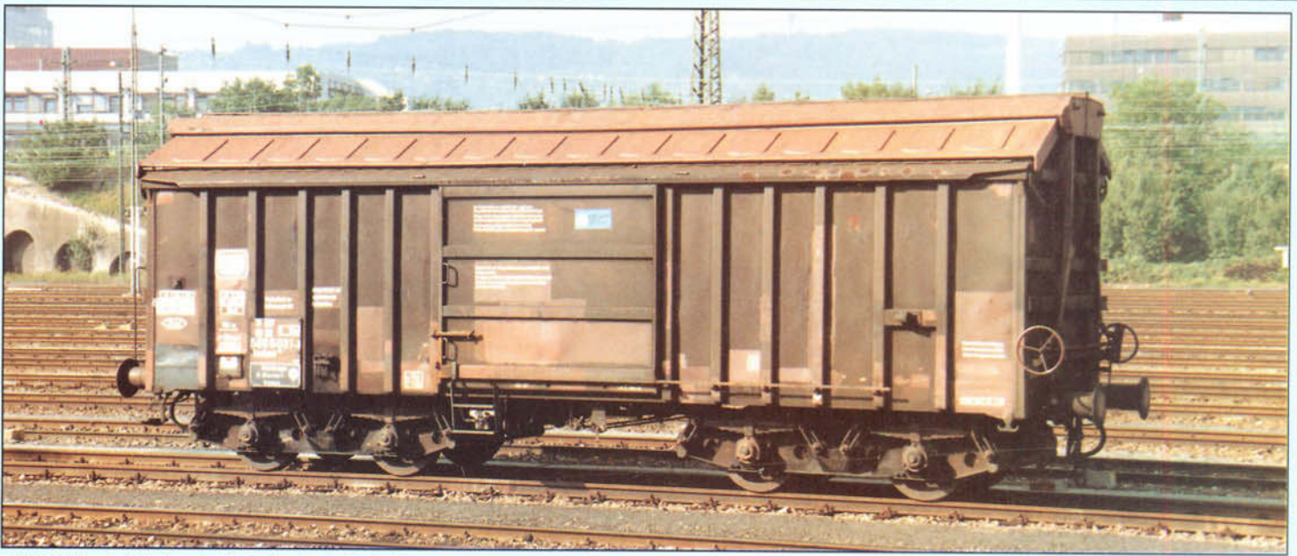
Bild 3: Wie ein Flickenteppich zeigt sich die Seitenwand, während das Dach mit den gesickten Flächen noch wie neu erscheint.
