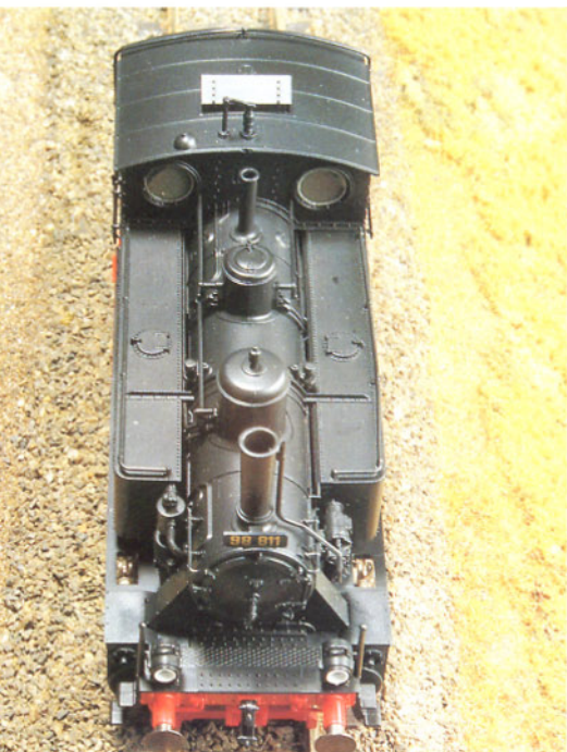
Bild 6: Der Draufblick auf die Maschine läßt die Zierlichkeit der Kesselarmaturen erkennen. Der Dachlüfter ist aufgeklappt.
