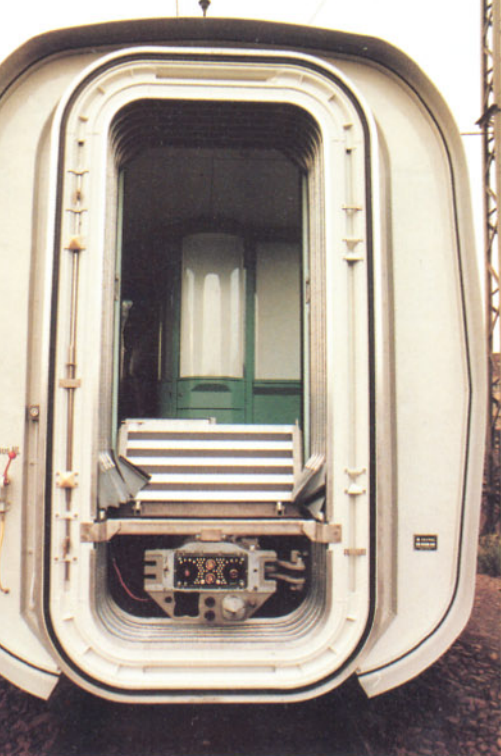
Bild 4: Über die spezielle Lichtwellenleiter-Kupplung berichteten wir schon im EJ 8/90.
