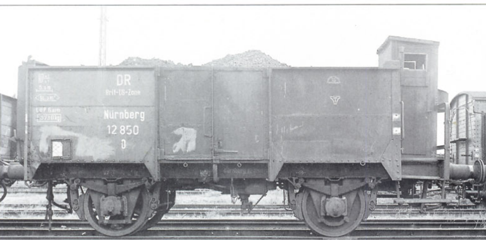
Bild 6: Mit zusätzlichen Versteifungsblechen an den Tür- und Eckrungen sehen wir hier den Kohlenwagen Nürnberg 12850 der Deutschen Reichsbahn (Brit-US-Zone), der nach der Musterzeichnung A 6 des Deutschen Staatsbahnwagenverbandes gebaut wurde. Er besitzt noch sein Bremserhaus und sogar noch einen Radsatz mit Speichenrädern. Das Transitzeichen auf der rechten Seitenwand läßt darauf schließen, daß die Aufnahme vor dem 1. April 1949 entstand. Foto: R. Klitscher, Slg. Geil
