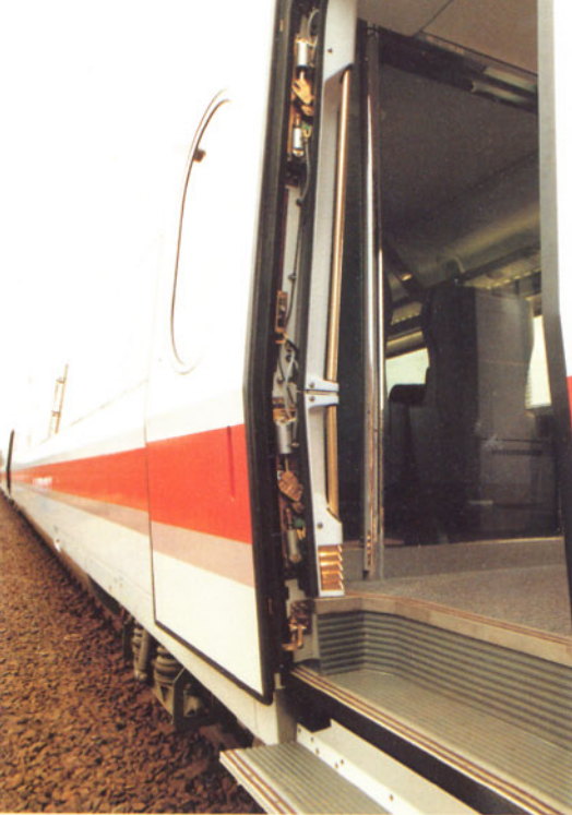
Bild 7: Die neuentwickelten Schwenkschiebetüren werden elektro-pneumatisch betätigt.
