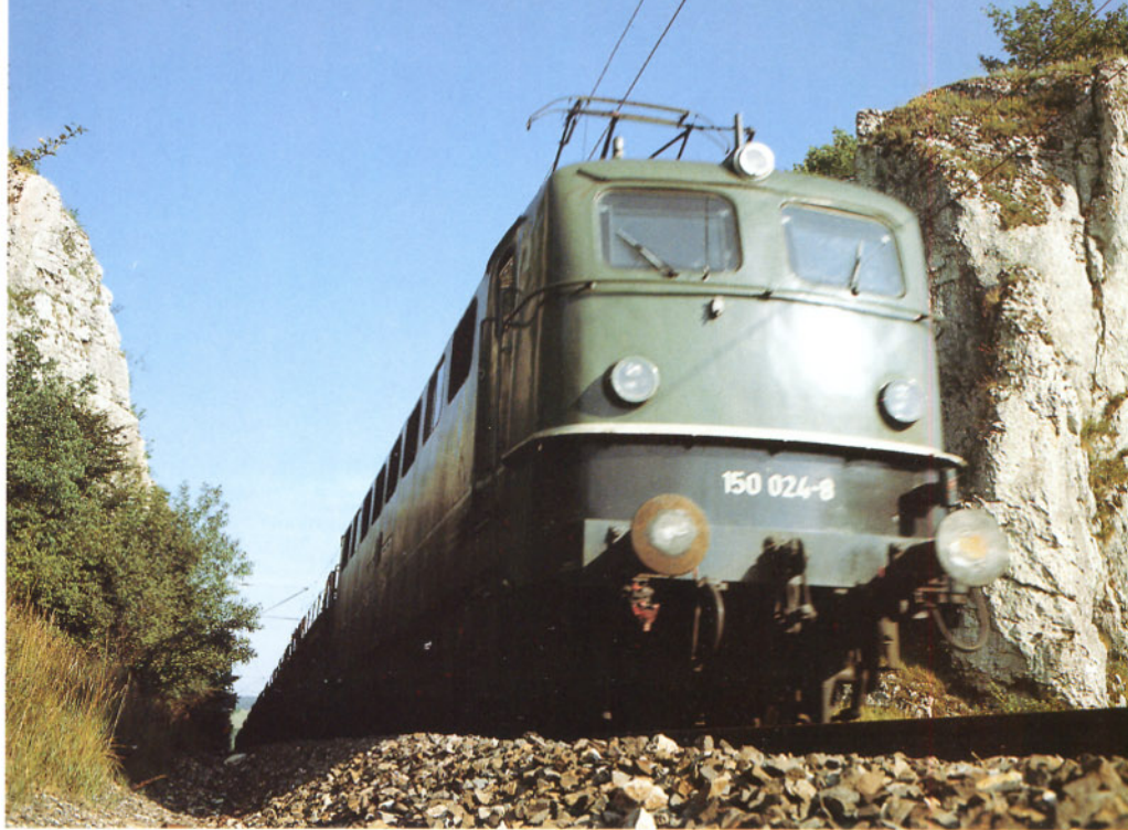
Bild 2: Die ersten 25 Lokomotiven der Baureihe 150 wurden noch mit Tatzlagerantrieben geliefert. Die Aufnahme der 150 024 entstand am 11.07.1979 bei Dollnstein. Foto: W. Matussek, Archiv Ritz
