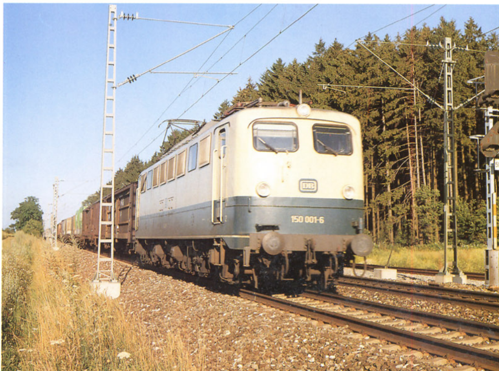
Bild 3: Auch bei der 150 001 übernimmt die Kraftübertragung von den sechs Fahrmotoren zu den Achsen ein Tatzlagerantrieb (aufgenommen am 14.07.1988 bei Nannhofen). Foto A. Ritz
