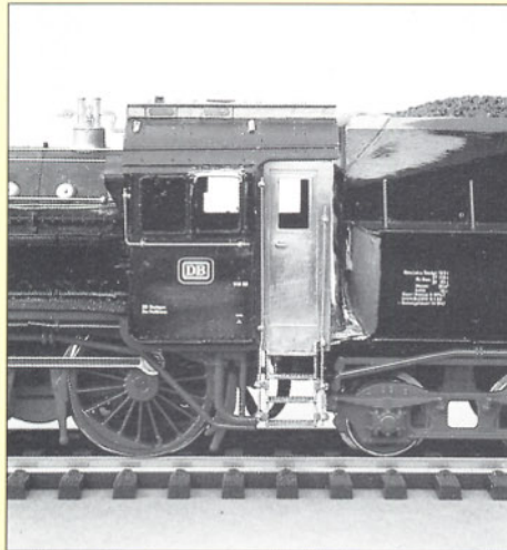
Bilder 6 und 7: Mit dem Umrüstsatz für eine P 8 von Eisenbahn und Modellbau können zwei Versionen für eine Wendezugsteuerung gebaut werden, die sich durch die unterschiedliche Ausführung der Führerhaus-Lüfteraufsätze unterscheiden. Werkfotos Eisenbahn und Modellbau
