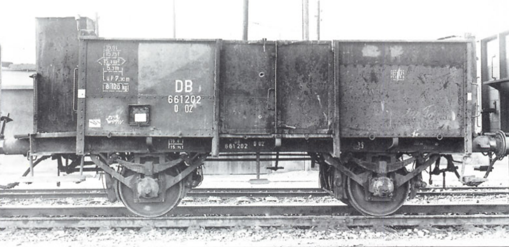
Bild 5: Einen Güterwagen mit Handbremse nach Musterzeichnung Ild 1 der Preußischen Staatseisenbahnen sehen wir auf diesem Foto. Er besitzt die älteren Fachwerk-Achshalter und ist bereits mit den ab 1951 gültigen Anschriften der Deutschen Bundesbahn ("DB, 661 202, O 02") versehen.
