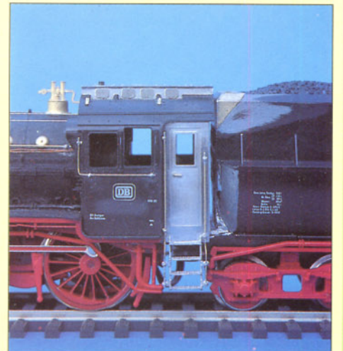
Bilder 6 und 7: Mit dem Umrüstsatz für eine P 8 von Eisenbahn und Modellbau können zwei Versionen für eine Wendezugsteuerung gebaut werden, die sich durch die unterschiedliche Ausführung der Führerhaus-Lüfteraufsätze unterscheiden. Werkfotos Eisenbahn und Modellbau
