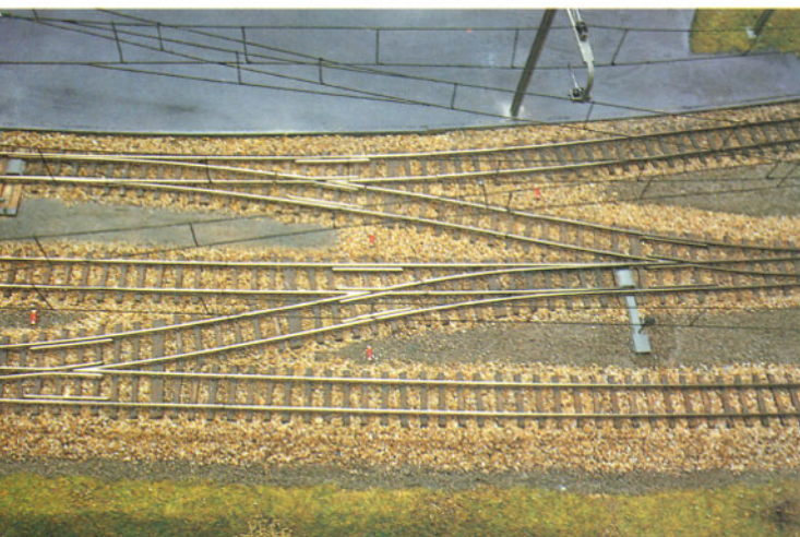
Bild 1: Weichen mit "Grazie" sind hier verlegt. Sie entstanden völlig im Eigenbau. Vor allem die Herzstücke stellen eine Wucht dar.
