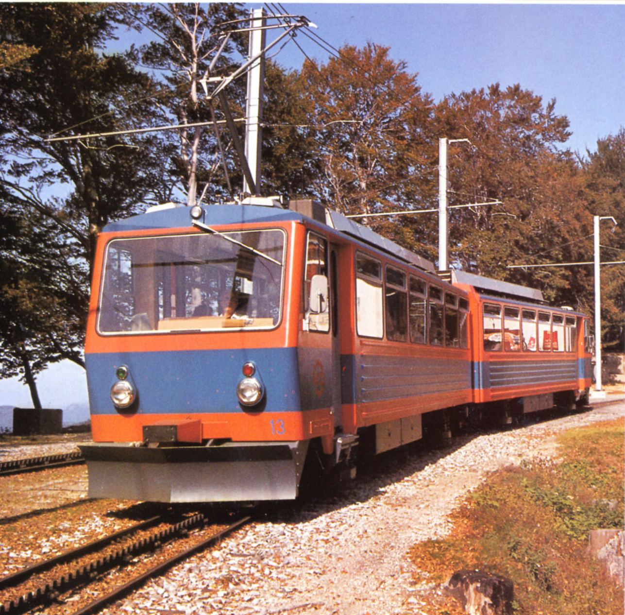
◀ Bild 8: Der Bhe 4/8 Nr. 13, einer der vier 1982 beschafften zweiteiligen Elektrotriebwagen, die heute die Hauptlast des Verkehrs der Zahnradbahn auf den Monte Generoso hinauftragen. Foto: A. Muratori
