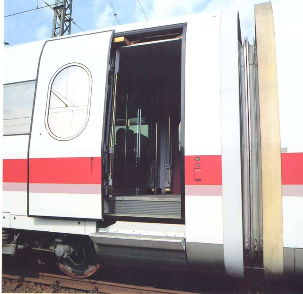
Bild 8: Neue Maßstäbe auch bei der Trittbreite der Stufen. Die untere Stufe ist nur im Stand ausgeklappt.
