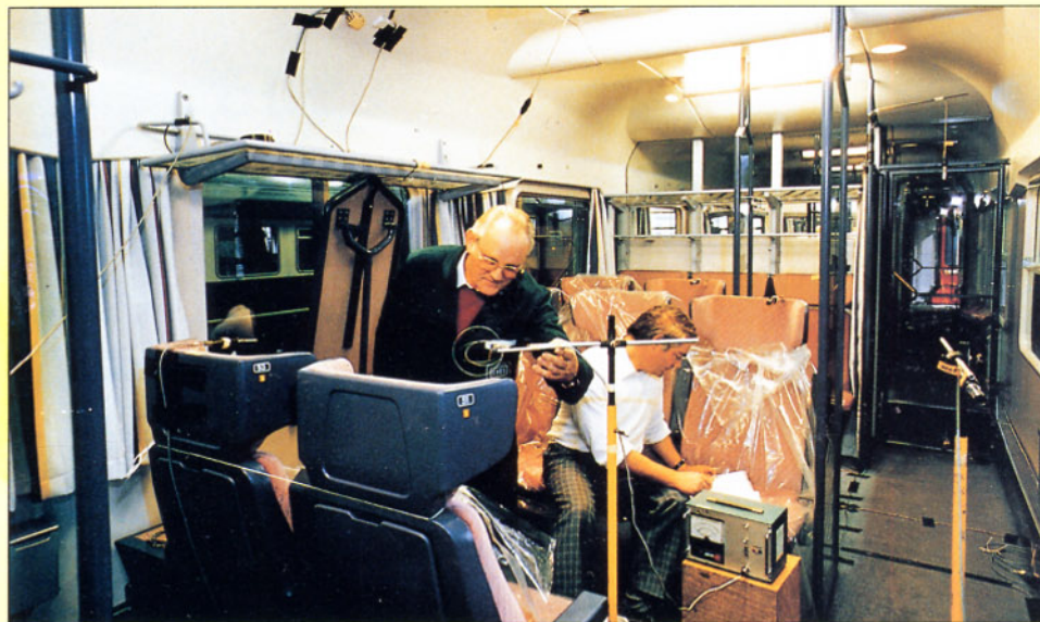
Bild 2: Mitarbeiter der Versuchsanstalt Minden messen in einem Aim 260 Temperaturen und Luftbewegung, um das Raumklima zu optimieren. Foto: DB (Krieger)
