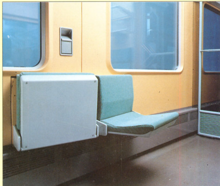
Bild 23: Die in den IR-Wagen nur noch in den Großraumabteilen vorhandene Klapp(not)sitze, hier im Bim 263, sind recht komfortabel. Werkfoto PFA
