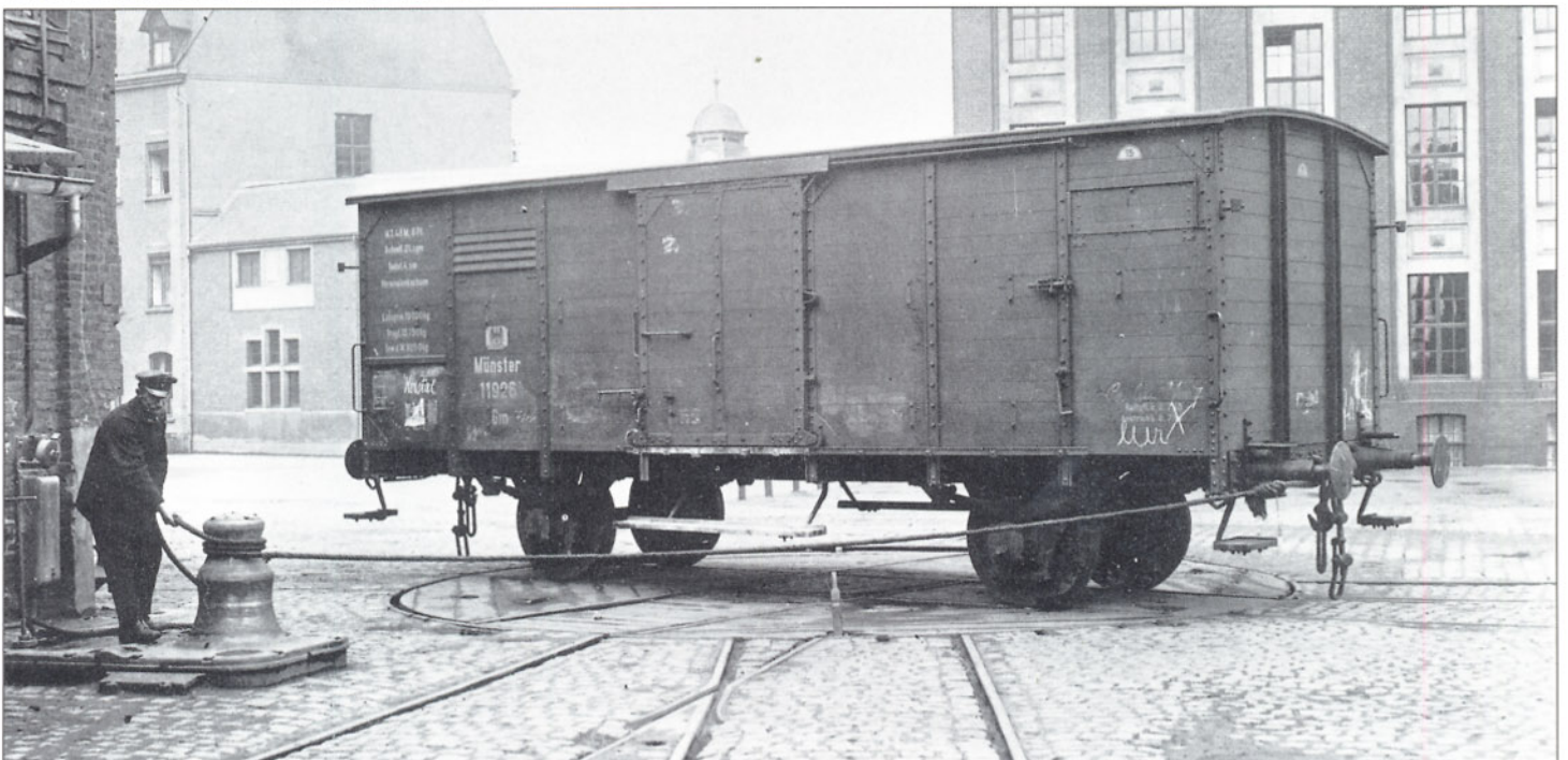
Bild 2: Gedeckter Güterwagen (Verbandsbauart) als Gm-Münster der Kgl. Preußischen Eisenbahnverwaltung (K.P.E.V.). Foto: Archiv der DB (Sammlung Dr. Hufnagel)
