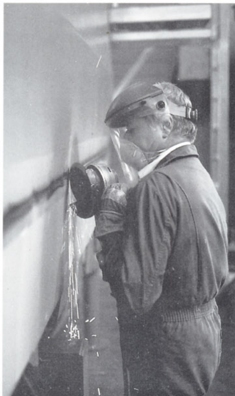
Bilder 7 und 8: Kein ICE ohne die qualifizierte und engagierte Arbeit der Werksangehörigen. Termintreue und ausgezeichnete Qualität sind die Maßstäbe. Wie man sieht, steckt auch in einem solchen High-Tech-Produkt noch sehr viel Handarbeit. Beispielsweise muß (siehe linkes Bild) jede Schweißnaht einzeln auch plangeschliffen werden. Fotos: A. Rjitz
