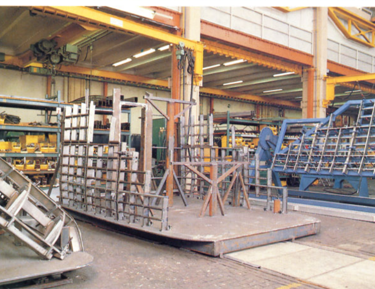
Bild 5: Hier wird noch einmal recht deutlich, wie die Triebkopf-Form langsam aus exakt in die Form gepaßten Stahlprofilen entsteht. Den Konstrukteuren des Triebkopfs ist es gelungen, seine Masse auf sensationelle 8 t zu begrenzen, obwohl sämtliche tragenden Teile aus Stahl bestehen. Foto: Krauss-Maffei Verkehrstechnik GmbH
