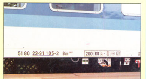
Bild 29: Anschriftenfeld des 51 80 22-91 105-2 (Bim 263.1). Foto: D. Perner
