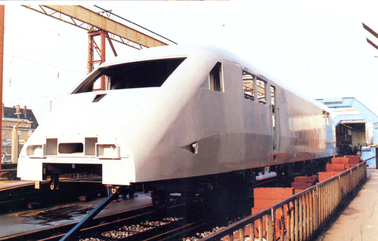
Bild 6: Ein wichtiges Detail, das später geschickt mit dem roten Streifen "getarnt" ist, kann man hier noch ganz deutlich erkennen – die Lufteintrittsöffnung im vorderen seitlichen Teil, unter dem Führerstandsfenster. Sie spielt eine große Rolle für die innere Aerodynamik. Mehr dazu lesen Sie im Text. Foto: Krauss-Maffei Verkehrstechnik GmbH
