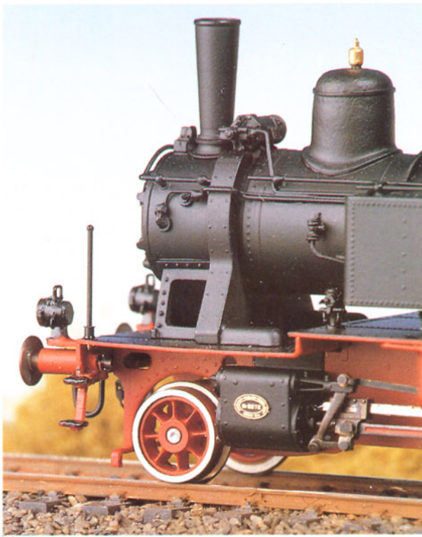
Bild 7: Geätzt und brüniert sind sämtliche Steuerungsteile.
