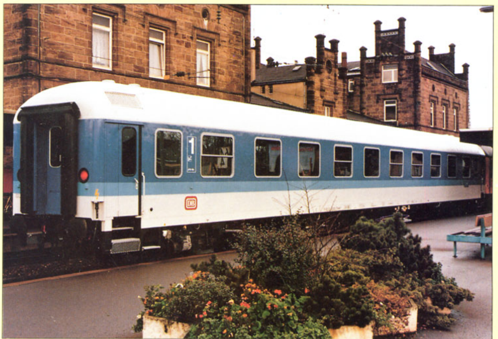
Bild 27: Die rechte Wagenseite eines Aim 260 (vgl. auch Bild 3). Im Dachbereich am Wagenende 2 ist die Ansaugöffnung der Zwangsbelüftungsanlage zu erkennen. Foto: DB (Krieger)
