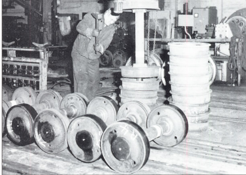
Bild 11: Bevor die Radsätze neu bereift werden können, müssen die abgefahrenen Radreifen entfernt werden. Die Radreifen werden mit Gasflammen erwärmt und von den Radsternen abgeschlagen.
