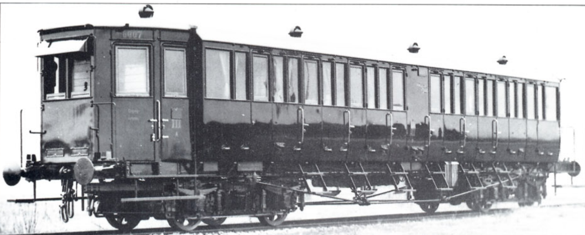
Bild 20: Der 1903 in Dienst gestellte Akku-triebwagen 6607 erfüllte die in ihn gesetzten Erwartungen nicht und wurde nach nur zwei Jahren abgestellt. Foto: Sammlung Dr. Scheingraber
