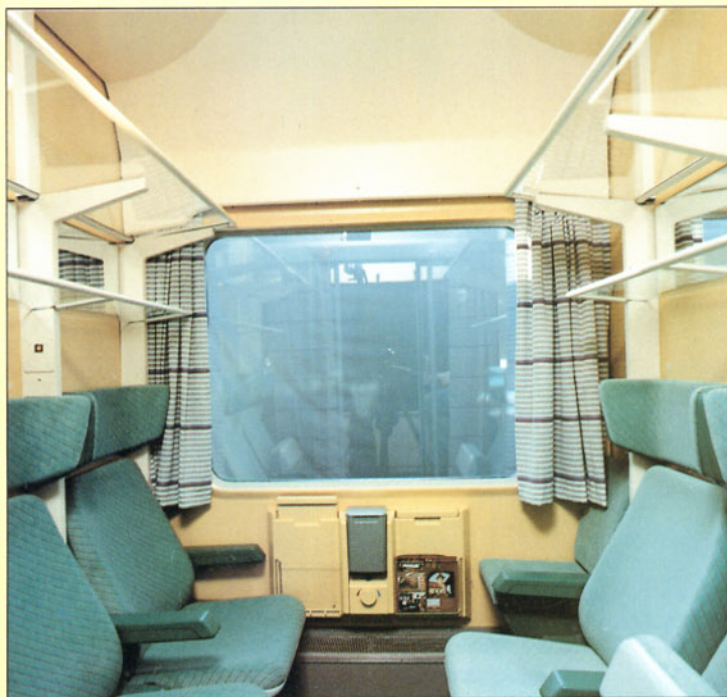
Bild 20: Jedes Fünf-Platz-Abteil weist zusätzlich einen Kindersitz am Fenster auf (Bim 263). Werkfoto PFA
