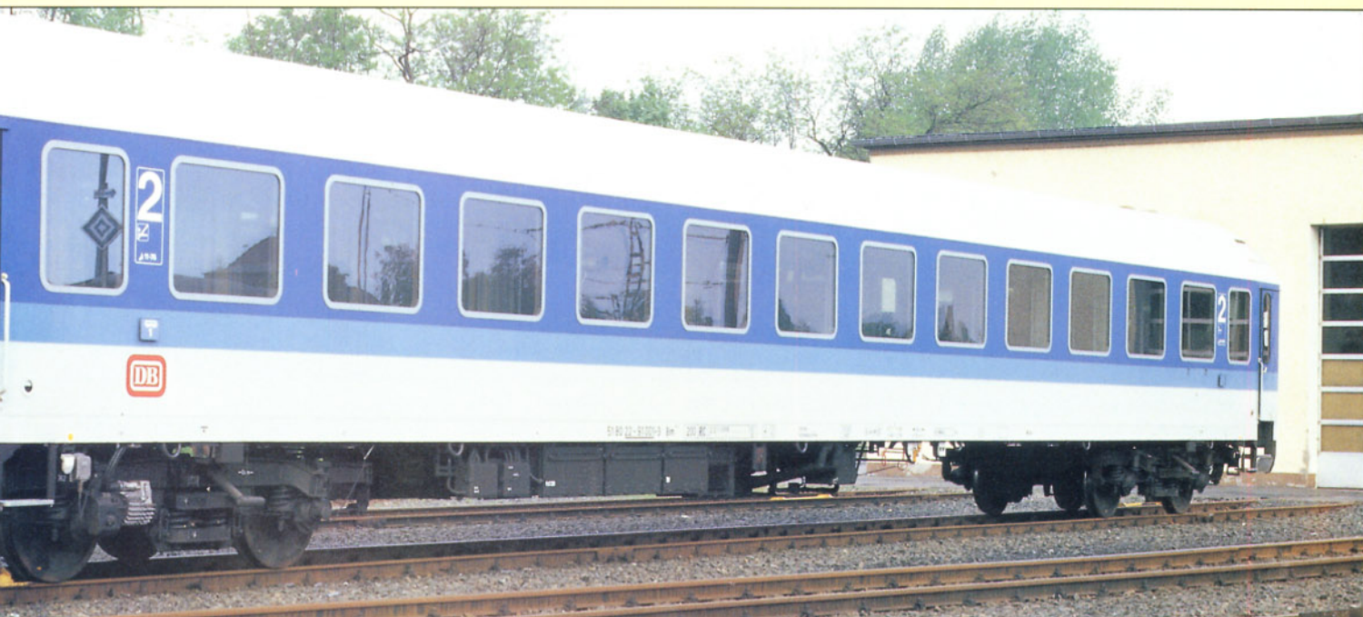
Bild 1: Bei dem Bim 263 mit der Wagennummer 51 80 22-91 001-3 handelt es sich um das erste Vorserienfahrzeug der InterRegio-Wagen 2. Klasse.
