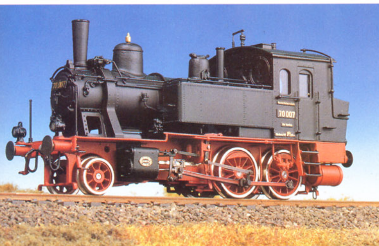
Bild 7: Geätzt und brüniert sind sämtliche Steuerungsteile.
