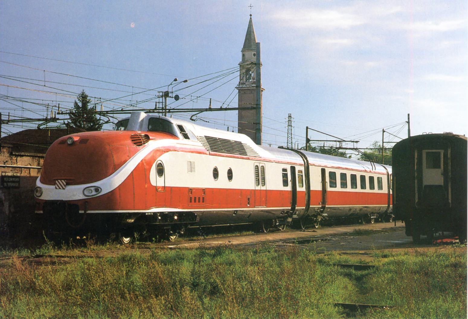
Bild 1: Die Triebköpfe mit dem charakteristischen Gesicht erhielten in Italien nicht nur eine neue Lackierung, sondern auch Austauschmotoren aus dem Bestand des DB-Ausbesserungswerkes Nürnberg. Mitarbeiter des AW unterstützten die Umbauarbeiten vor Ort.
