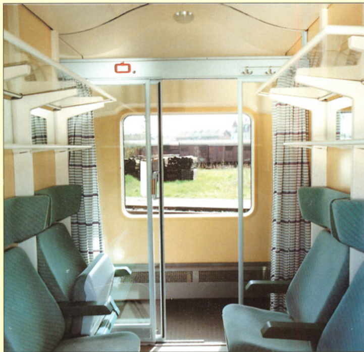
Bild 21: Im Bim 263 sind die an der Gangseite angeordneten Sitze hochklappbar. Jedes Abteil verfügt über eine Garderobe (rechts). Werkfoto PFA
