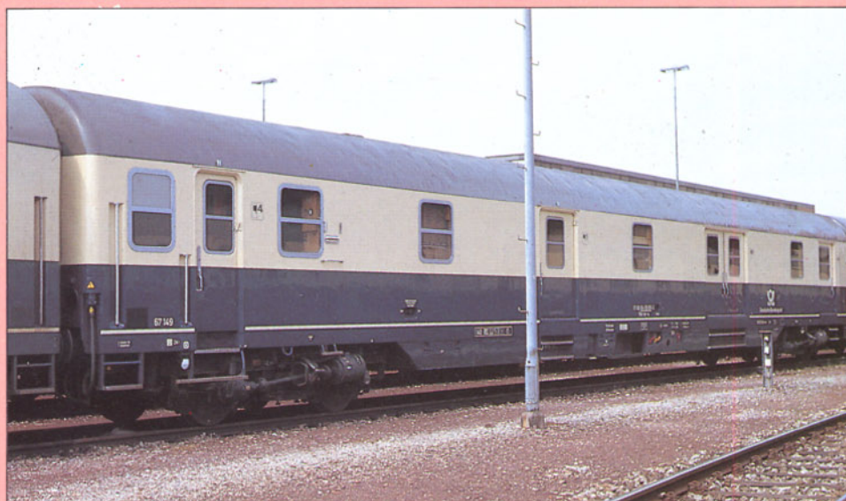
Bild 14: Der Post mrz 73 190 dagegen verfügt über schlingergedämpfte Drehgestelle und ist für eine Höchstgeschwindigkeit von 200 km/h zugelassen. Postintern werden diese Wagen als "Schnellläufer" bezeichnet. Alle Fotos (soweit nicht anders angegeben): Dr. Scheingraber
