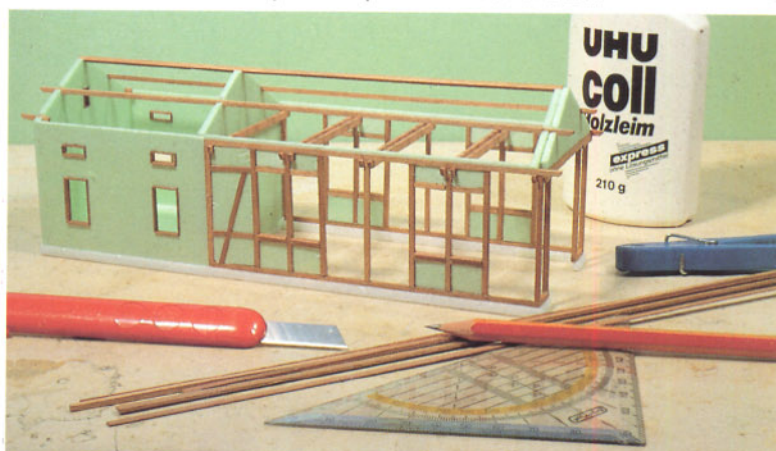
Bilder 4 bis 6: Die vorgefertigten Wandteile werden Schritt für Schritt miteinander verklebt. Sind die Dachlängsträger eingezogen, kann man schon ans Richtfest denken.
