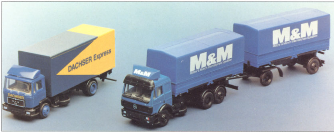
Herpas MAN M 90 "Dachser" mit der neu entwickelten Ladebordwand Dautel sowie ein MB-Hängerzug mit kippbarem SK-Fahrerhaus (Version mit Schlafkabine).
