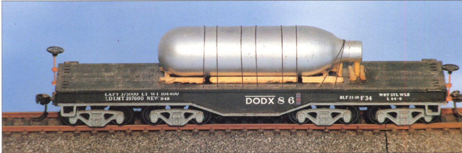
Bild 1: Der fertig beladene Waggon. Als Auflage dienen Holzleistchen; die Verspannung wird aus Nährgarn gefertigt.
