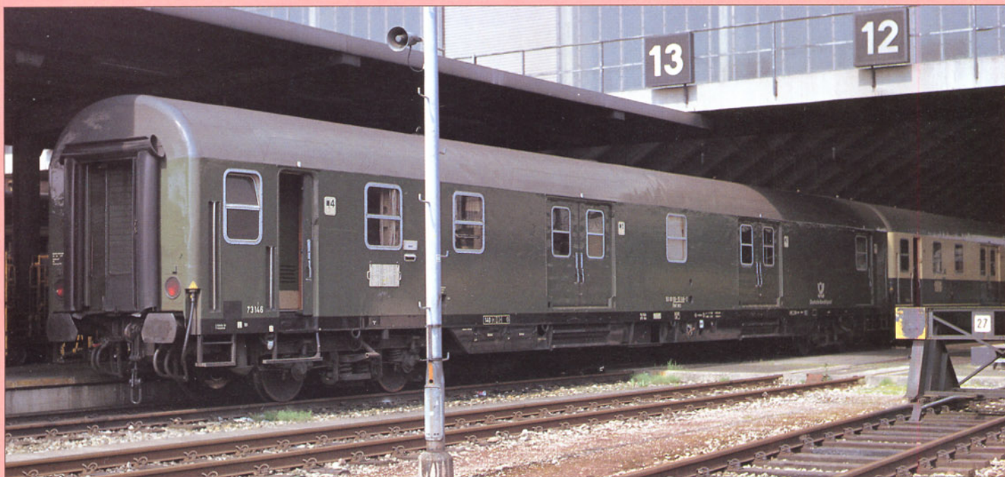
Bild 12: Der Post mrz 73 146 ist für 140 km/h zugelassen. Seit der Einführung von computer-gerechten zwölfstelligen Kennnummern bei der Deutschen Bundesbahn verfügen die Wagen der Deutschen Bundespost über zwei unterschiedliche Wagennummern – eine der Bundesbahn und eine zweite der Bundespost. Die Wagennummer der Post setzt sich aus den beiden letzten Ziffern des Baujahrs sowie der laufenden Seriennummer zusammen. Der 73 146 ist also der 146. Wagen der Postwagen-Serie aus dem Jahre 1973. Foto vom 23. Mai 1990.
