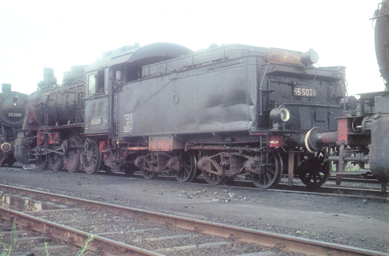
Bild 12: Ein seltener Anblick: Die 55 5039 des Bw Duisburg-Wedau war im Juni 1962 mit einem Tender der preußischen Bauart 2'2' T 21,5 gekuppelt. Foto: K.-H. Bebensee
