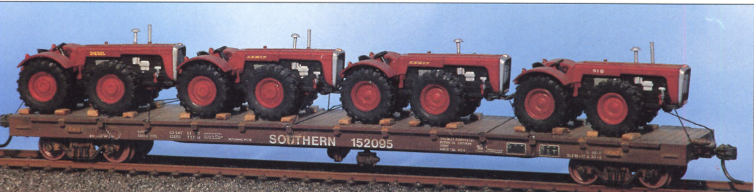
Bild 1: Die vier Traktoren vom Typ TK 4 D wurden mittels Holzleisten und Spanndrähten vorbildgerecht für den Schienentransport vorbereitet.
