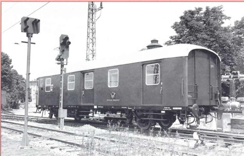
Bild 7: Zweiachsiger Allsbahnpostwagen in Stahlleichtbauweise mit 14,5 m Kastenlänge, Baujahr 1953.
