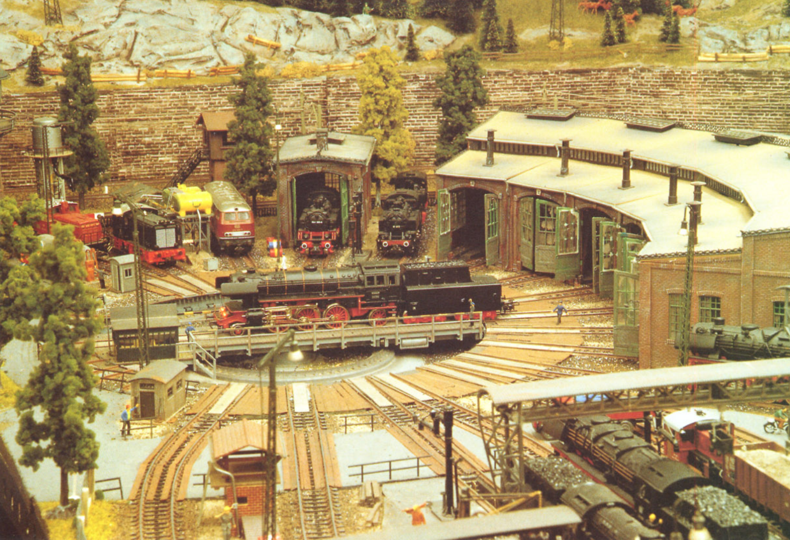
Bild 7: Der zentrale Punkt fast aller Bahnbetriebswerke: die Drehscheibe. Klar erkennbar ist der Typ des Bw: ein Bw für Dampf- und Diesellokbetrieb, warten doch auf den Aufstellgleisen Lokomotiven aller drei Traktionsarten.
