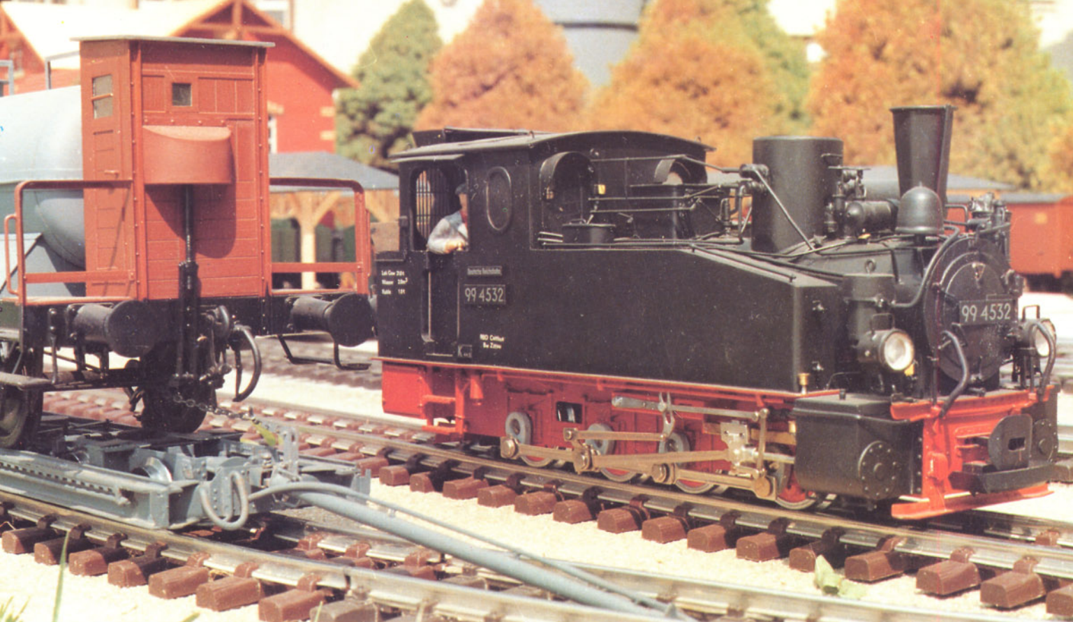
Bild 7: Die Eigenbaulokomotive 99 4532 entstand aus einem LGB-Fahrwerk sowie Messing und Polystyrol in Gemischtbauweise. Im Vordergrund links einer der sächsischen Rollwagen, der ebenfalls in völligem Eigenbau entstand.
