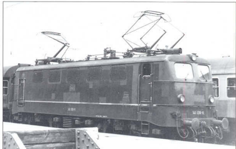
Bild 19: Erprobungsträger für neuentwickelte Stromabnehmer war zur Jahresmitte 1971 die 141016. Besondere Beachtung verdient der Einholmstromabnehmer (München Hbf, 18. Juli 1971). Foto: Dr. Scheingraber
