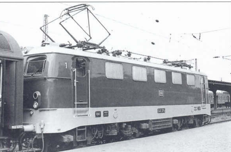
Bild 18: Der Rahmen der E41374 (Baujahr 1965) war probeweise beige gelb gespritzt. Mit dem D5 steht sie am 9. August 1965 am Bahnsteig in Bebra. Foto: Dr. Scheingraber
