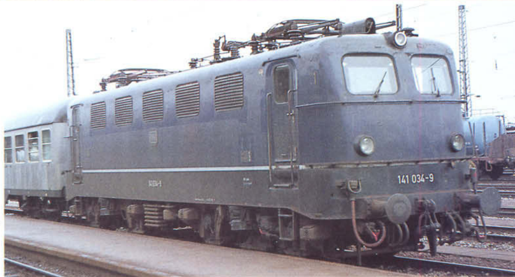
Bild 13: Nur eine der blaulackierten E41 behielt nach Entfernung der rundumlaufenden Regenrinne ihre alte Farbgebung: die E41034. Die blaue Farbe wurde bei ihr deshalb bis zum Dachspiegel hochgezogen (aufgenommen im November 1973 in Ingolstadt Hbf). Foto: W. Matussek, Archiv Ritz
