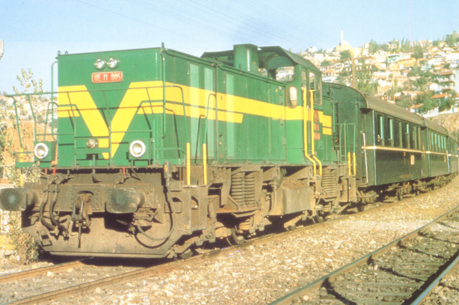
Bild 5: Krauss-Maffei-Lokomotiven in der Türkei: Von der TCDD-Baureihe 1100 wurden 15 in München und 35 in Eskisehir/Türkei in Lizenz gefertigt; weitere 35 sind dort zur Zeit in Bau. Foto: Krauss-Maffei
