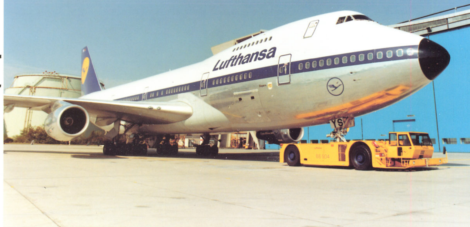
Bild 6: Das Flughafenschleppsystem PTS in voller Aktion beim Schleppen eines Jumbos. Das System kann erheblich zur Wirtschaftlichkeit auf den Flughäfen beitragen und außerdem die Lärm- und Abgasemission drastisch reduzieren. Foto: Krauss-Maffei
