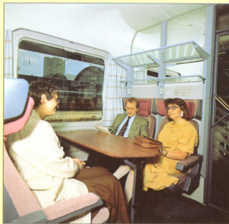
Bild 11: Auch das Großabteil der 1. Wagenklasse mit seinen 10 Plätzen weist feste Tische auf. Foto: DB
