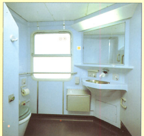
Bild 12: Im Vergleich zu den bisherigen Toiletten im ABm 225 mehr als doppelt so groß ist die behindertengerechte Toilette im ARbuimz 262 am Wagenende 2. Foto: DB
