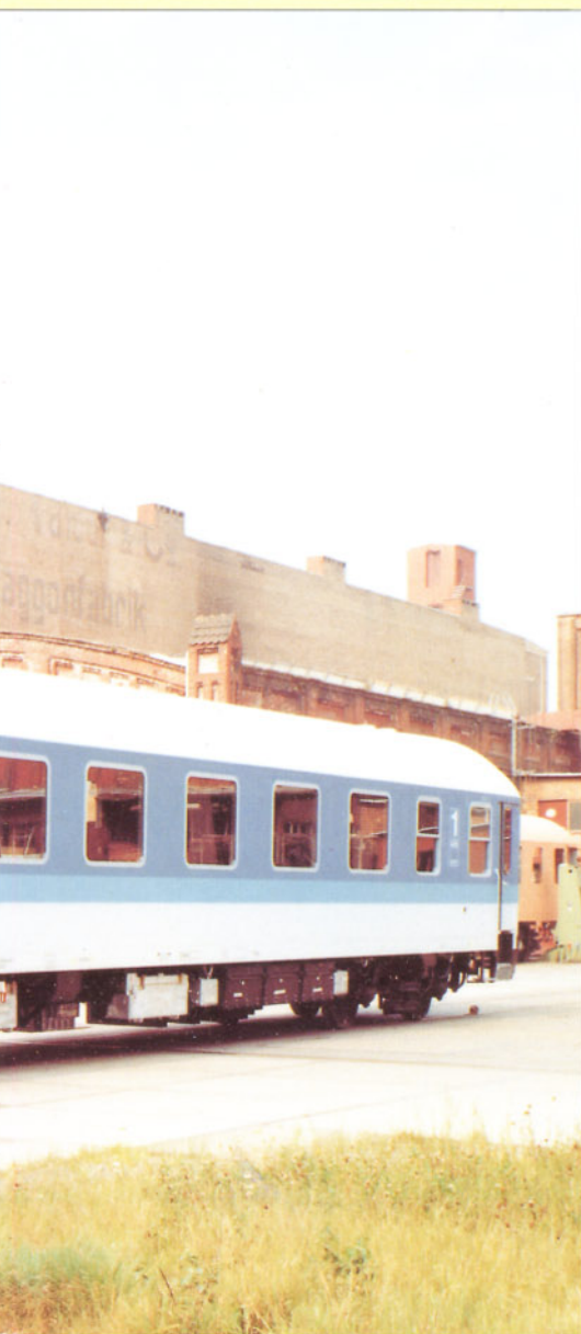
Bild 1: Bereit zur Ablieferung an die Deutsche Bundesbahn steht im Werkhof der Firma TALBOT in Aachen der ARbuimz 262.0 mit der Wagennummer 50 80 85-94 003-0 (später umgezeichnet in 518085-94003). Es handelt sich um den zweiten von TALBOT fertiggestellten Sitzwagen 1. Klasse mit Küche und Speiseraum für den InterRegio-Verkehr. Werkfoto TALBOT
