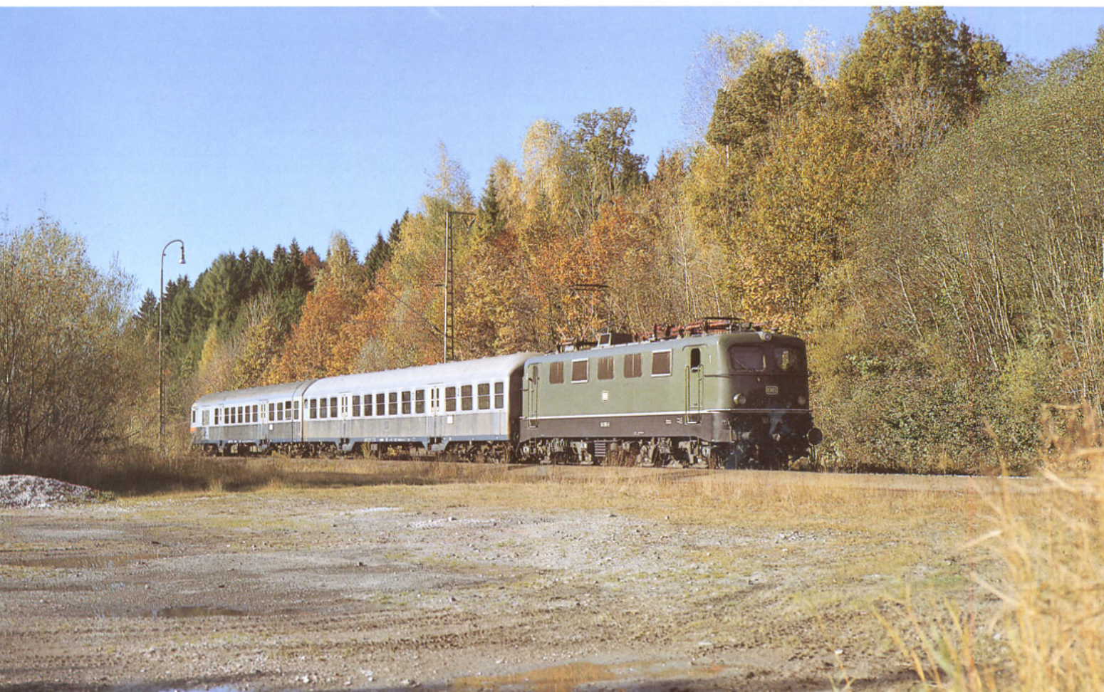
Bild 21: Auf den ersten Blick ist an der 141 016, die am 7. November 1987 in Grafenaschau im Bild festgehalten wurde, keine Besonderheit zu erkennen. Erst bei genauerer Betrachtung fällt auf, daß sie in der rechten Seitenwand statt der ursprünglichen Lüftergitter mit waagrecht ausgeführten Lamellen (vgl. auch Bild 19) nun drei Lüftergitter mit senkrecht angeordneten Lamellen sowie zwei der neuen eckigen Lüfter Bauart Klatte aufweist. Foto: A. Ritz
