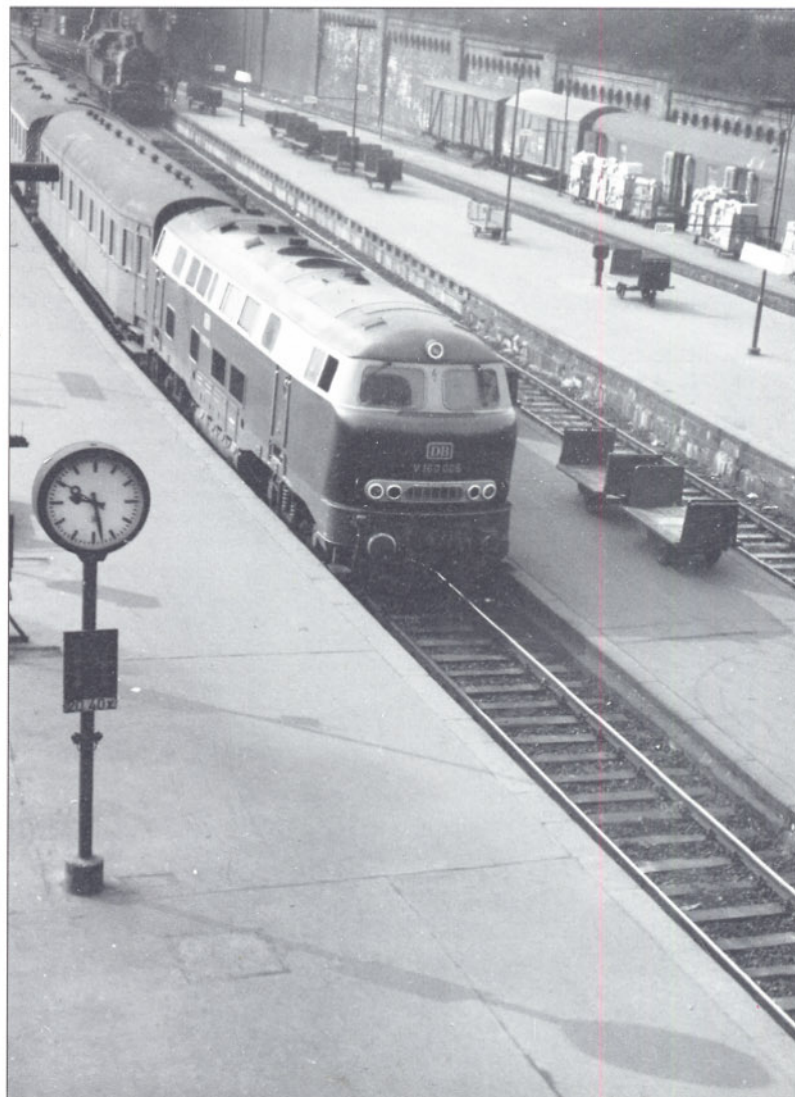
Bild 5: Am 31. August 1964, als die V 160 005 den E 820 von Lübeck nach Hamburg beförderte, war die Zahl der Lüftergitter in der unteren Reihe bereits auf vier in der rechten Seitenwand und fünf in der linken erhöht worden.
