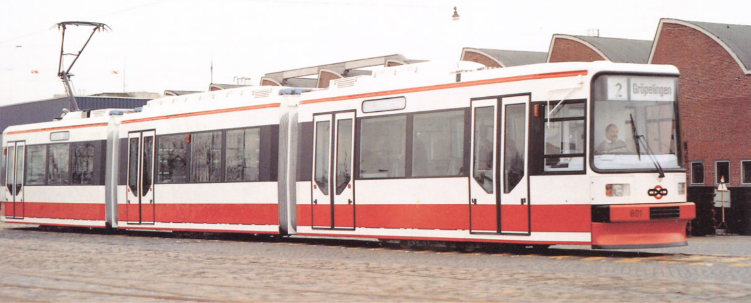
Bild 1: Der erste Niederflur-Gelenk-Stadtbahnwagen der Welt mit durchgängig niedrigem Wagenboden und vollkommen neuem Antriebskonzept präsentierte sich am 9. Februar 1990 in Bremen erstmals der Öffentlichkeit. Foto: Bremer Straßenbahn AG
