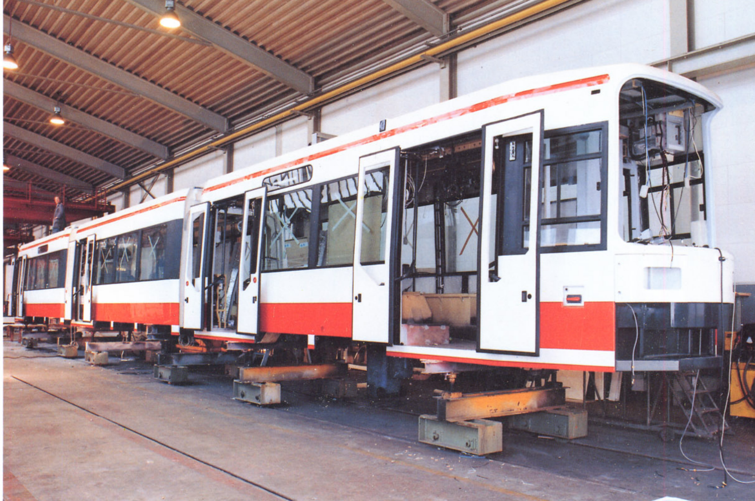
Bild 9: Der neue Niederflur-Gelenkwagen GT 6 N in der Entstehung. Hier ist noch einmal deutlich zu erkennen, daß die Einstiege außergewöhnlich breit sind und alle im nichteingezogenen Bereich des Fahrzeugs liegen. Foto: MAN
