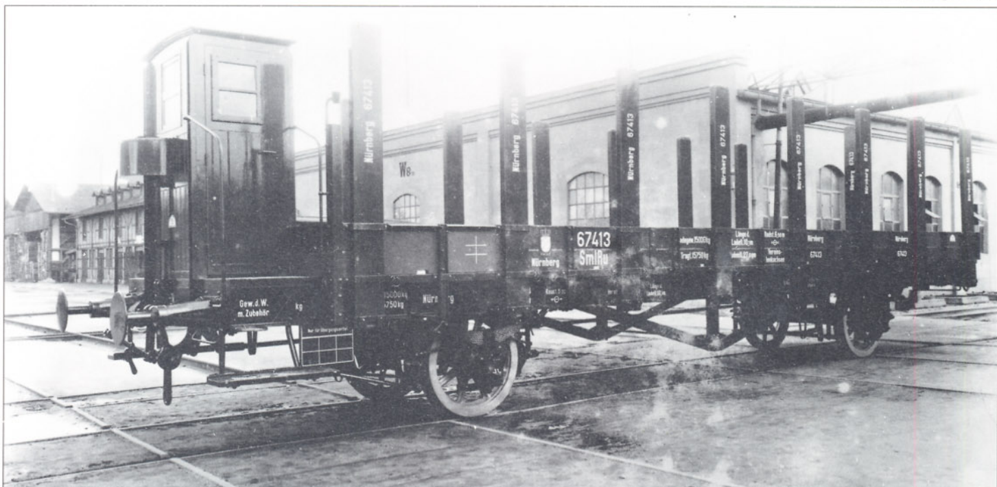
Bild 2: Der Rungenwagen Nürnberg 67413 wurde 1910 von MAN an die Königlich Bayerischen Staatseisenbahnen abgeliefert. Er entspricht Blatt 351 des bayerischen Wagenverzeichnisses und weist bereits die wesentlichen Bauartmerkmale des Rungenwagens der Verbandsbauart nach Musterzeichnung A 4 auf. Wichtiger Unterschied: das bayerische Bremserhaus sowie das Fehlen des unteren Langrahmens zur Aufnahme der Rungentaschen. Werkfoto MAN, Sammlung Diener
