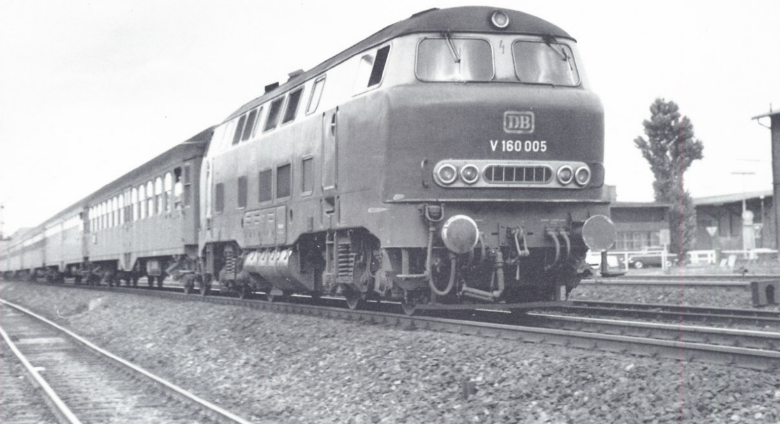
Bild 5: Am 31. August 1964, als die V 160 005 den E 820 von Lübeck nach Hamburg beförderte, war die Zahl der Lüftergitter in der unteren Reihe bereits auf vier in der rechten Seitenwand und fünf in der linken erhöht worden.
