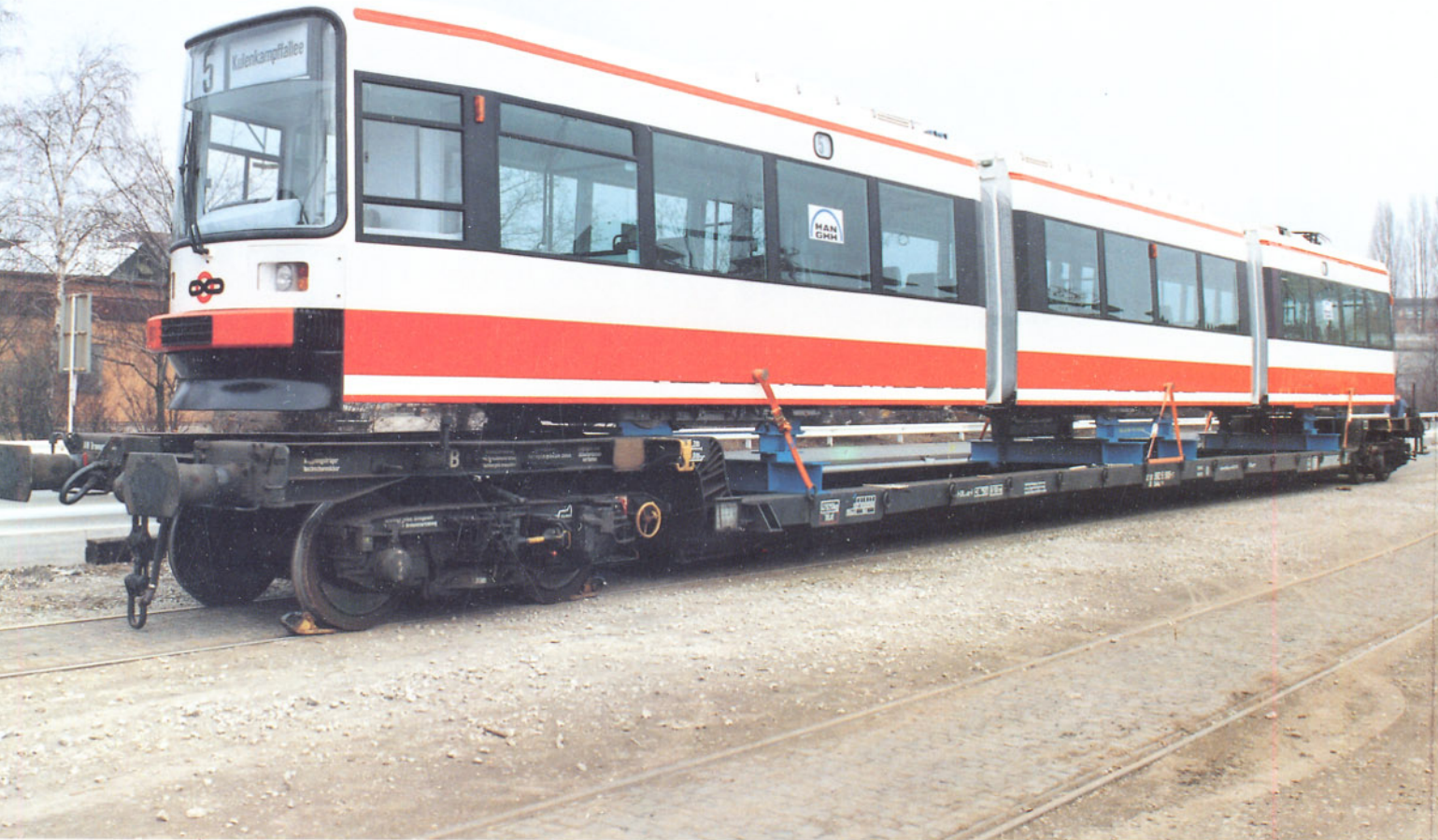
Bild 6: Vom Werksgelände der MAN GHH in Nürnberg bis zu ihrem Einsatzort Bremen fuhr die Straßenbahn mit der Bundesbahn – auf einem vierachsigen Tiefladewagen (992.6900). Foto: MAN GHH
