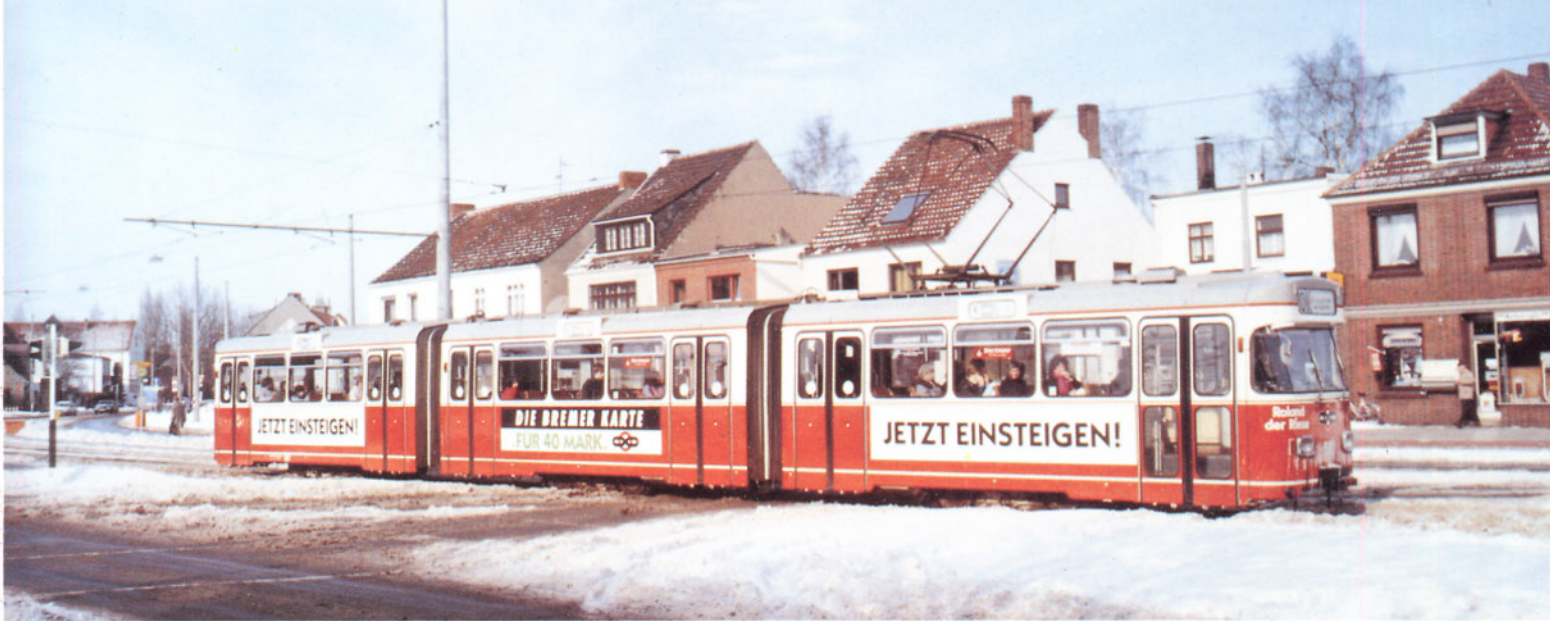
Bild 3: Das jetzt serienmäßige Gelenksteuerprinzip wurde u. a. bei dieser Bremer Straßenbahn mit dem markanten Namen "Roland der Riese" erprobt. Foto: T. Kellner
