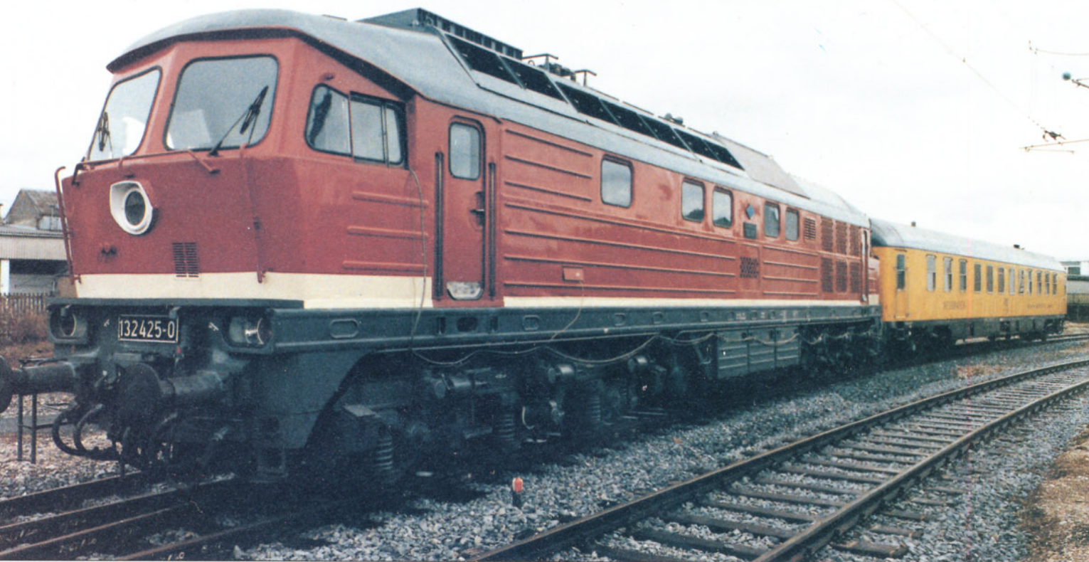
Bild 1: Die "Taiga-Trommel" 132 425 mit dem Meßwagen der Bundesbahn-Versuchsanstalt in München-Freimann. Werden die Lokomotiven dieser Baureihe InterRegios befördern können? Foto: DB (F. Schneider)
