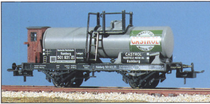
Bild 55: Bemerkenswert an diesem neuen H0-Kesselwagen-Oldtimer von Trix sind der niedrige Kesselmittelpunkt und der kleine Kesseldurchmesser.
