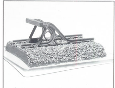
Bild 84: Länderbahnausführung eines Preilbocks, wie er heute noch zuweilen auf Nebenbahnen zu finden ist.
