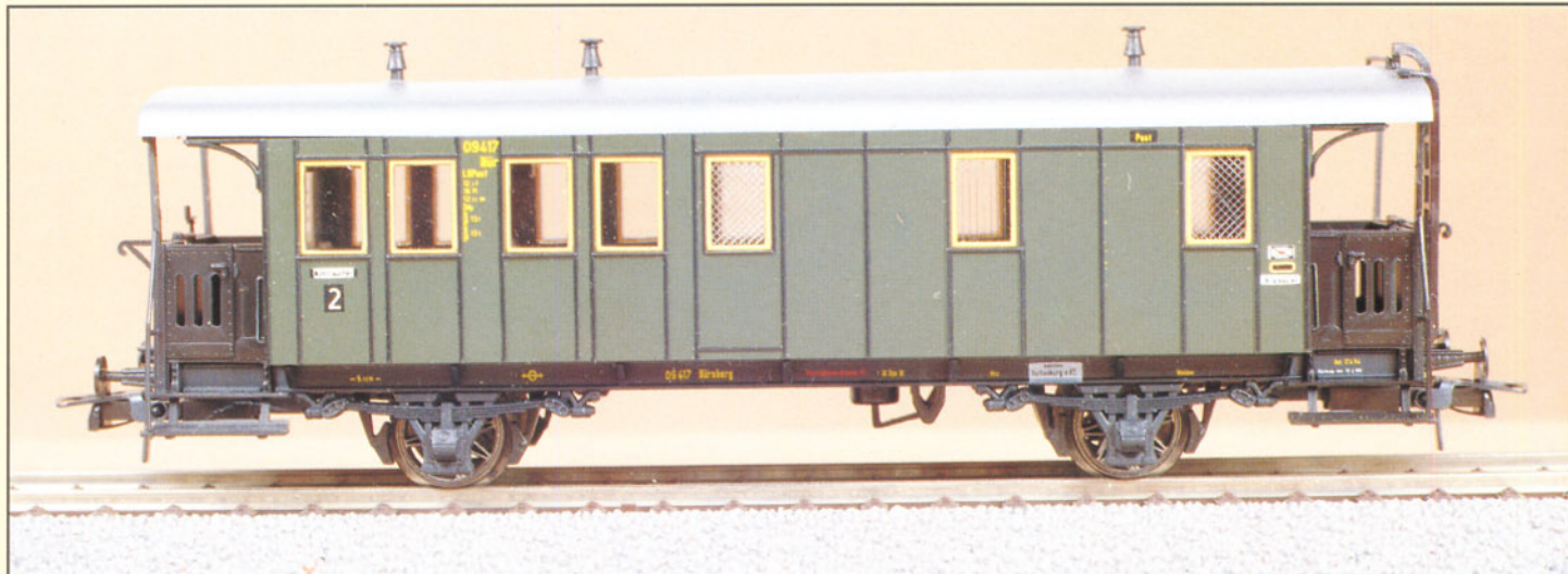
Bild 1: Der Wagen 09417 Nür, ein ehemaliger BPostL Bay 01. Dem Vorbild entsprechend wurden die Fenster des Postabteils vergittert.
