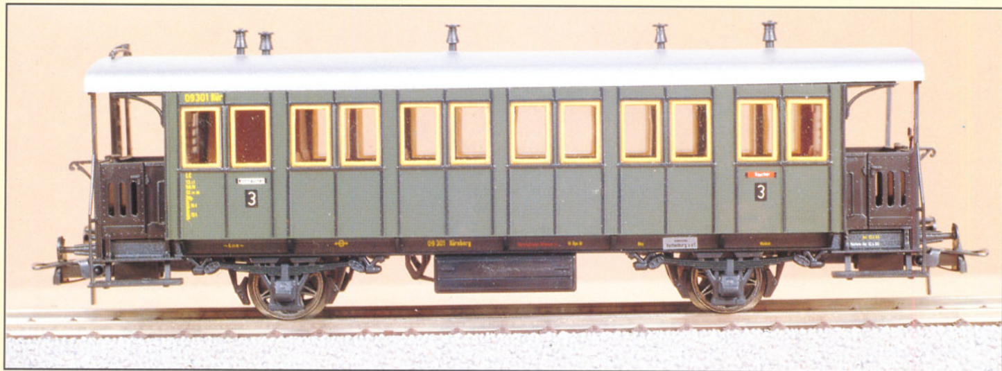
Bild 3: Über sechs Doppelfenster verfügt der Wagen 09301 Nür, ein ehemaliger CL Bay 02a. Die Bühnen sind mit Drehtüren abgeschlossen.
