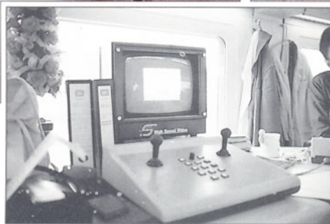
Bild 4: Mit einer auf dem Dach montierten Hochgeschwindigkeitskamera wird der Stromabnehmer aufgenommen und kann über Monitor während der ganzen Fahrt beobachtet werden.
