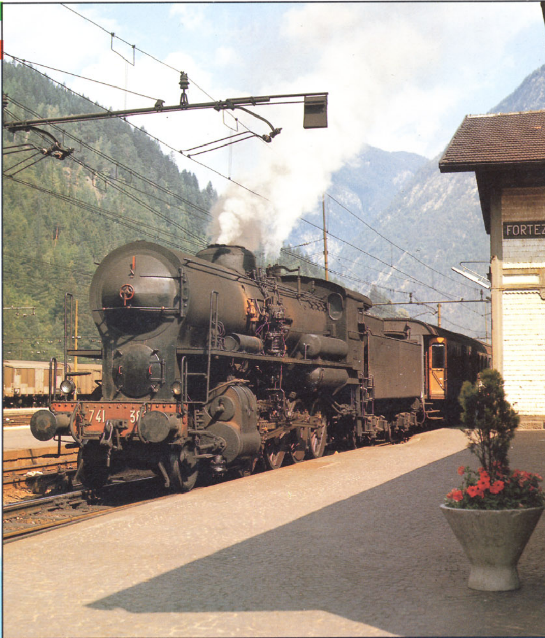
Bild 3: Anfang der fünfziger Jahre gelang es, den Aufbau des Franco-Crosti-Vorwärmers zu vereinfachen. Der neue, wesentlich leichtere Vorwärmer wurde zunächst bei der 740 433 erprobt. Ab 1958 wurden weitere 80 Lokomotiven der Gruppe 740 mit dem neuen Einkörper-Vorwärmer ausgerüstet und als Gruppe 741 bezeichnet. Eine dieser Maschinen, die 741 388, steht am 14.07.1974 in Franzensfeste mit einem Personenzug nach Innichen zur Abfahrt bereit. Foto: U. Geum
