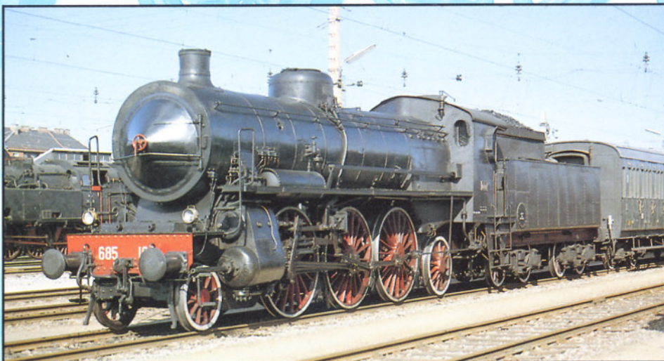
Bild 4: Die 1C1-Dampflokomotiven der Reihe 685 wurden in Italien "Die Königin" genannt. Foto: P. Casini
