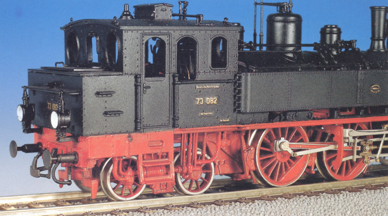
Bild 2: Die Räder des Nachlaufdrehegestells stammen vom Vorlaufdrehegestell einer badischen IV h von Liliput. Neu ist auch die Ätzbeschriftung. Foto: P. Schiebel
