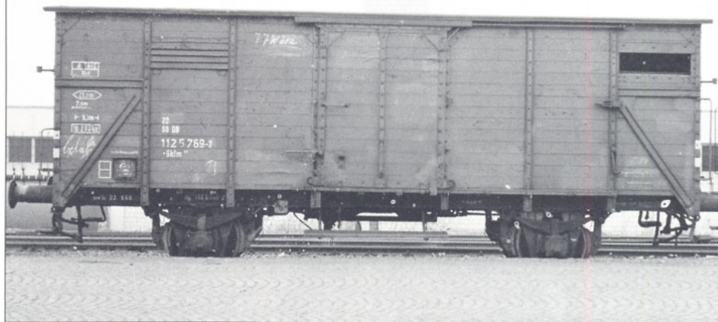
Bild 7: Als Gklm 191 hier schließlich der Wagen mit der UIC-Nummer 20 80 112 5 769-7 im Jahre 1969. Er hat inzwischen seine internationale Verwendungsfähigkeit und damit sein RIV-Zeichen eingebüßt (d. h. er entspricht nicht mehr den RIV-Bestimmungen und darf deshalb nicht mehr international eingesetzt werden). Foto: F. Burkhardt, Sammlung Diener
