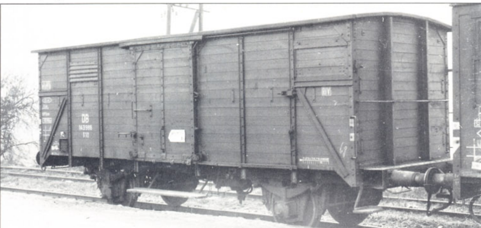
Bild 6: Das ehemalige Handbremsende des G 10 mit der DB-Nummer 143 986 (früherer Gattungsbezirk: Karlsruhe) ist hier gut zu erkennen: Das Untergestell des Wagens steht über die Stirnwand. Hier befanden sich früher die Trittstufen und Leitern zum hochliegenden Bremserhaus (aufgenommen im Februar 1964). Foto: F. Burkhardt, Sammlung Diener
