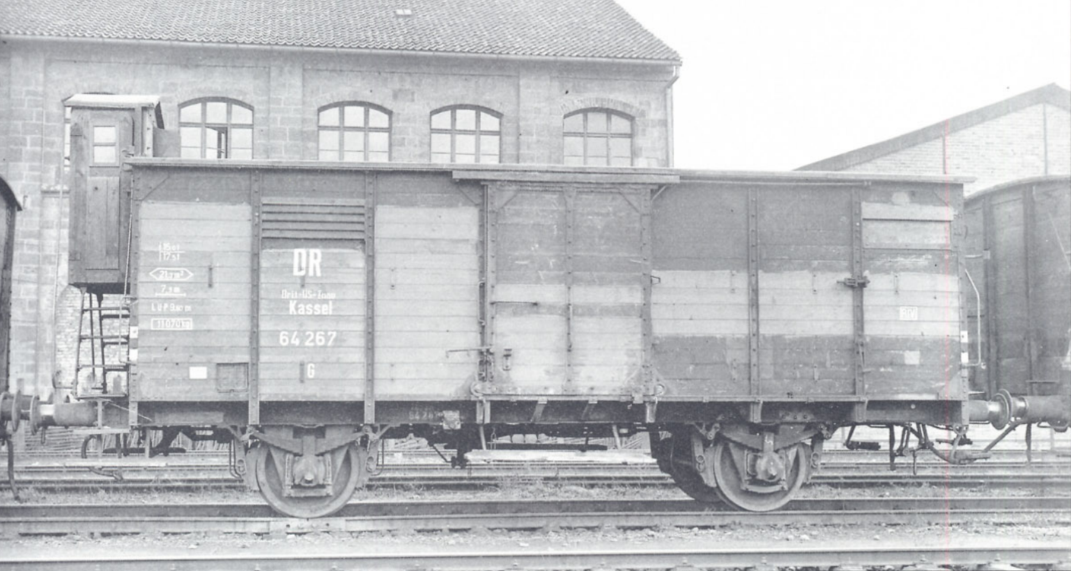
Bild 1: Um 1950 wurde der G Kassel 64267 aufgenommen. Folgende Bauartänderungen fallen auf: abgeändertes Bremserhaus, Hülsenpuffer. Foto: R. Klitscher, Sammlung Diener
