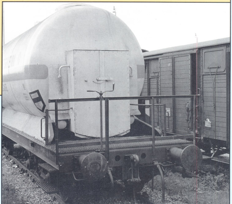
Bild 4: Am Handbremsende des Wagens befindet sich ein Geräteschrank. Die Bühnenabdeckung und die Aufstiege sind als Gitterroste ausgeführt. Fotos und Zeichnung: H. Obermayer
