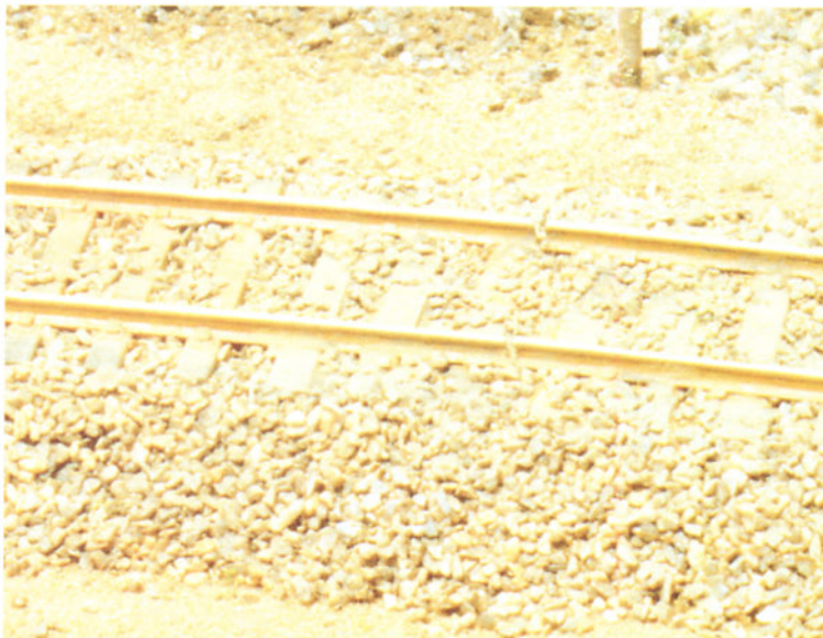
Bild 11: Eine Spurlehre (Nemec) garantiert den korrekten Schienenabstand. Beim Löten müssen Sie darauf achten, daß die Schiene nicht nach unten durchgedrückt wird.
