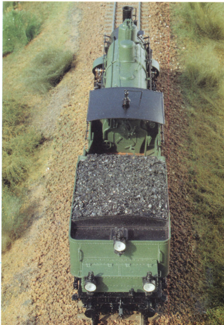
Bild 12: Hier nun ein Blick von hinten auf die Lok. Gut zu erkennen ist die Stehkesselrückwand.
