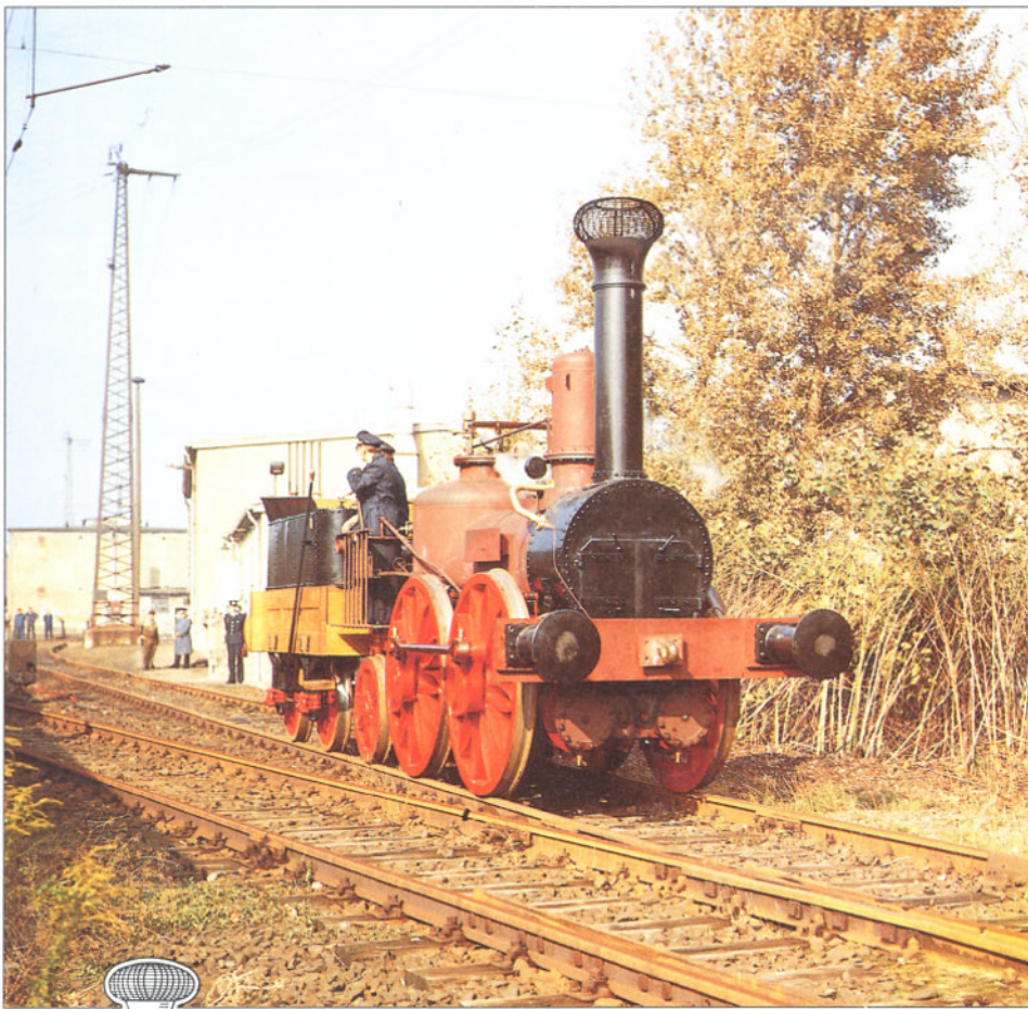
Bild 9: Zum ersten Mal bewegt sich die Saxonía selbst mit Dampf. Die erste Fahrt dient dem Einstellen der Kesselsicherheitsventile. Foto: B. Sprang
