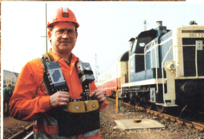
Bild 6: Rangierbetrieb mit der 365 720-2. Die Bedienelemente am Fernsteuerbediengerät sind gut zu erkennen. Foto: DB
