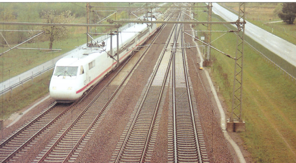
Bild 4: Im April 1989 fanden auf der Neubaustrecke Mannheim – Stuttgart Versuchsfahrten mit dem ICE statt, dem ein Meßwagen angehängt war. Hier verläßt der ICE die Neubaustrecke über die Schnellfahrweiche des Abzweigs Saalbach.
