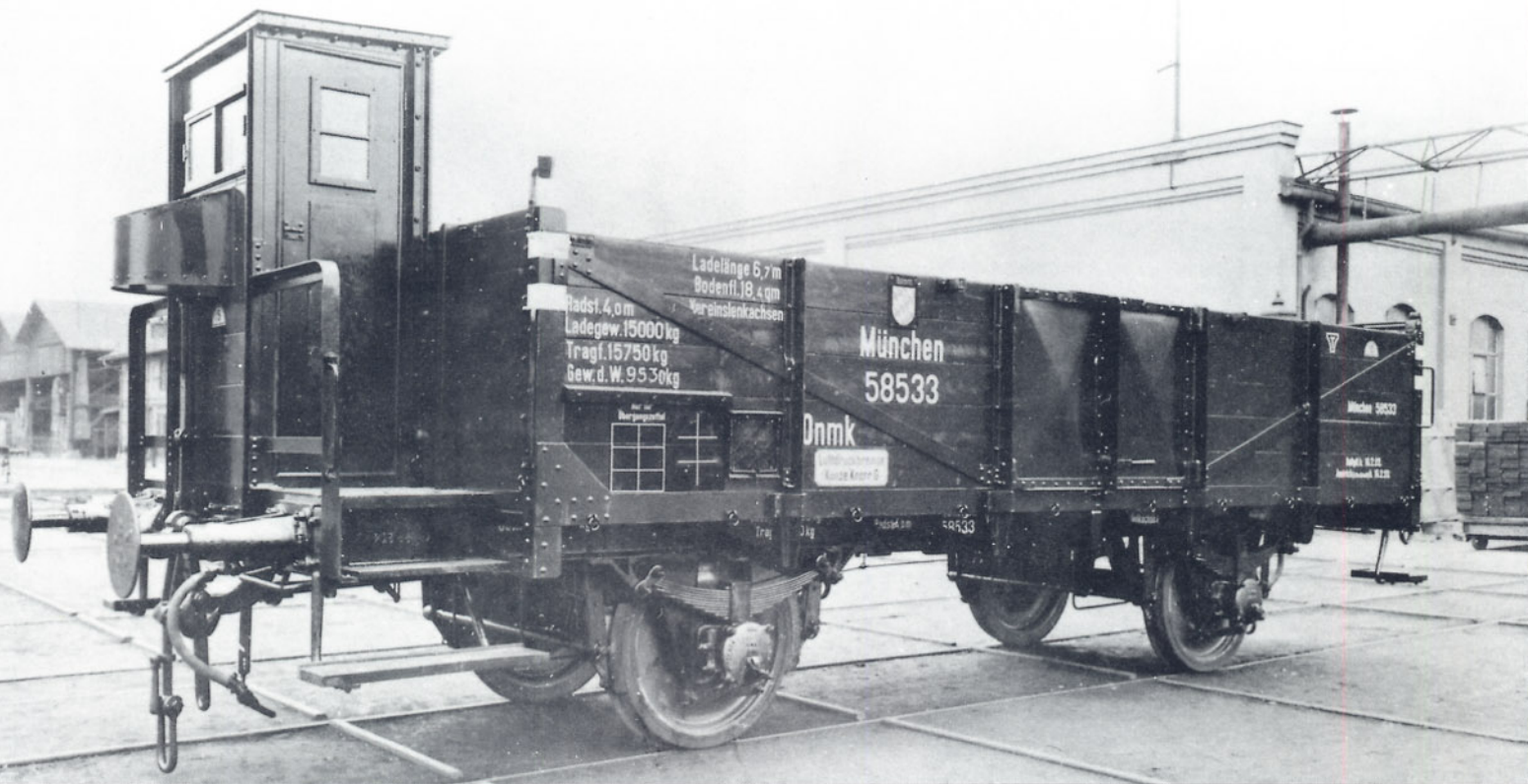
Bild 1: Zweiachsiger offener Güterwagen mit Bremserhaus in Schrägsicht mit der Wagennummer München 58 533 Onmk.
