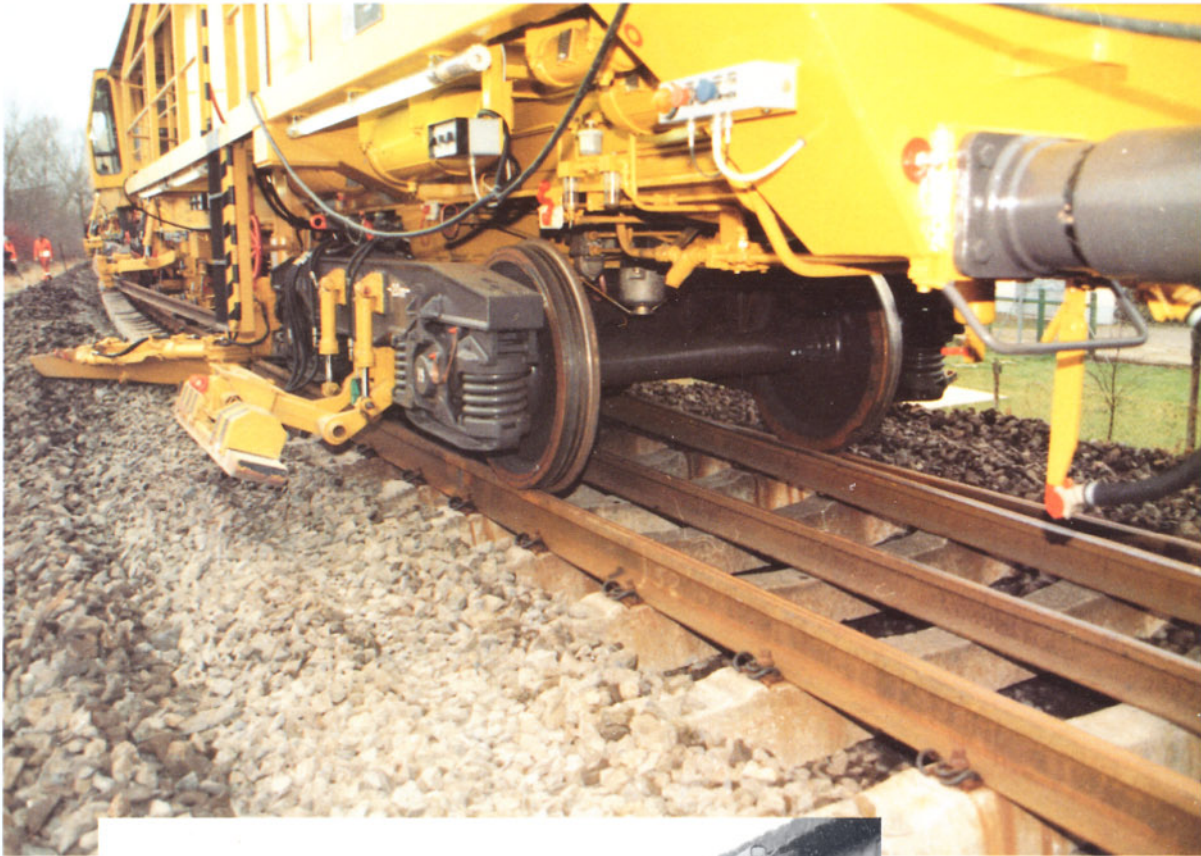
Bild 9: Seit Jahren bei der DR erfolgreich im Einsatz ist dieser Gleisumbauzug SUM 1000 Q.
