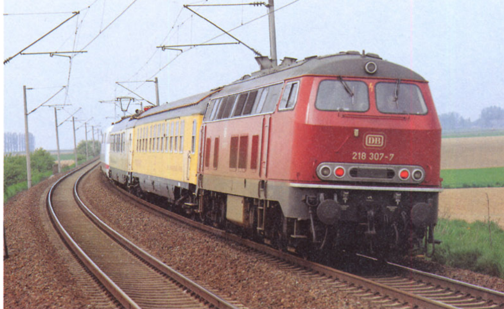
Bild 3: Um das Rangieren zu erleichtern sowie für nicht elektrifizierte Gleisabschnitte in den Bahnhöfen führt die Einheit auch eine Diesellok mit.
