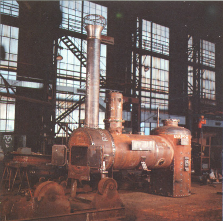
Bild 6: Kessel und Feuerbüchse wurden wie vor 150 Jahren in Dresden-Übigau gefertigt.
