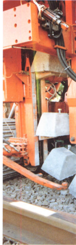
Bild 9: Seit Jahren bei der DR erfolgreich im Einsatz ist dieser Gleisumbauzug SUM 1000 Q.
