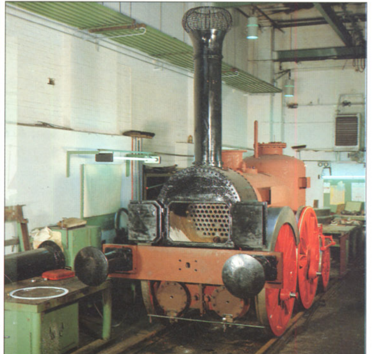
Bild 7: Die Saxonía nimmt Form an: Der Kessel ist bereits auf das Fahrgestell aufgesetzt. Fotos 4 bis 7: B. Sprang
