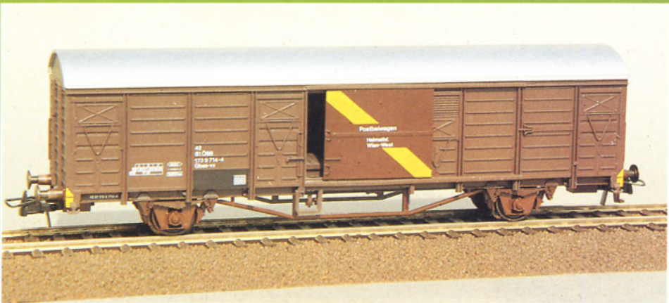
Bild 4: Wird bei den ÖBB zur Beförderung von Bahn-Expreßgut verwendet: GbsVx in Enzianblau.
