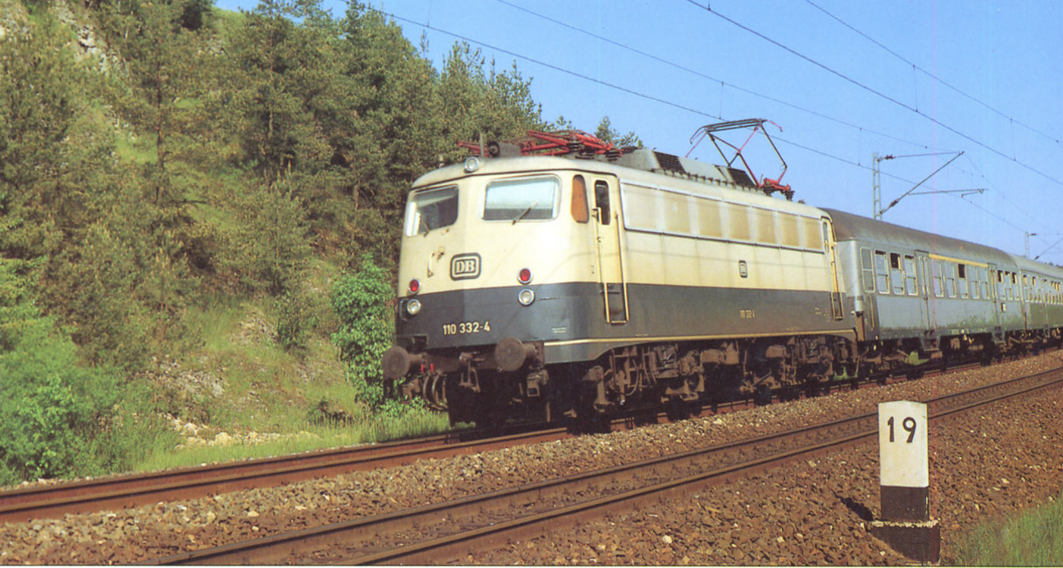
Bild 12: Die Standardversion der "Bügel falte"-E 10 der letzten Jahre: blau-beiger Lack, keine Regenrinne und keine Rangierer-Griffstange, aber neue Lüftergitter. So ausgerüstet legt sich die 110 332 mit einem Eilzug nach Nürnberg am 17. Mai 1983 bei Laaber in die Kurve. Foto: A. Ritz
