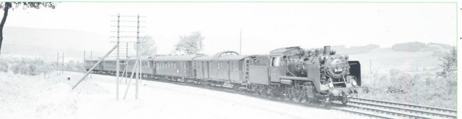
Bild 16: Ab der Betriebsnummer 24 071 wurden die Lokomotiven der Baureihe 24 mit dem neuen Tender 3 T 17 in geschweißter Ausführung geliefert. Durch einen Tendertausch erhielt auch die 24 048 der Deutschen Bundesbahn einen solchen Tender (12.06.1961). Foto: G. Neumann
