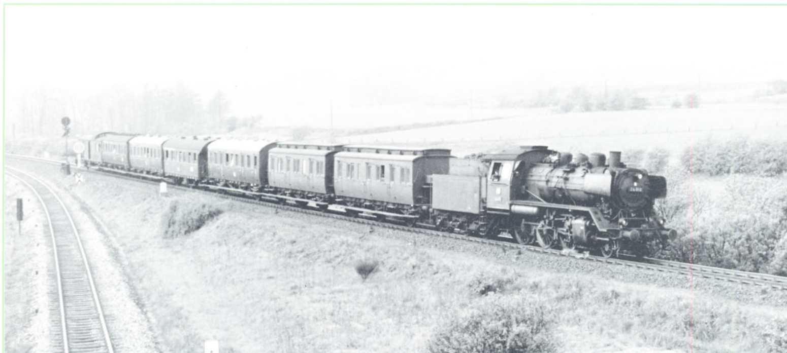
Bild 15: Die 24 050, die bei der Deutschen Bundesbahn Witte-Windleitbleche erhielt, wurde 1958 bei Bottrop aufgenommen.
