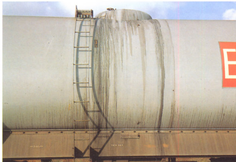
Bild 6: Dieses Vorbildfoto zeigt die Überlaufspuren an der Kesselwand.
