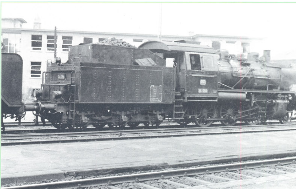
Bild 18: In ihrer Ursprungsausführung waren die Lokomotiven der Baureihe 24 mit einem neu entwickelten Tender der Bauart 3 T 16 in Nietbauweise gekuppelt. Hier die 24 056 am 12.06.1961 in Glückstadt. Foto: G. Neumann
