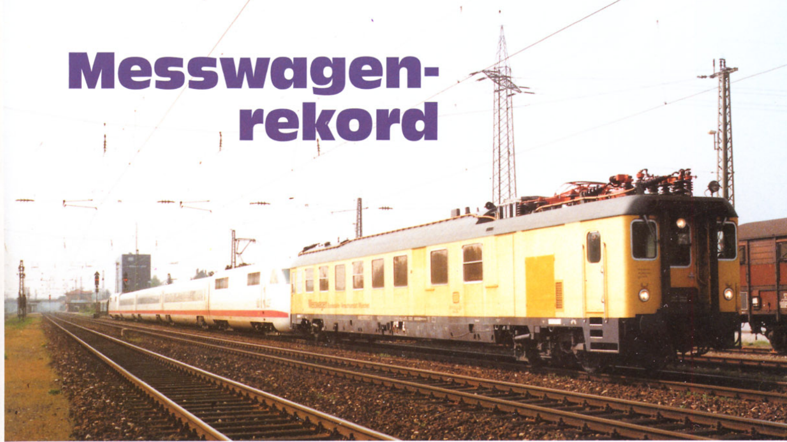
Bild 1: Bei Meßfahrten erreichte am 18. April 1989 der Oberschwingungsmeßwagen 92 011 der Bundesbahn-Versuchsanstalt München zusammen mit dem ICE-Triebzug auf der Neubaustrecke Mannheim – Graben-Neudorf die neue Rekordgeschwindigkeit für Meßwagen von 305,3 km/h.
