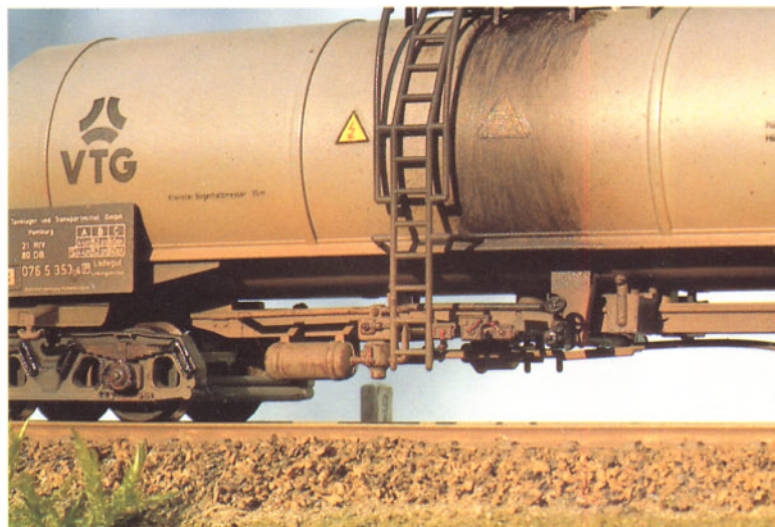
Bild 8: Im Bereich des Abfahnhahns finden sich deutliche Ölsuren. Fotos: D. Rothenfußer
