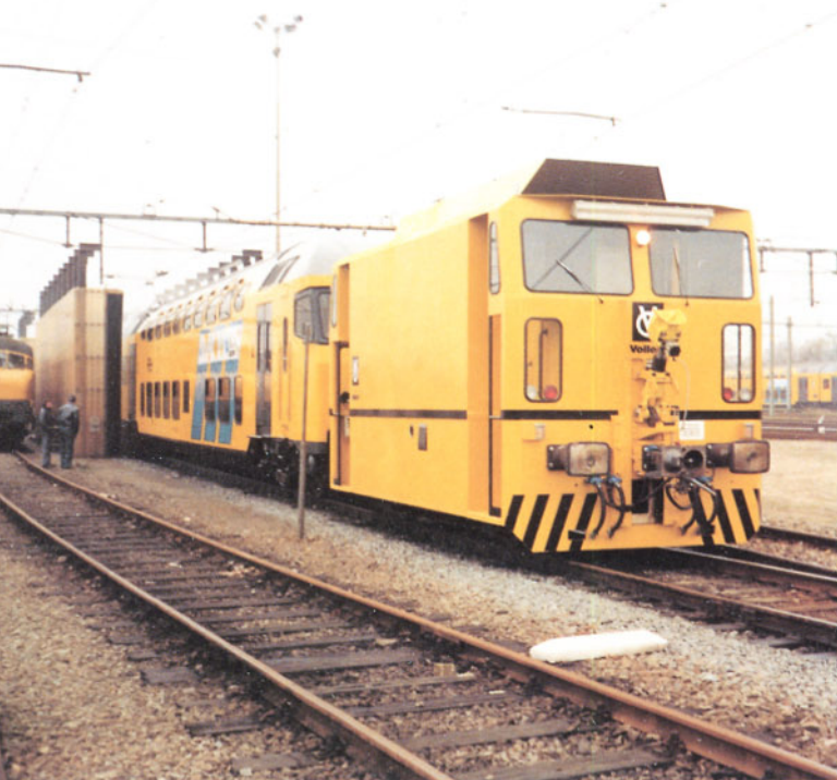
Bild 1: Mit Schrittgeschwindigkeit zieht der Rangier-Traktor einen Zug durch die Waschanlage.
