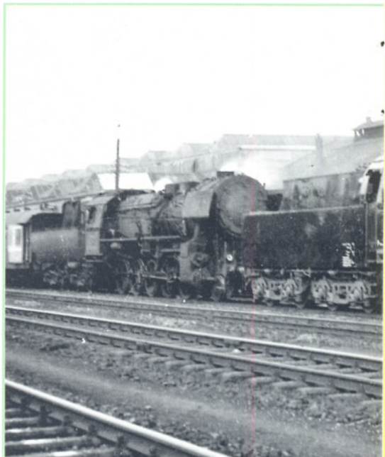
Bild 17: Als einzige ihrer Baureihe war die 24 061 ab 1949 mit einem Tender der Bauart 2'2' T 26 gekuppelt. Das Foto vom 14.01.1949 zeigt sie zusammen mit der 52 129 vor
