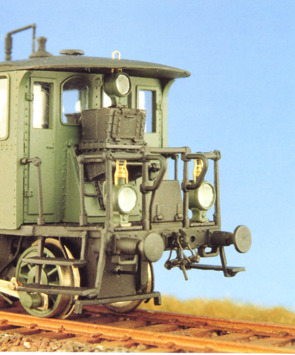
Bild 4: Charakteristisch für die LAG 68 sind die sehr lang ausgeführten unteren Trittbretter sowie der relativ kleine Vorratsbehälter oberhalb der Kohlschütte. Foto: W. Kosak
