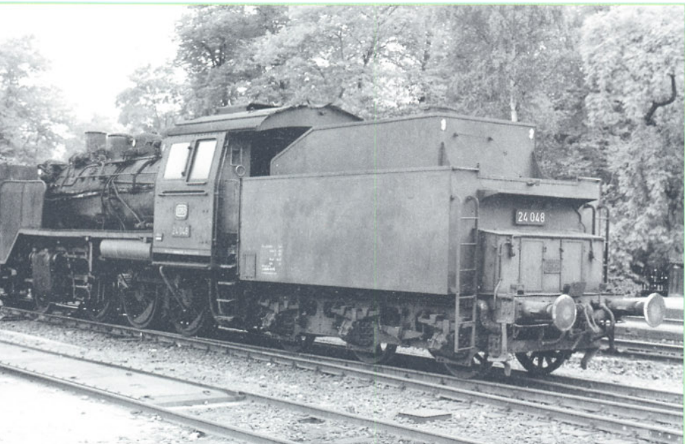
Bild 16: Ab der Betriebsnummer 24 071 wurden die Lokomotiven der Baureihe 24 mit dem neuen Tender 3 T 17 in geschweißter Ausführung geliefert. Durch einen Tendertausch erhielt auch die 24 048 der Deutschen Bundesbahn einen solchen Tender (12.06.1961). Foto: G. Neumann
