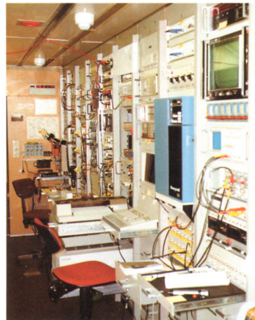
Bild 2: Blick in das Innere des klimatisierten Meßraumes des Oberschwingungsmeßwagens 92 011 der Bundesbahn-Versuchsanstalt München.
