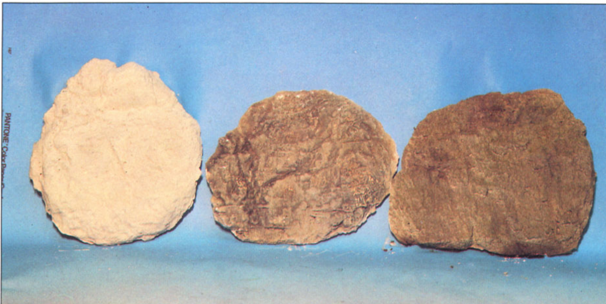
Bild 9: Von links nach rechts: eine unbehandelte, eine eingefärbte und eine mit der Zip-texturing-Methode behandelte Gipsform. Auf die "Behandlungsmethoden" geht der Text ausführlich ein.
