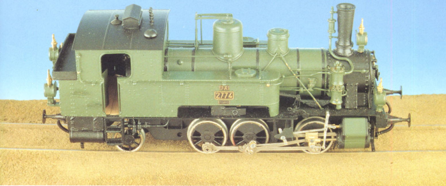
Bild 5: In Abwandlung vom Bausatz erhielt die Lokomotive einen neuen Dampfdom und die richtigen Sicherheitsventile.
