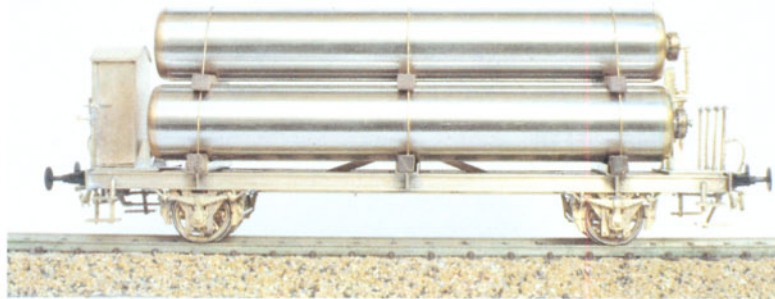
Bild 3: Die drei Gasbehälter werden aus einem Rohr mit ca. 14 mm Durchmesser angefertigt und mit Drehteilen verschlossen.
