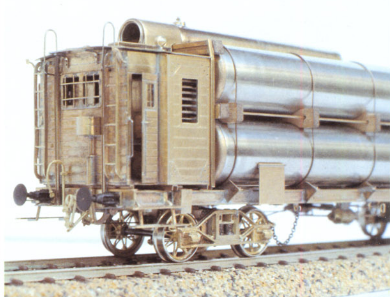
Bild 12: Das Maschinenhaus ist aus Messingblechteilen zusammengesetzt. Zur Imitation der Holzverschalung wurden die Seitenwände mit einem spitzen Reißnagel eingeritzt.
