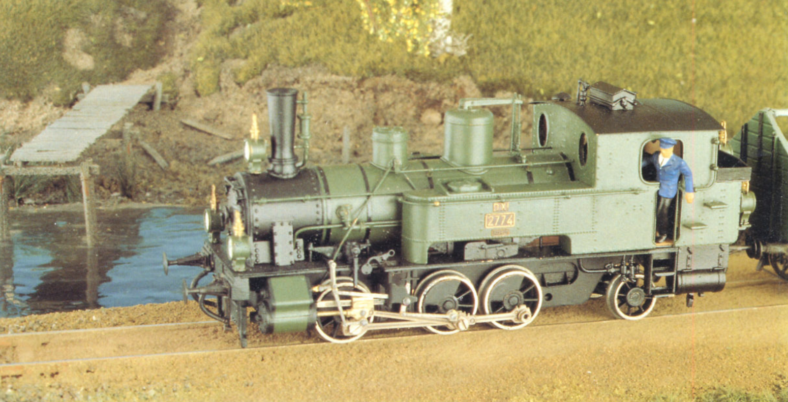
Bild 2: Die Räder unseres Modells stammen von der E 3/3 aus dem Hause Liliput. Dank der auf 0,6 mm abgedrehten Spurkränze entsteht ein sehr realistischer Eindruck. Foto: W. Kosak
