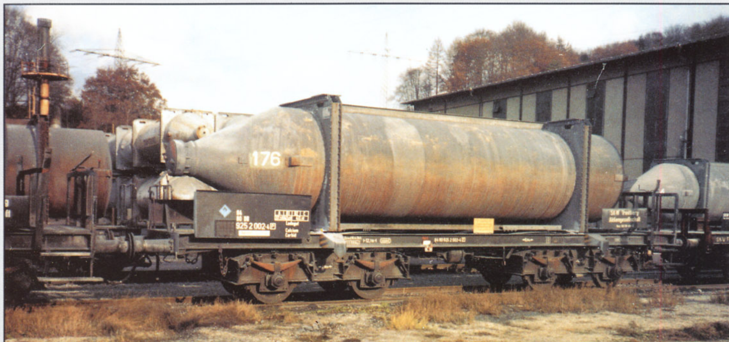
Bild 9: Das Hauptobjekt unseres demnächst folgenden Selbstbau-Vorschlags: ein Calciumcarbidgeflaschen-Wagen. Der Rahmen stammt noch aus den zwanziger Jahren; die Ersatzdrehgestelle sind aus den vierziger Jahren. Auch Rollen- anstatt der Gleitlager sind bereits vorhanden.
