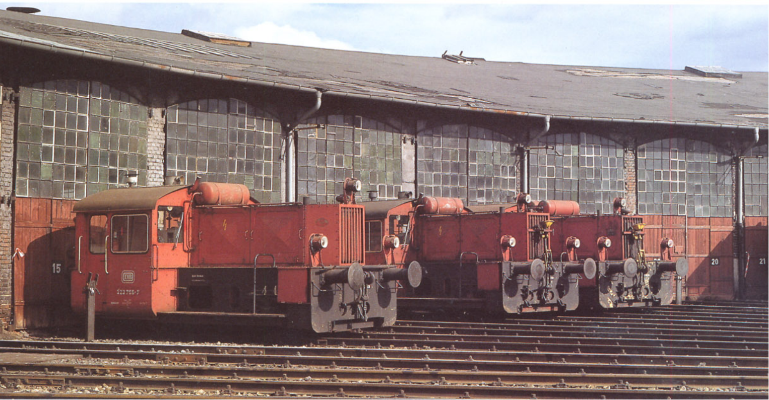
Bild 4: "Kleine Lokparade" im Bahnbetriebswerk München 1. Am 21.10.1984 standen drei Kleinlokomotiven mit Verbrennungsmotor vor dem großen Ringschuppen. Zwei davon (Mitte und rechts außen) verfügen über eine Rangierkupplung. Foto: A. Ritz
