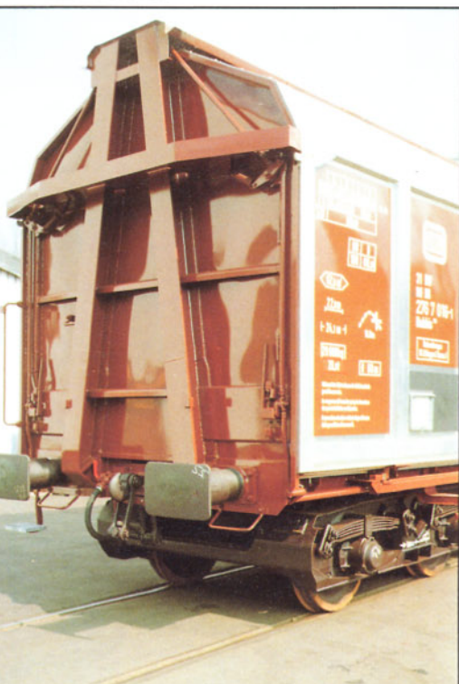
Bild 9: 50 Wagen der Bauart Habbills 346 – vierachsige, großvolumige Schiebewandwagen – lieferte die Waggon Union an die DB.
