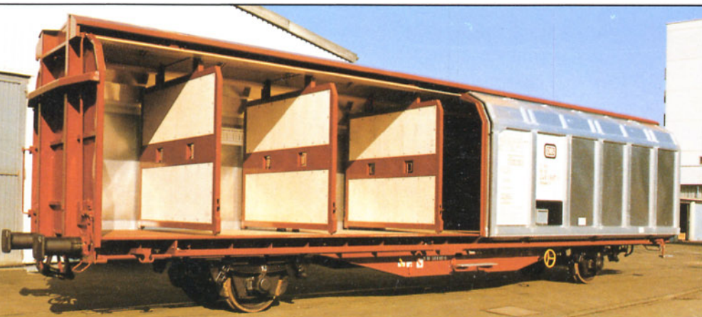
Bild 2: Die Wagen der Bauart Hbbilins 305 sind mit sechs verschiebbaren Trennwänden ausgestattet.
