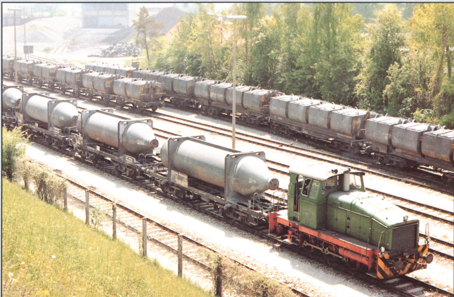
Bild 1: Betrieb im Werksbahnhof: Eine Krauss-Maffei-Diesellok wartet mit einem ganzen Zug frisch gebrannten Carbid auf die Ausfahrt. Links dahinter eine Reihe zweiaxiger Kalkkübelwagen in der Ausführung der vierziger Jahre. Auf dem letzten Gleis ein Zug aus modernen vierachsigen Kalkwagen.
