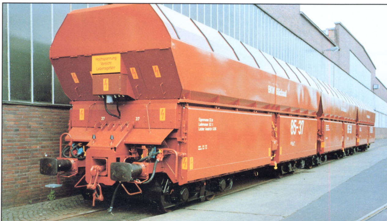
Bild 12: Vierachsige Großraum-Selbstentladewagen der Bauart Fal, wie sie vom BKW Glückauf (DDR) für den Transport von Braunkohle bestellt wurden.
