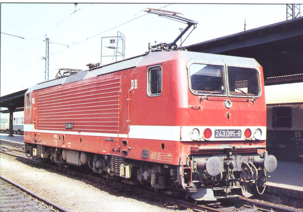
Bild 16: Die Mehrzweck-Elektrolok der Baureihe 243 gibt es inzwischen in weit über 400 Einheiten. Foto: M. Weisbrod
