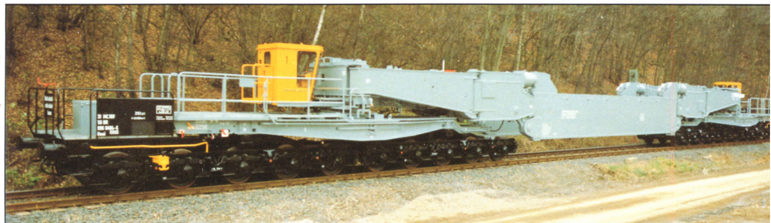
Bild 5: Zwanzigachsiger Tragschnabelwagen Uaais 6191 mit Durchladeträgern für die Deutsche Reichsbahn der DDR.
