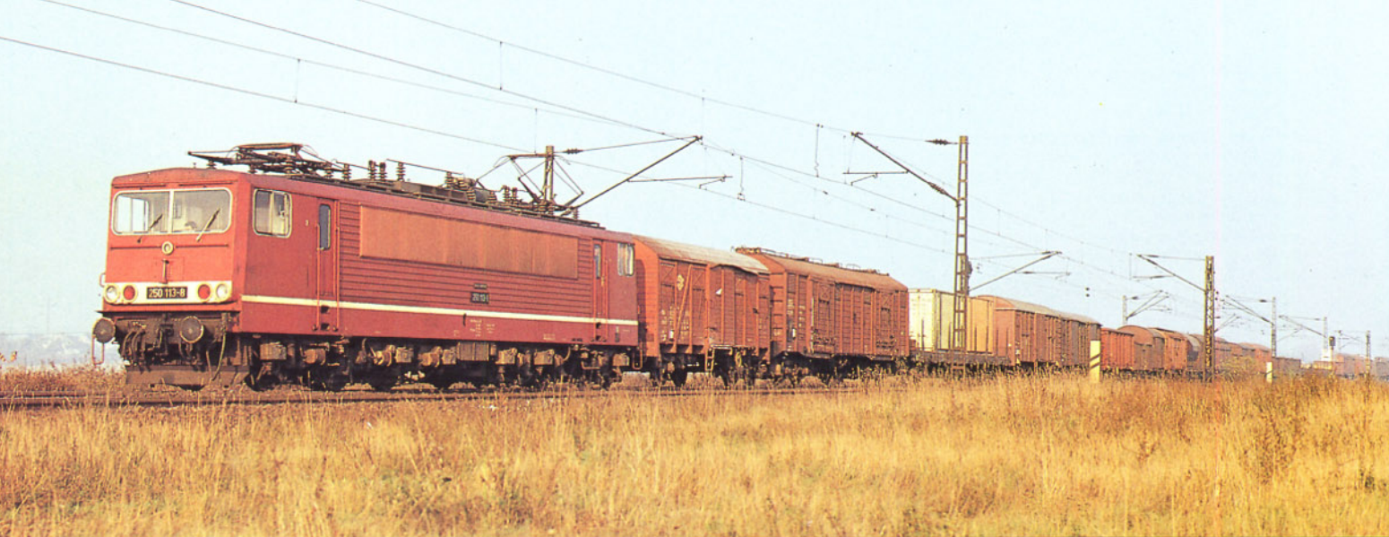
Bild 9: Leistungsstärkste Neubau-Elektrolokomotive der DR ist die Baureihe 250 (Co'Co'). Auf dieser Strecke bei Riesa wird die Fahrzeugparade stattfinden.
