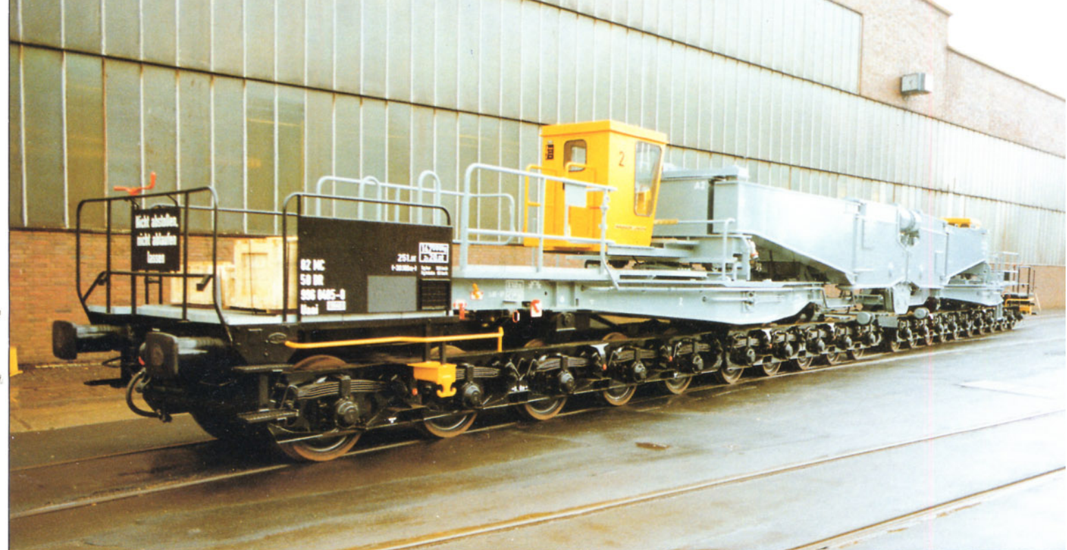
Bild 4: Zu den größten Fahrzeugen aus dem Fertigungsprogramm der Waggon Union gehörten in letzter Zeit zwei zwanzigachsige Tragschnabelwagen der Bauart Uaais 6191, hier in kurzgekuppeltem Zustand.
