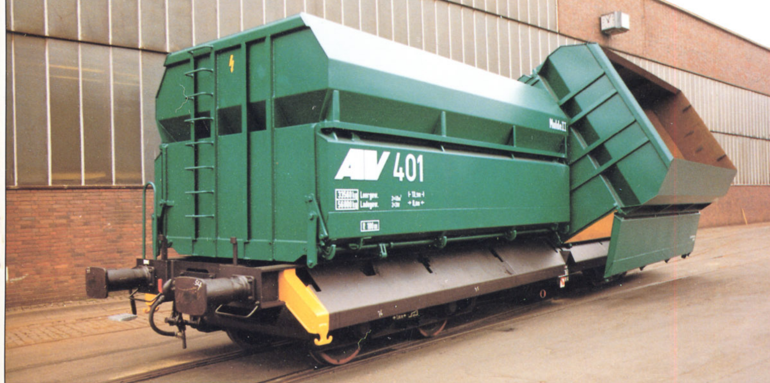
Bild 11: Zweiseitenkippwagen der Bauart Fau für den Werksverkehr der Gewerkschaft Auguste Victoria in Marl. Jede der beiden Kippmulden hat ein Ladevolumen von 40 m 3 .
