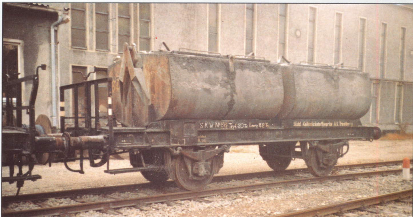
Bild 12: Die zweiachsigen Kalkkübelpwagen aus den zwanziger Jahren, also aus der Reichsbahnzeit (Epoche II), wurden schon aus dem Streckenverkehr gezogen. Im Werk verdienen sie sich ihr "Gnadenbrot". Fotos: Dr. S. Hufnagel
