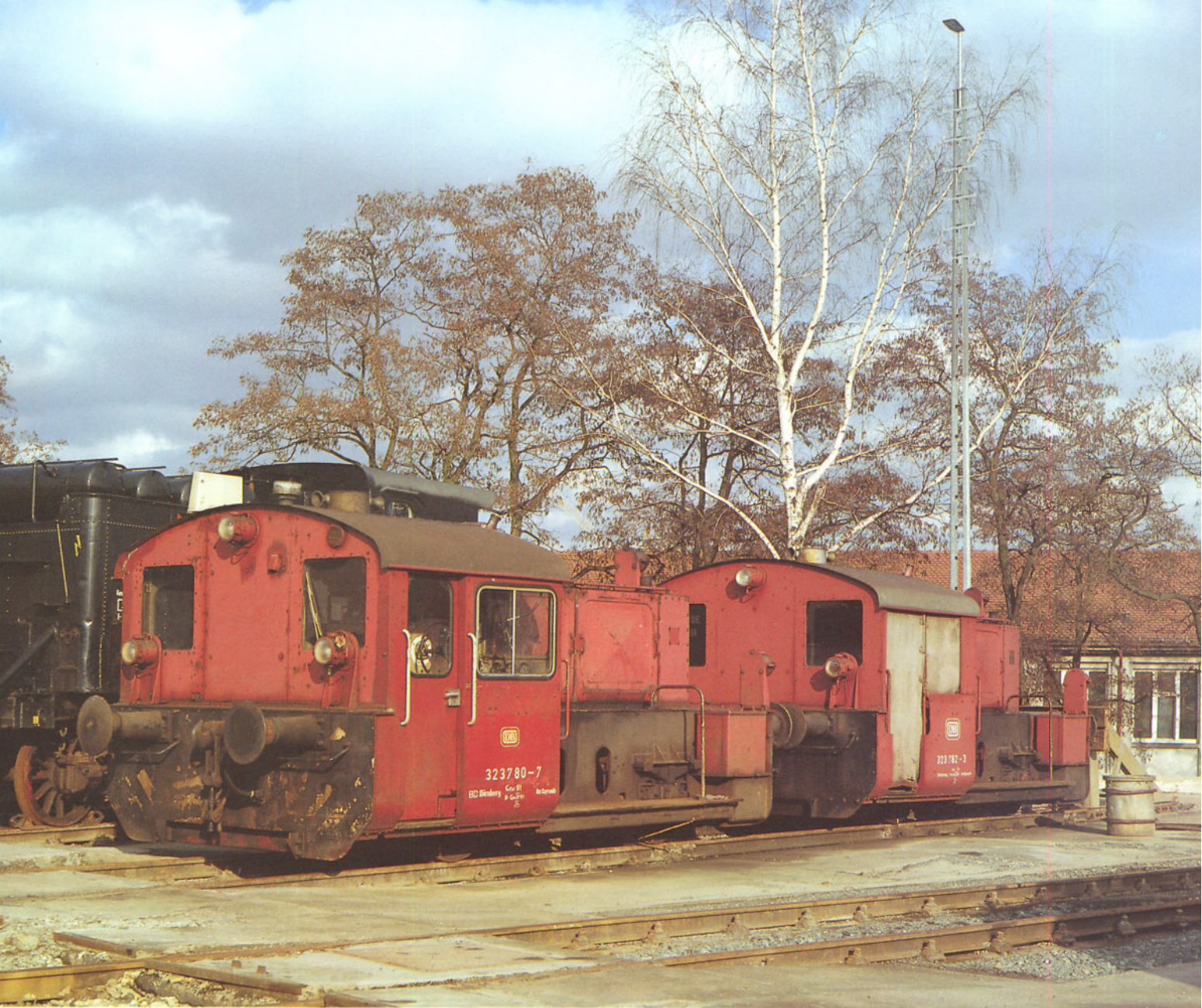
Bild 3: Beim Bahnbetriebswerk Bayreuth (dort wurde auch am 24.03.1983 fotografiert) sind die 323 780 und die 323 782 zum Zeitpunkt der Aufnahme beheimatet gewesen. Erstere gehört zu den "winterfesten" Köf II mit eingebauten Fenstern und Türen sowie einer Warmluftheizung. Foto: A. Ritz
