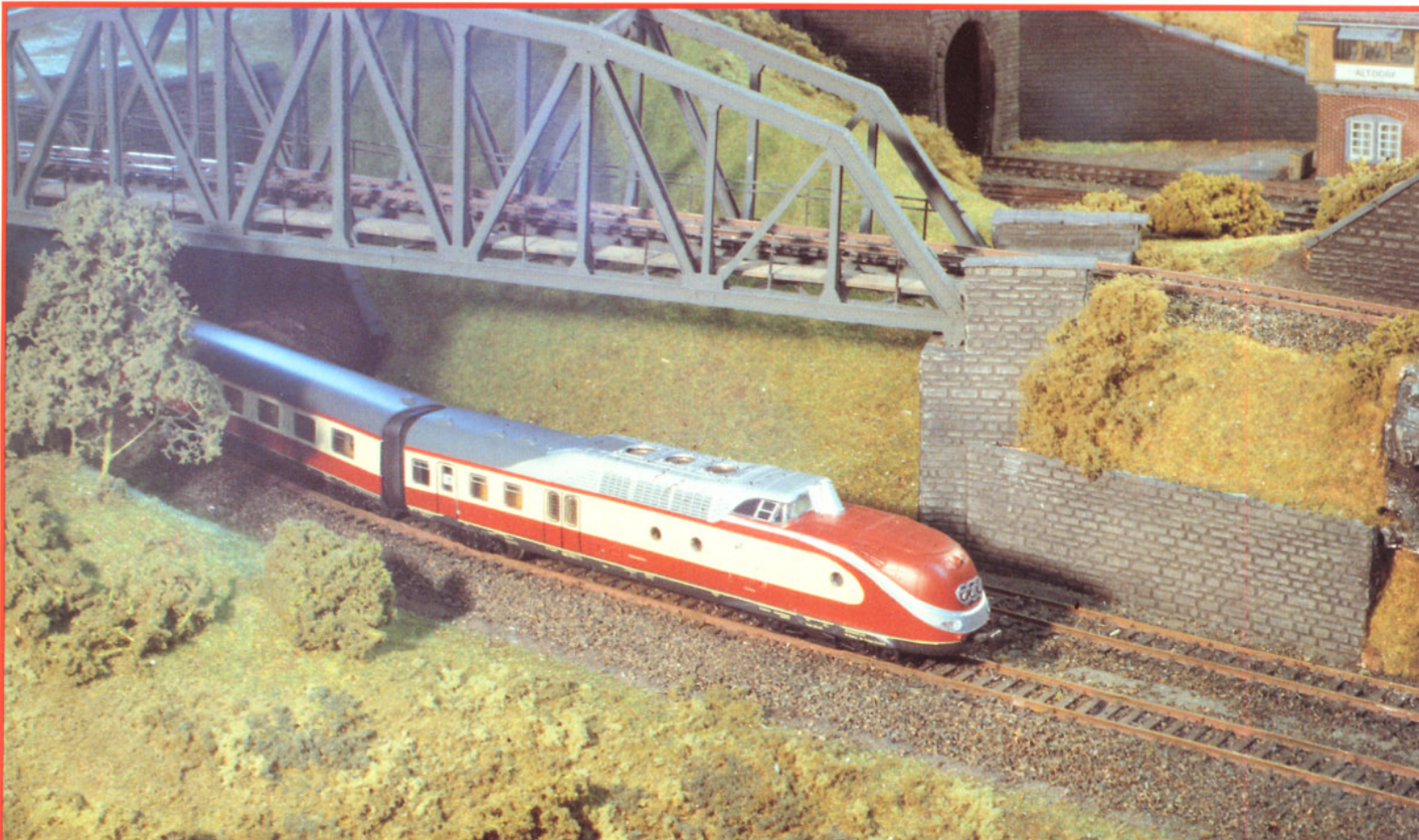
Bild 8: In Gleich- und in Wechselstromausführung gleichermaßen beliebt ist Rocos Triebzug der Baureihe VT 11.5. Die Gleise wurden zur Geräuschdämmung auf 5 mm starkem Schaumstoff verlegt und in N-Korkschothter eingebettet.
