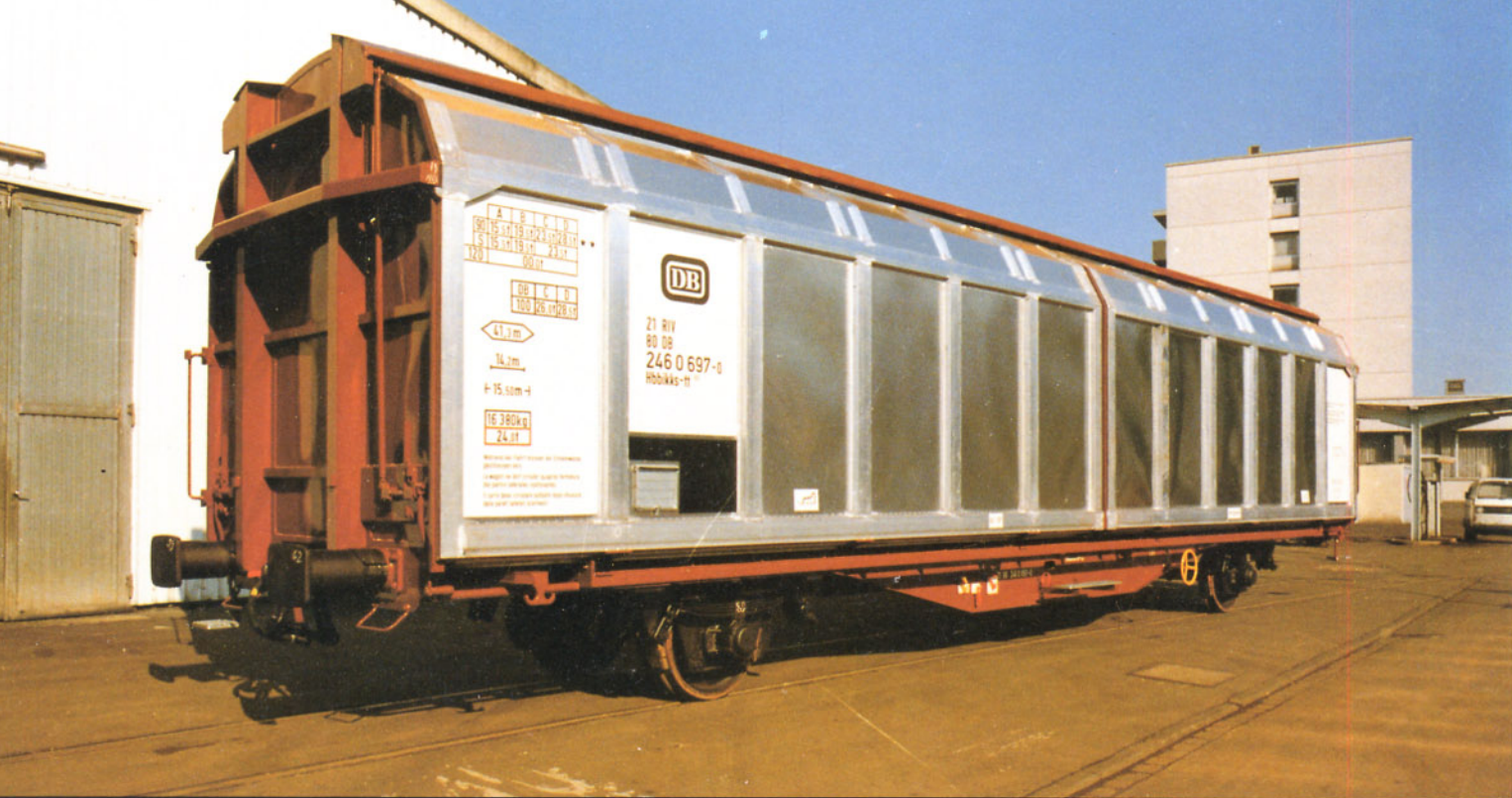
Bild 1: Seit 1985 beschaffte die DB in großer Stückzahl zweiachsige Schiebewandwagen mit einem Ladevolumen bis 105 m 3 .
