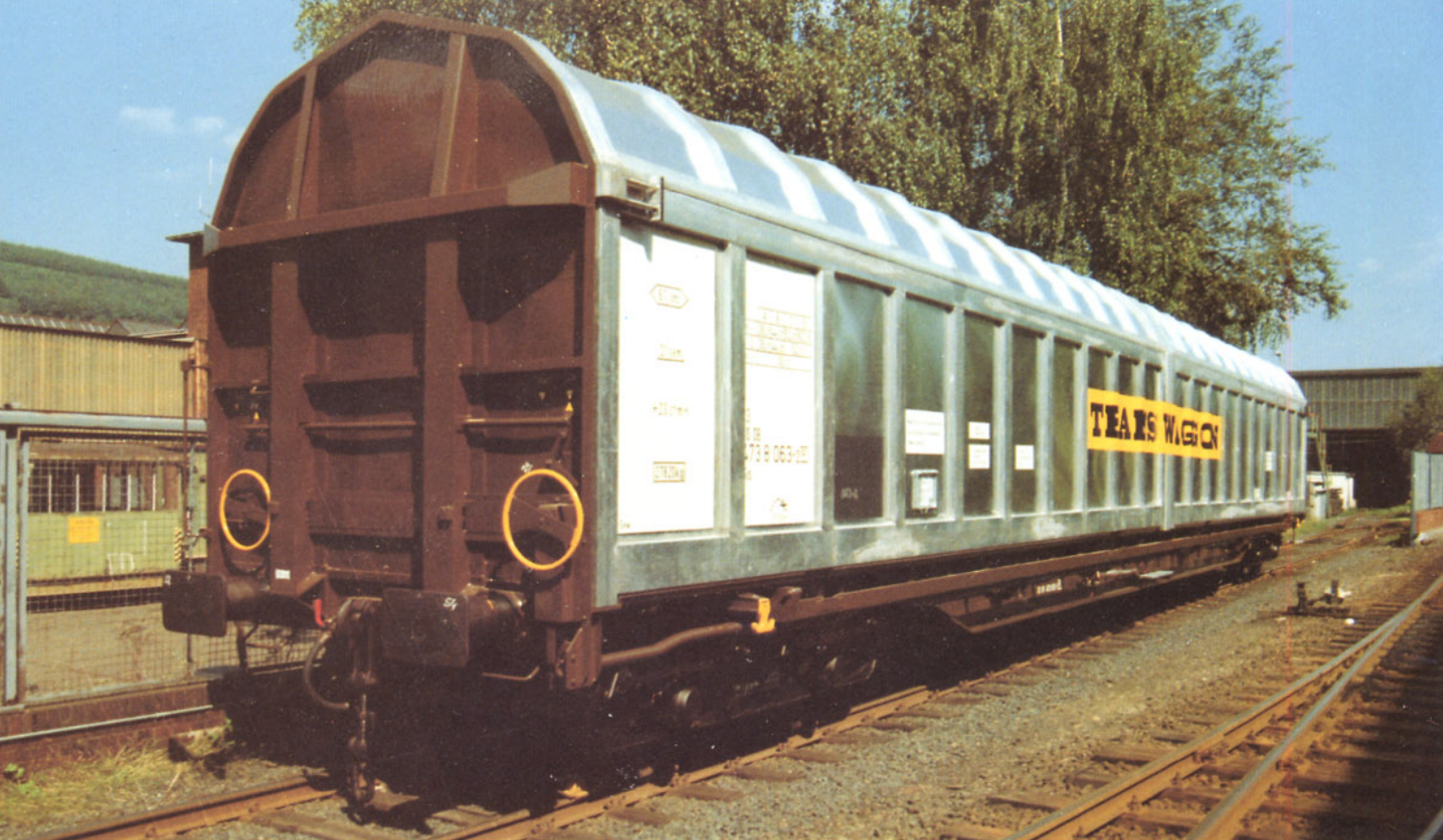
Bild 13: Vierachsiger Ganzwandwagen der Bauart Sins, der an Transwaggon geliefert wurde.
