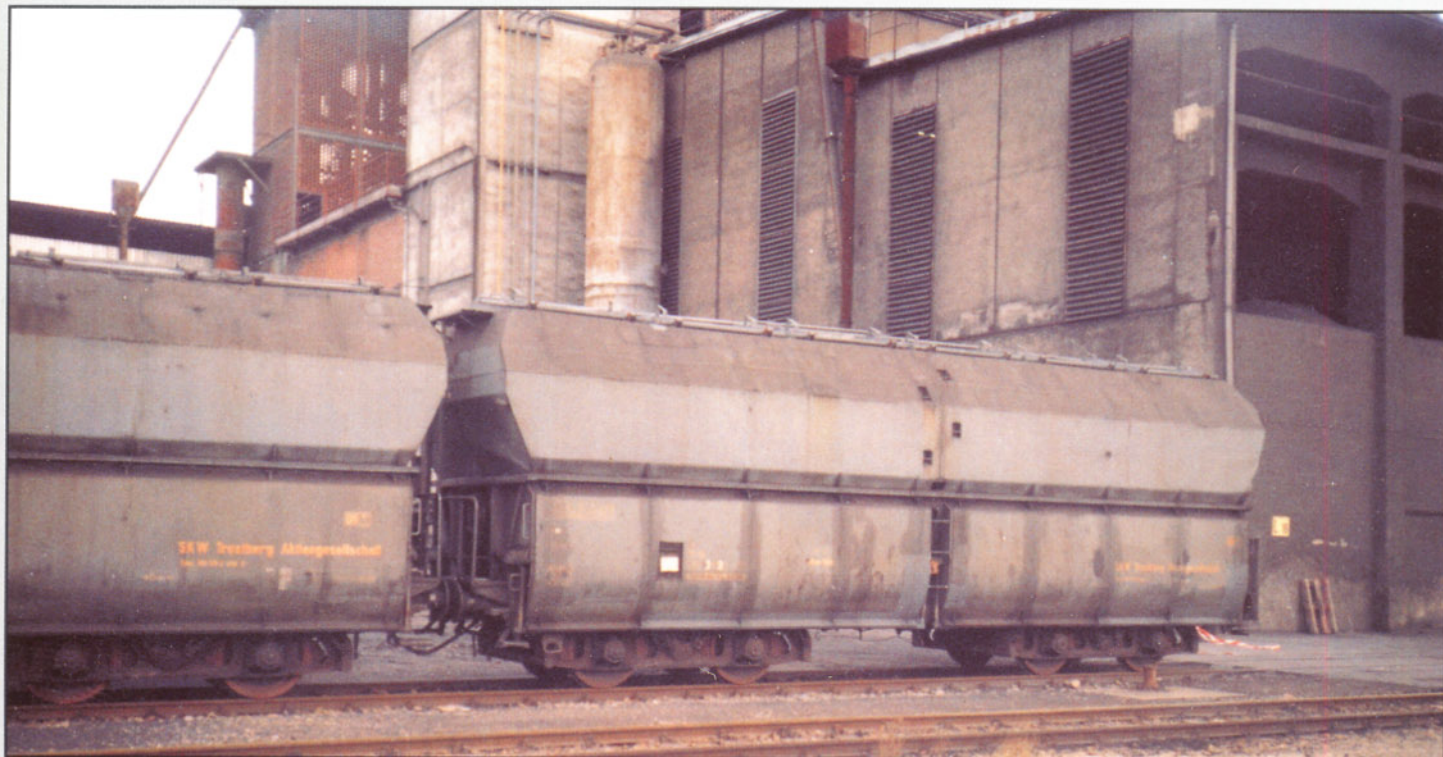
Bild 14: Moderne Großraumgüterwagen mit der Gattungsbezeichnung Tad und verschließbarem Dach kommen heute für Kokstransporte zum Einsatz. Es handelt sich um werkseigene Privatwagen der SKW Trostberg. Foto: Dr. S. Hufnagel
