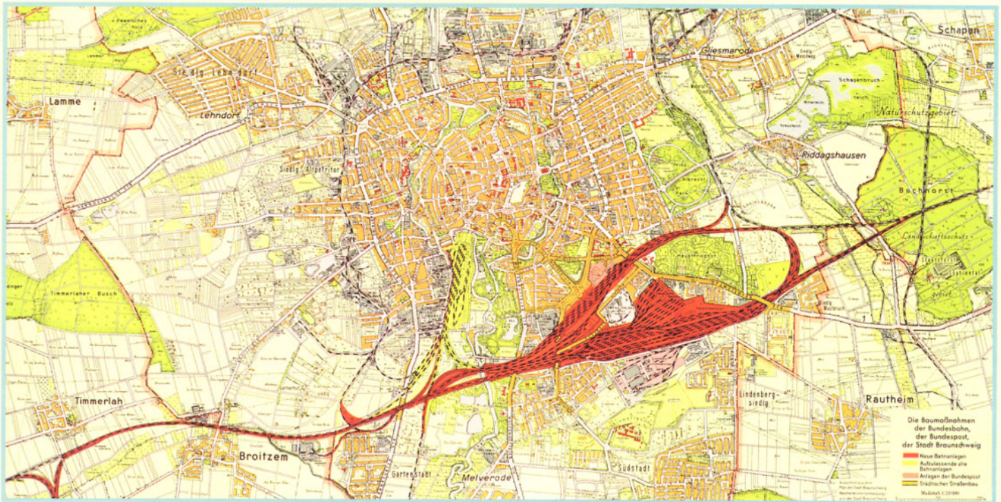
Bild 13: Dieser verkleinerte Kartenausschnitt zeigt die alten Bahnanlagen in Braunschweig (gelb), die mit der Eröffnung des neuen Hauptbahnhofes 1960 aufgelassen werden konnten. Rot markiert sind die neuen Bahnanlagen. (Kartengrundlage: Stadtkarte 1:20 000 von 1957, herausgegeben vom Vermessungsamt der Stadt Braunschweig. Vervielfältigungserlaubnis erteilt: Braunschweig, 31.10.1988, Az. 62.22-11/88, durch Stadt Braunschweig, Vermessungsamt.)
