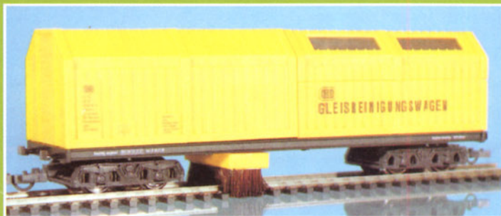
Bild 10: Der Schienenreinigungswagen von Lux Modellbau befördert lose Schmutzpartikel mittels eines "Staubsaugers" ins Wageninnere. Werkfoto Lux
