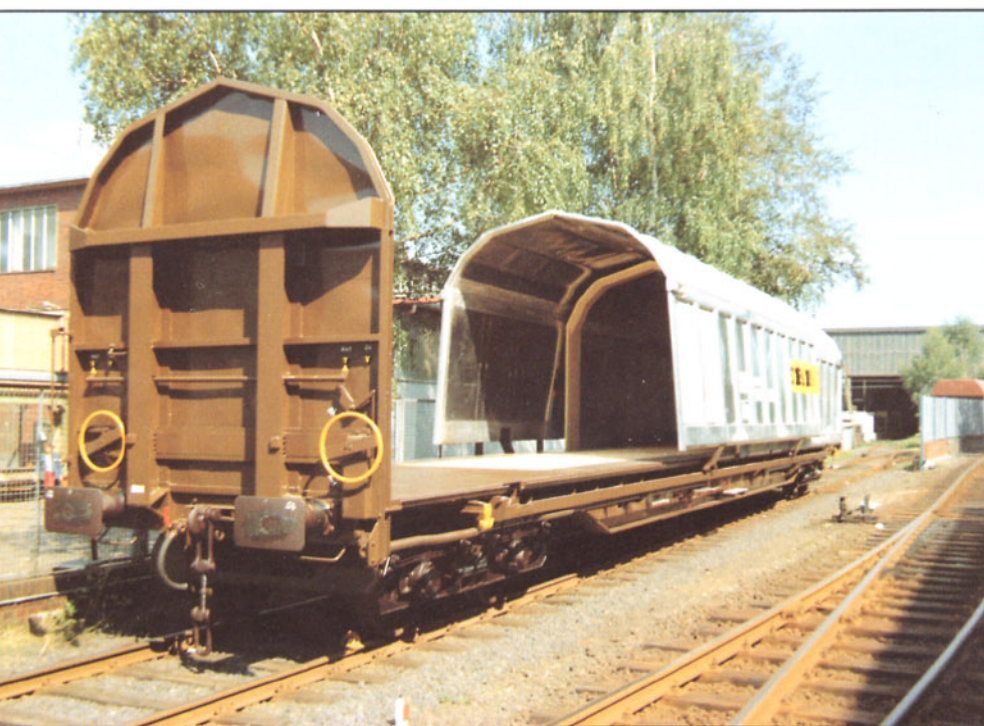
Bild 14: Bei diesem Wagentyp läßt sich die Haube einer Wagenhälfte über die andere schieben.
