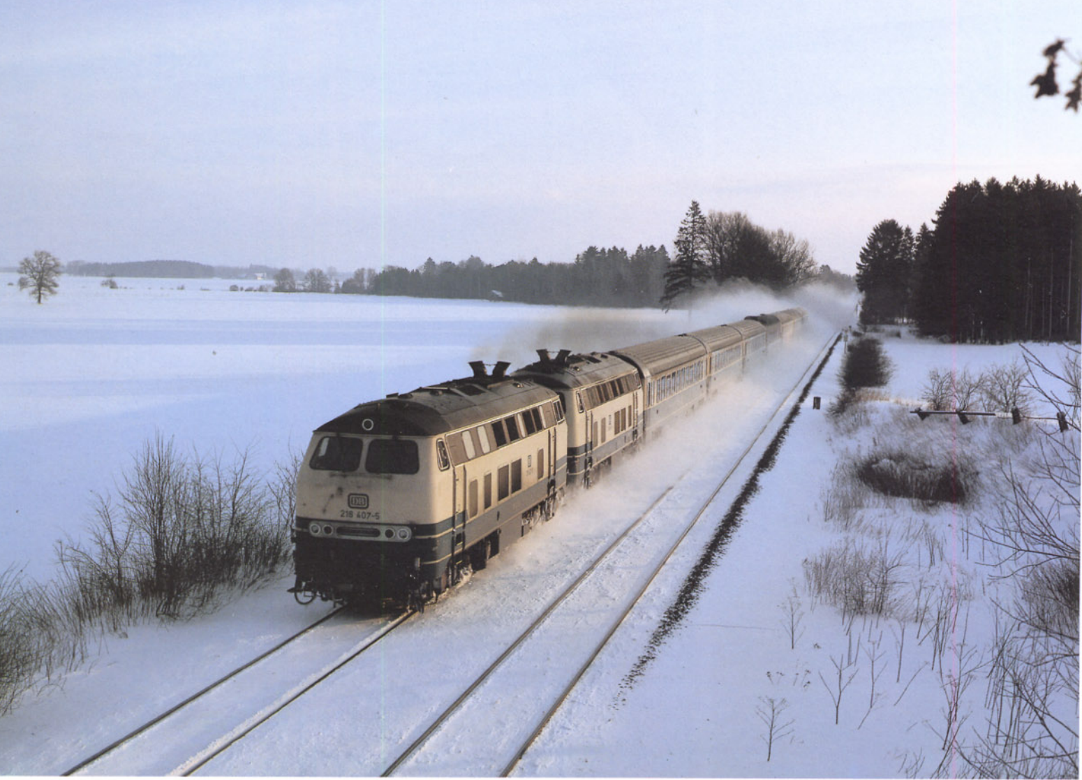
Bild 10: Ab dem Sommerfahrplan 1989 wird der EC "Schweizerland" von München über Zürich nach Bern verlängert. Wegen der steigungsreichen Strecke im Allgäu muß der Zug zwischen München und Lindau in Doppeltraktion (Diesellokomotiven der Baureihe 218 des Bw Kempten/Allgäu) gefahren werden (3. März 1988). Foto: K. Eckert
