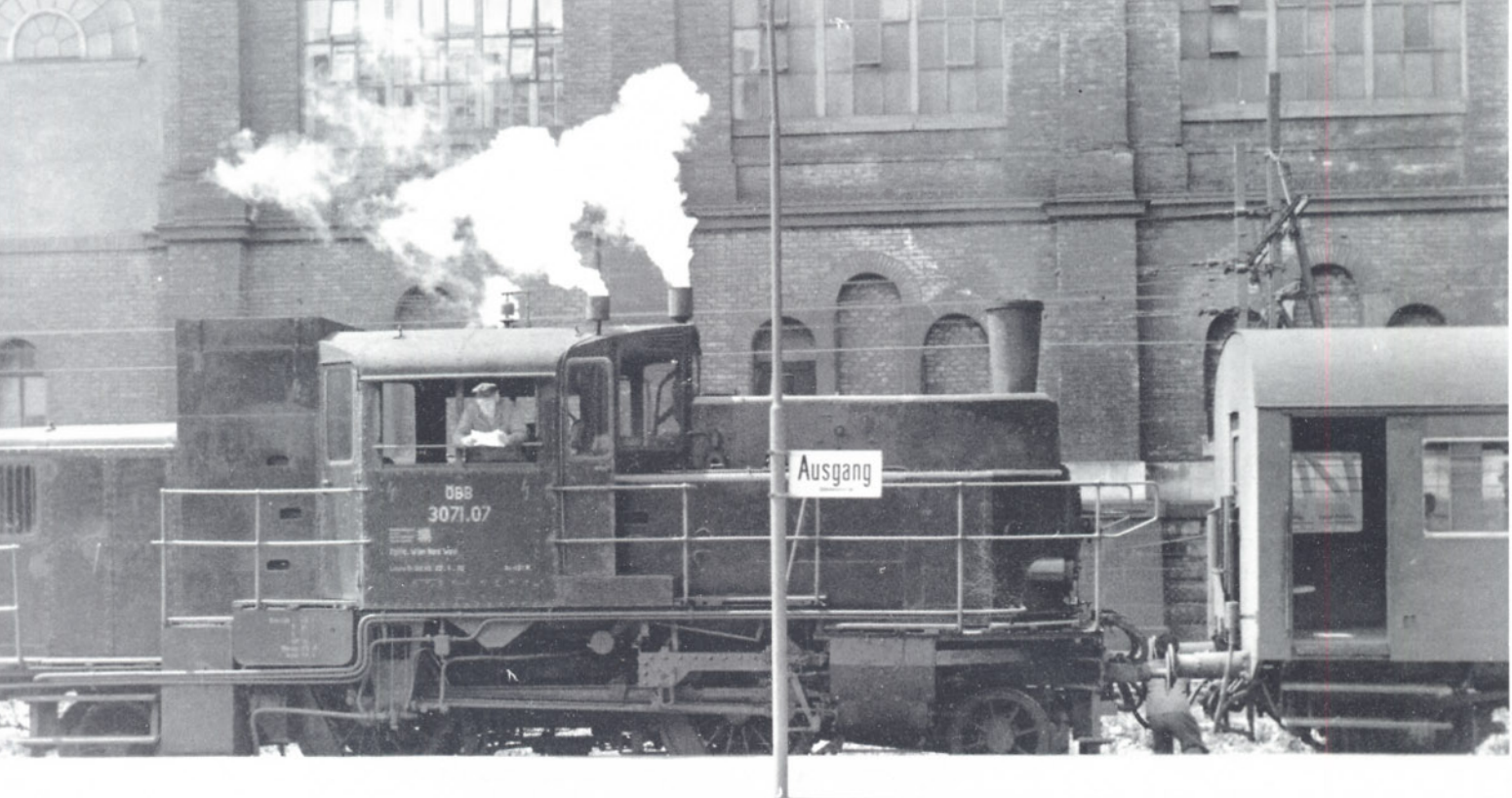
Bild 6: Eben kam der 3071.07 mit einem Zug der Nordwestbahn in der damals mit "Wien-Hauptzollamt" bezeichneten Station an (Juni 1960). Die Lok gehört zum ersten Baulos, hat aber bereits einen höheren Kamin, Windleitbleche, Kohlenkastenaufsatz und Flügeltüren am Gepäckraum. Foto: Dr. Hufnagel
