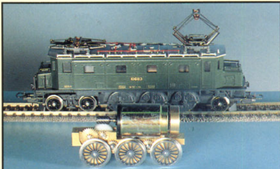
Bild 69: Von Verbeck gibt es neue Antriebsätze für die Ae 3/6 von Lima.
