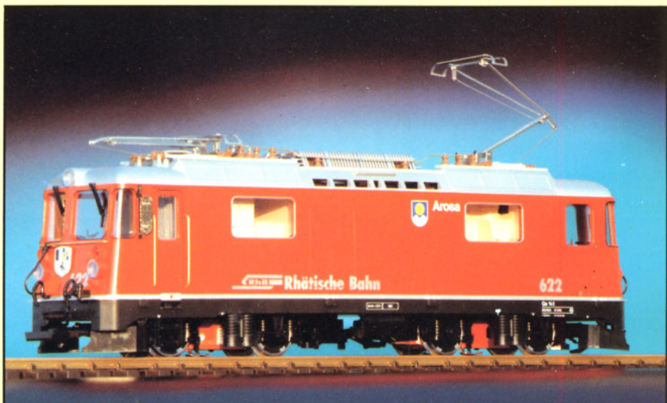
Bild 13: Von LGB ist dieses Modell der Ge 4/4 II 622 der RhB. Die Stromabnehmer lassen sich ferngesteuert vom und an den Fahrdrat heben.
