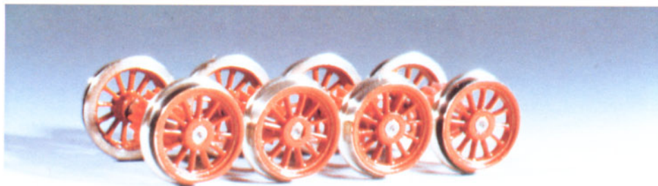
Bild 3: Vier Tenderradsätze für die S 10 von Roco mit Getriebezahnrädern (z=17).
