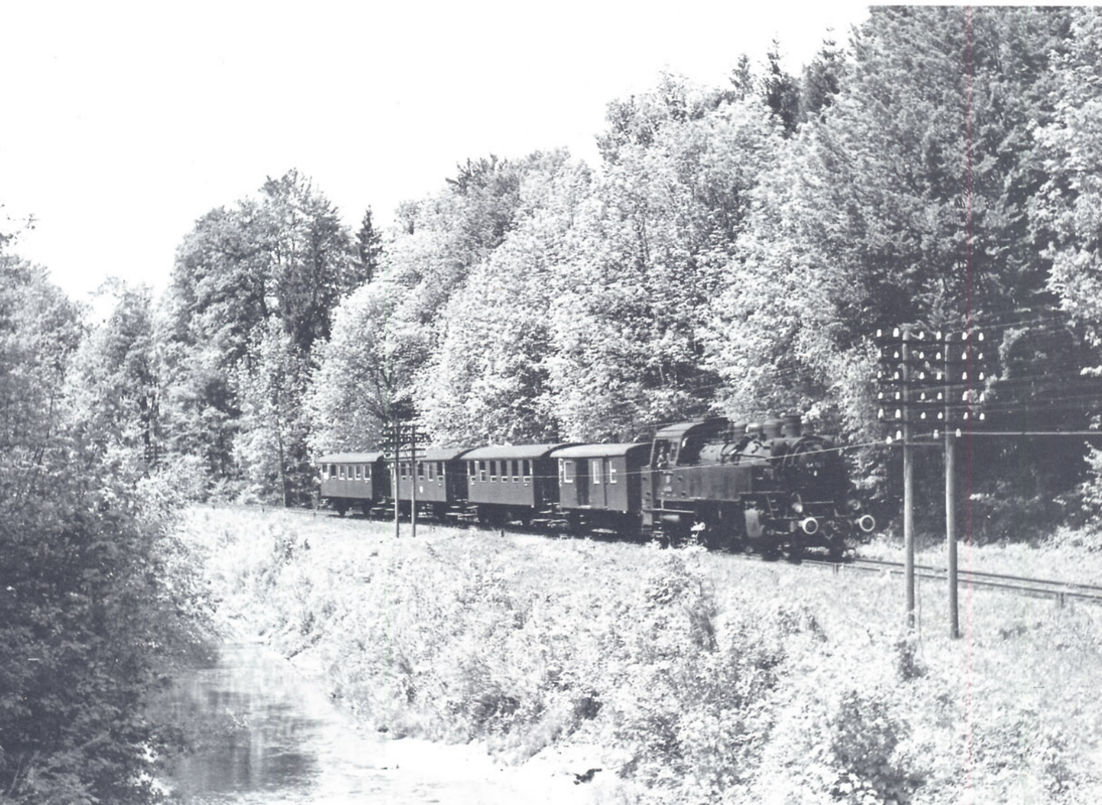
Bild 4: Östlich von Rohrdorf waren wegen der zahlreichen Freileitungen sogar Doppelgestänge notwendig – sehr untypisch für eine Nebenbahn. Die 64 025 ist mit ihrer sehenswerten Lokabahn­garnitur als P 2287 nach Frasdorf unterwegs (21.05.1958).
