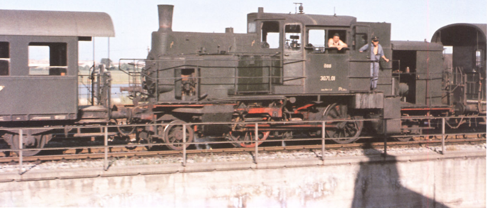
Bild 1: Der Dampftriebwagen 3071.01 (ex DT 1.01) – der erste seiner Art – ist mit einem "Pendler" als Bäderzug vom Wiener Franz-Josephs-Bahnhof nach Kritzendorf unterwegs. Die Aufnahme vom Juni 1957 belegt die Farbgebung des Klein-Modells und zeigt u.a. den niedrigen Kohlenkasten und eine Schiebetüre am Gepäckabteil. Foto: Dr. Hufnagel
