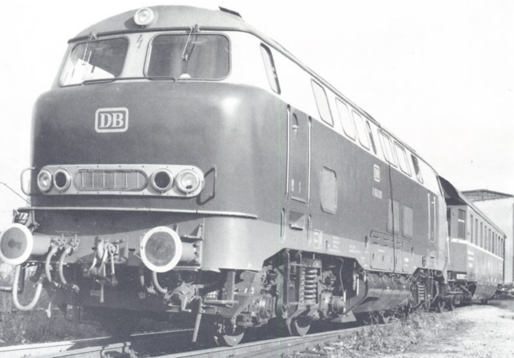
Bild 2: Die 1960 in Dienst gestellte V 160 001 wurde von der Deutschen Bundesbahn zunächst intensiv erprobt; hier ist sie mit einem Meßwagen gekuppelt. Foto: DB (G. Steidl)
