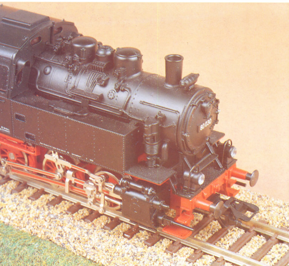
Bild 2: Hervorragend ausgeführt sind das zierliche Treib- und Steuerungsgestänge sowie die feine Imitation der Nietreihen und des Riffelblechs auf den Umläufen.
