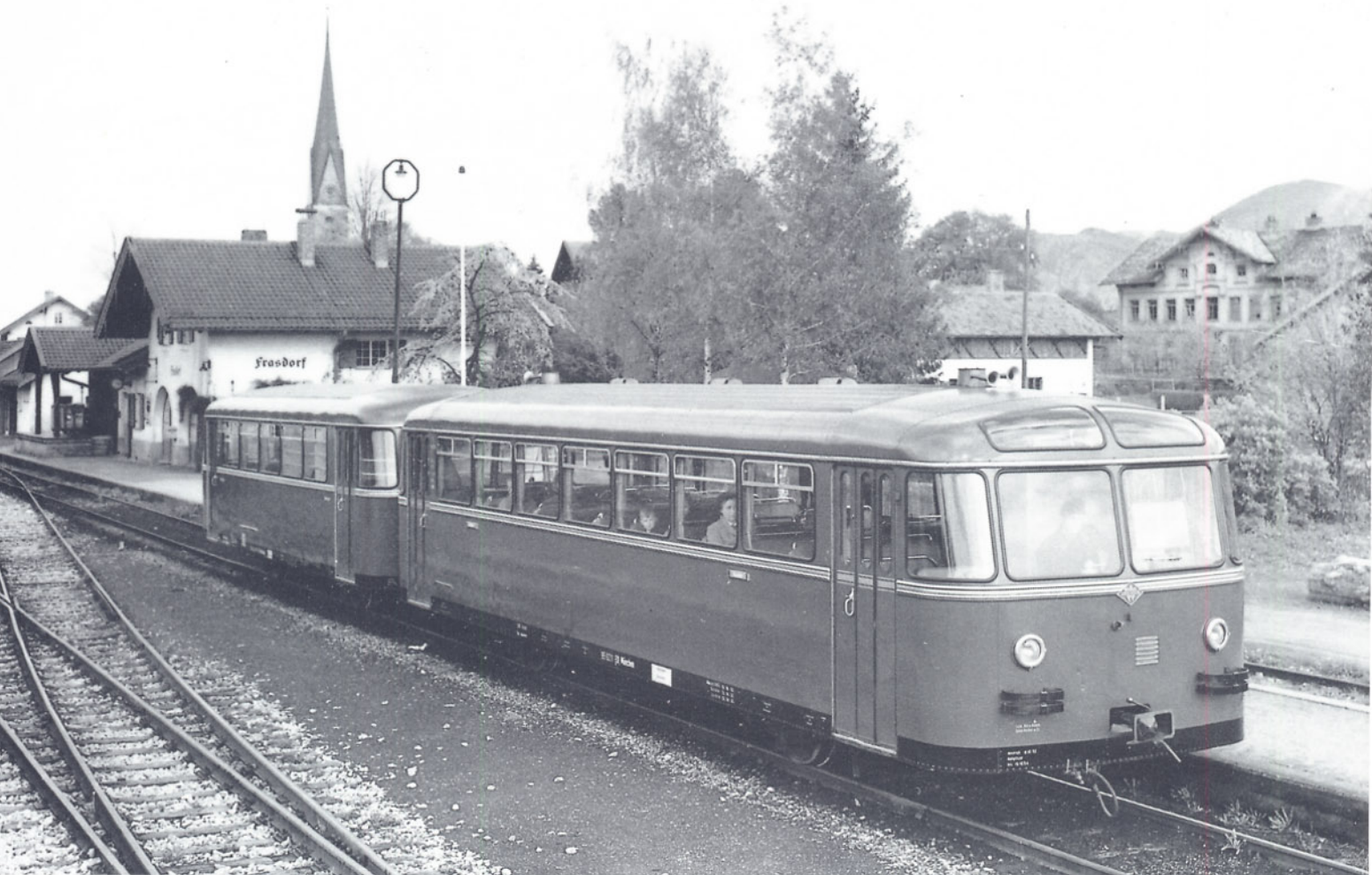
Bild 1: Der VT 95 9211 steht mit einem Beiwagen am 30.04.1953 im Bahnhof Frasdorf zur Rückfahrt nach Rosenheim bereit. Der Einsatz von einmotorigen Schienenbussen der Baureihe VT 95 auf der Nebenbahn von Rosenheim nach Frasdorf im Frühjahr 1953 erfolgte wahrscheinlich nur probeweise – mit Dampflokomotiven bespannte Personenzüge waren damals noch die Regel.
