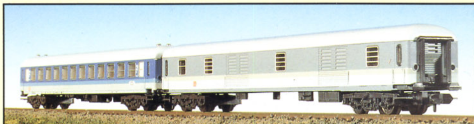
Bild 42: Mit Kurzkupplungskinematik ausgerüstet sind die InterRegio-Wagen von Minित्रix.
