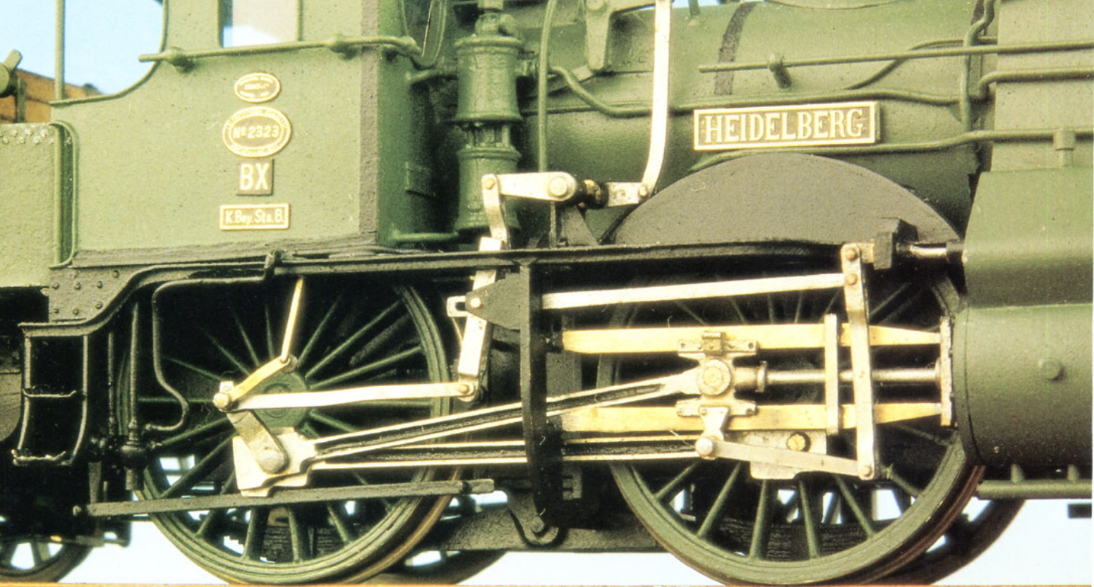
Bild 9: Die sehr zierliche handgearbeitete Steuerung mit der über den Kesselscheitel geführten Umsteuerung für die gegenüberliegende Lokseite ist hier in fast allen Details erkennbar.
