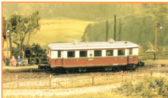
Bild 9: Die Spurkränze des VT 135 055 aus dem Hause Minitrix wurden abgedreht. Nun steht seinem Einsatz auf dem vorzüglichen Code-40-Gleis von Schuhmacher nichts mehr im Wege.
