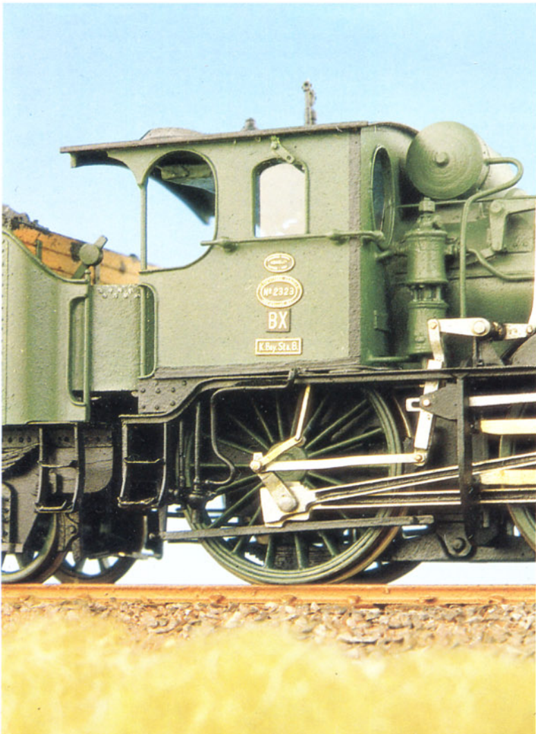
Bild 14: Als Detail wurde auch die Antriebsstange für die im Führerhaus sitzende Schmierpumpe an der Gegenkurbel angebracht.
