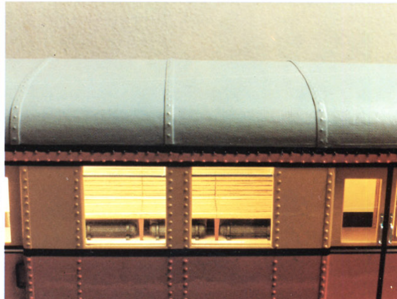
Bild 18: Die Inneneinrichtung verrät die Hand des einfallreichen Bastlers. Die Sitzbänke wurden aus Alublech geformt und mit Klebefolie bezogen, Holzdübel imitieren die Rundheizkörper.
