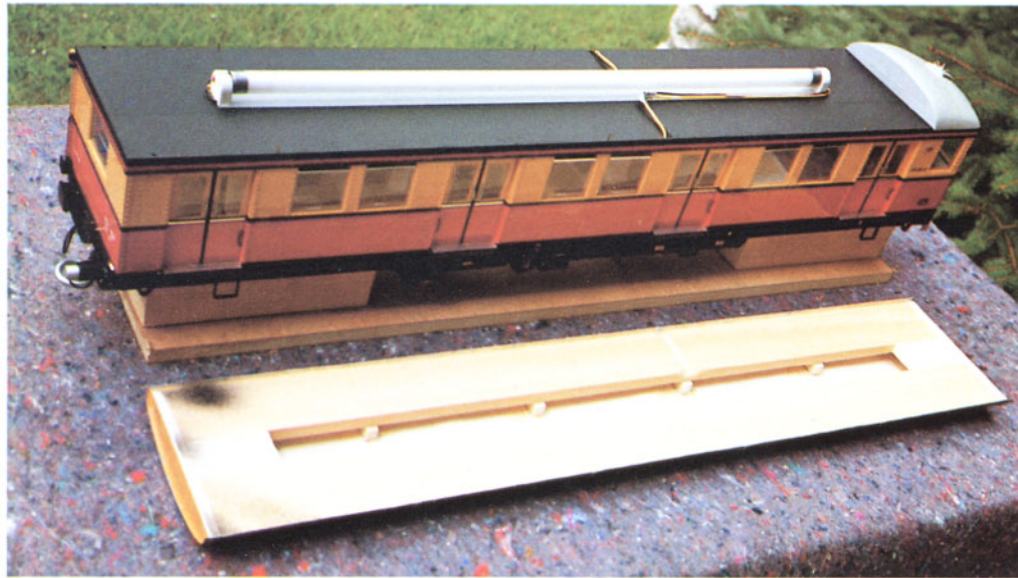
Bild 16: Die Innenbeleuchtung erfolgt mit kleinen Leuchtstoffröhren (13 W), die im flachen Dach untergebracht werden konnten. Dieses besteht aus 0,3-mm-Alublech, das auf entsprechend geformte Holzspanen geklebt wurde.
