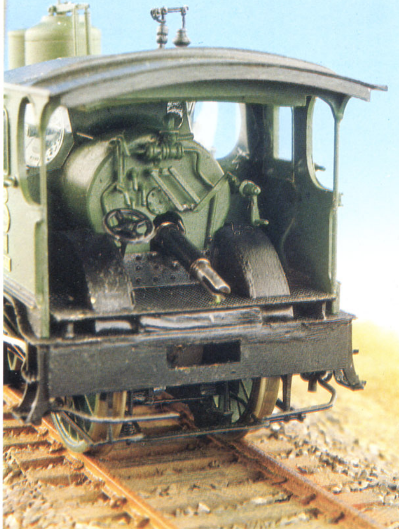
Bild 12: Die originalgetreue Nachbildung des Führerstandes. Aus dem Feuerloch ragt das Kardanteil, über das die Lok vom Tender her angetrieben wird.
