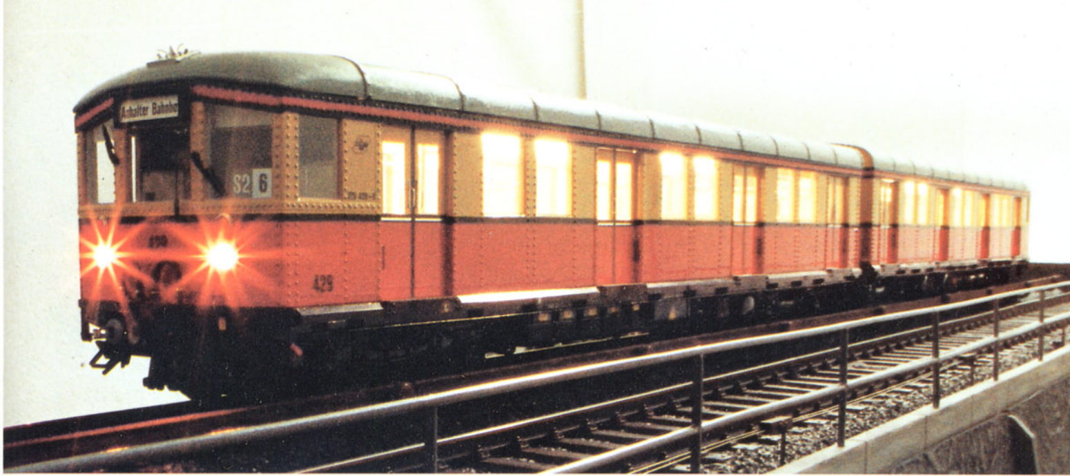
Bild 15: Selbst die Beleuchtung wurde nicht vergessen. Die Frontscheinwerfer stammen von Brawa, die Rücklichter aus dem Schiffsmodellbau.
