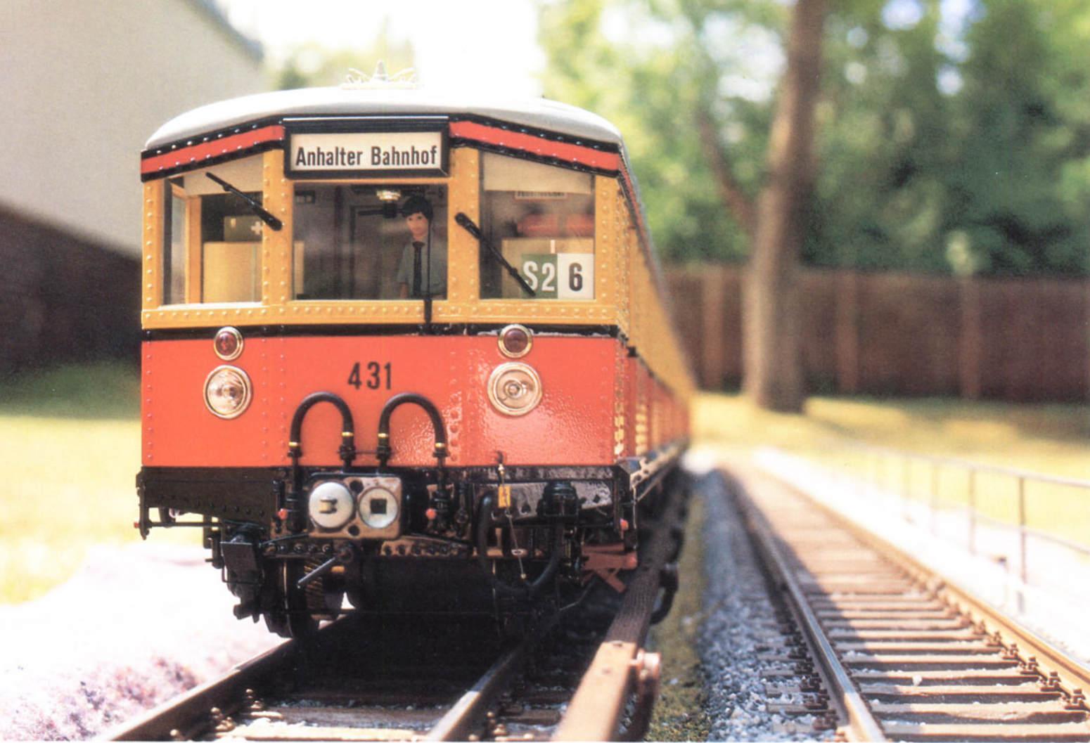
Bild 12: Frontansicht des lackierten und beschrifteten Triebzuges. Die Beschriftung entstand aus Abreibebuchstaben in diversen Größen und Farben.
