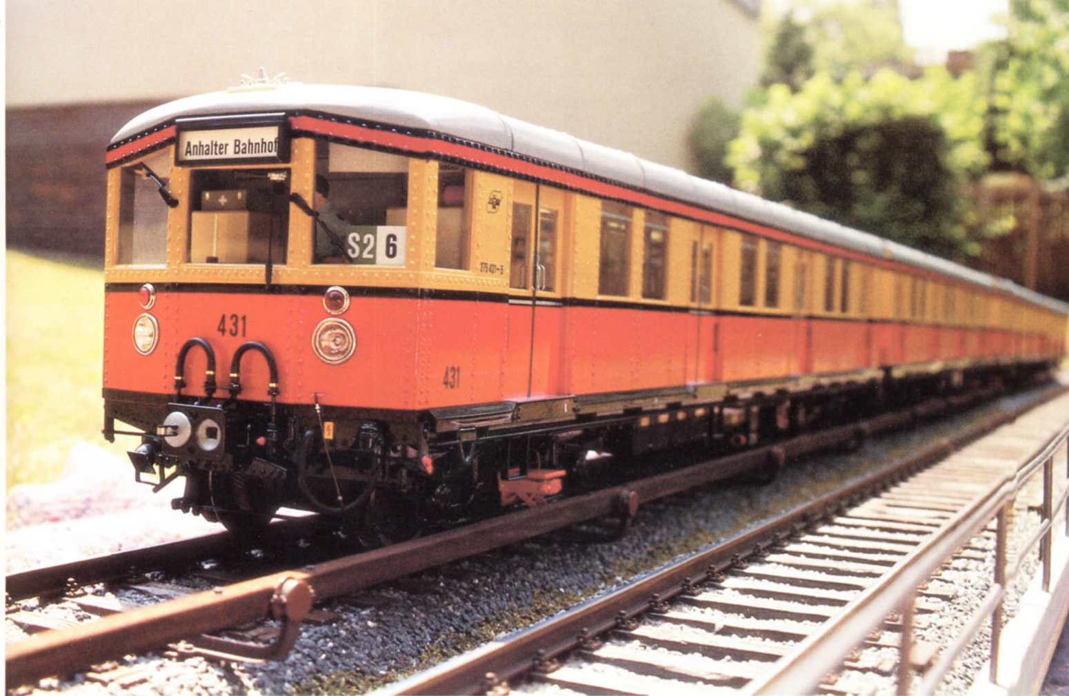
Bild 3: Hauptsächlich Acrylplexiglas wurde beim Bau dieses Triebzuges im Maßstab 1:22,5 verwendet. Der findige Bastler erhielt diesen Werkstoff – es handelte sich dabei um Reststücke – gratis von einer Schilderfirma. Die Nietensreihen bestehen aus insgesamt 6000 Rundkopfnägeln.
