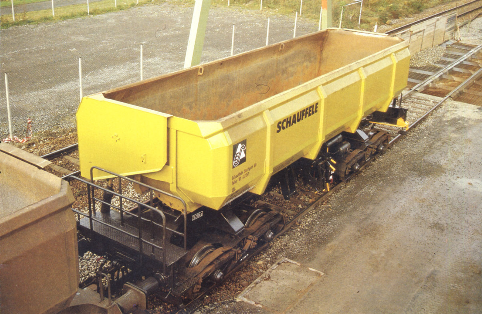
Bild 9: Dieser Blick vom Förderband läßt die glatten Innenflächen der Fahrzeuge und die breiten Kopfstücke am schmalen Langträger erkennen.
