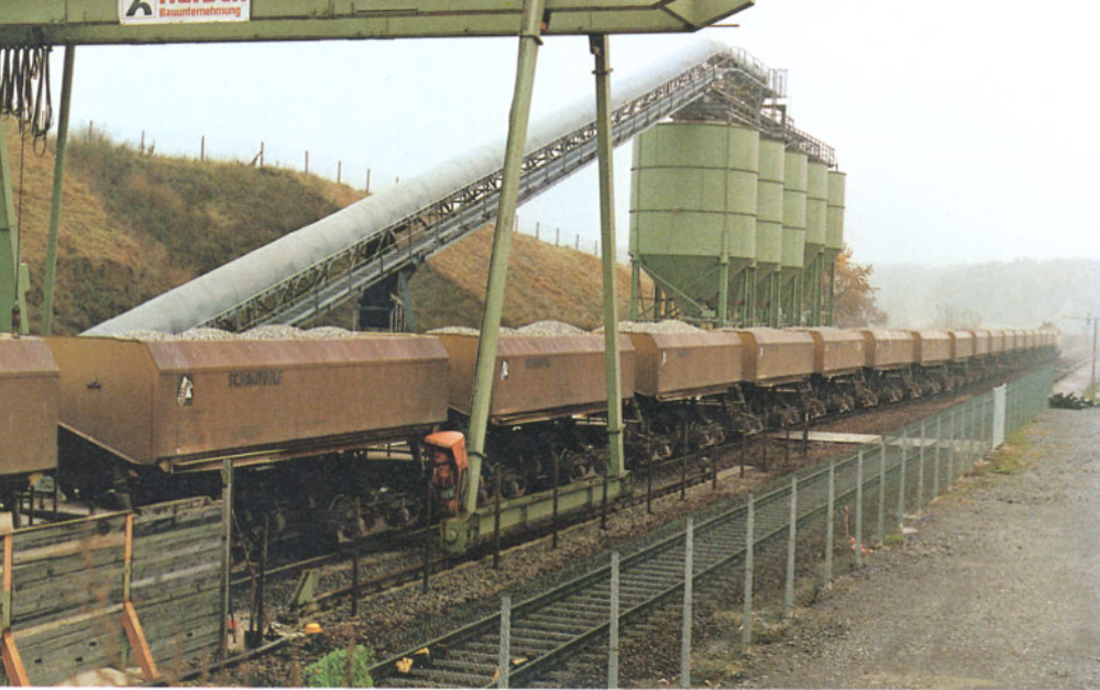
Bild 13: Die Lok hat umgesetzt, beide Garnituren sind bereits miteinander gekuppelt, die letzten Wagen werden noch entladen.
