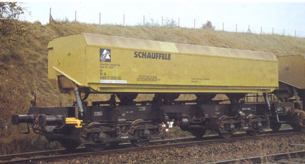
Bild 7: Klappenseite eines neuen Selbstentladewagen, den Krupp-Brünnighaus im Auftrag der Firma Schaufele gebaut hat.
