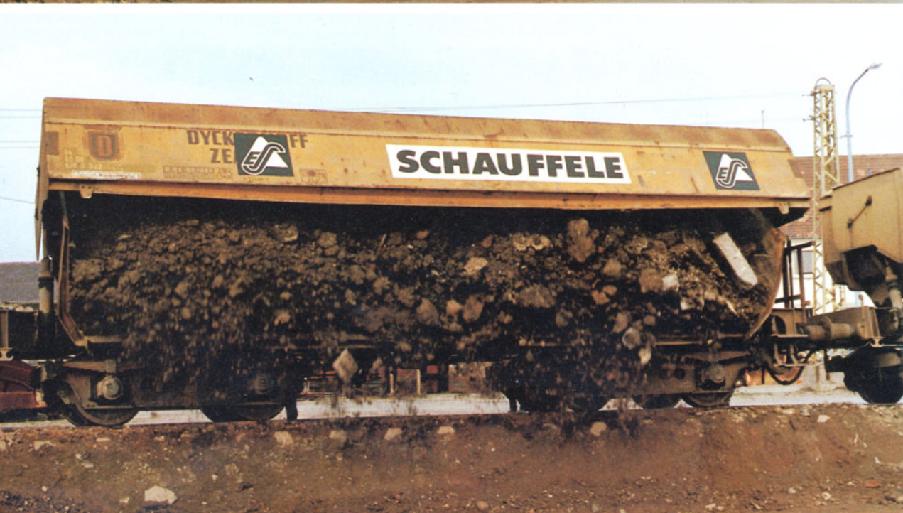
Bild 3: Die große "Maul-weite" der Selbst-ladewagen erlaubt auch die Beförderung und das problemlose Entladen in Bauer-bach von großen Gesteinsbrocken und Erdklumpen.
