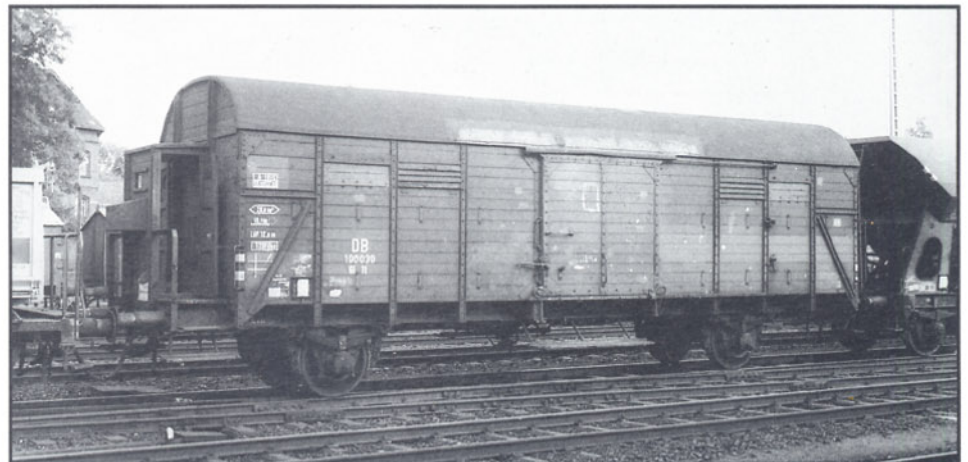
Bild 5: Der GI Dresden in Verbandsbauart (ab 1921) mit 2000 mm breiten Schiebetüren und Bremsenhaus. Foto: Sammlung Dr. Hufnagel
