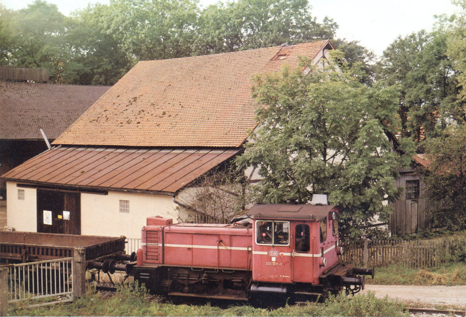
Bild 1: Die 333 102 des Bw Nürnberg 2, eine Kleinlokomotive der Leistungsklasse III, bedient im September 1987 einen Gleisanschluß in Beilngries.
