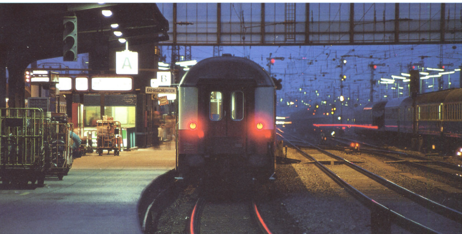
Bild 3: Die beiden roten Leuchten kennzeichnen den Zugschluß eines Intercity-Zuges, der in wenigen Minuten den Hauptbahnhof Bremen in Richtung Oldenburg verlassen wird.
