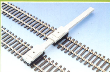
Bild 8: Überarbeitete Parallelgleis-Abstandslehre für H0 von NMW aus Messing.
