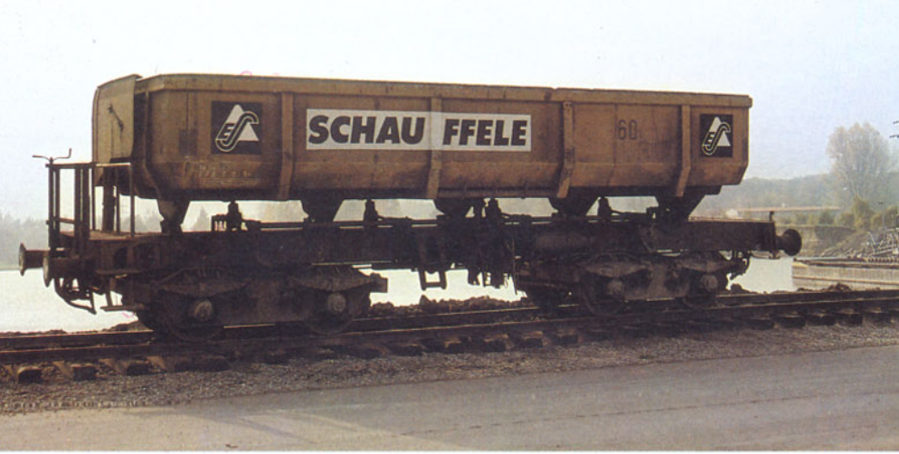
Bild 5: Einer der älteren Selbstentladewagen, die bereits im Jahr 1980 von der Firma Dyckerhoff Zement gemietet werden konnten.
