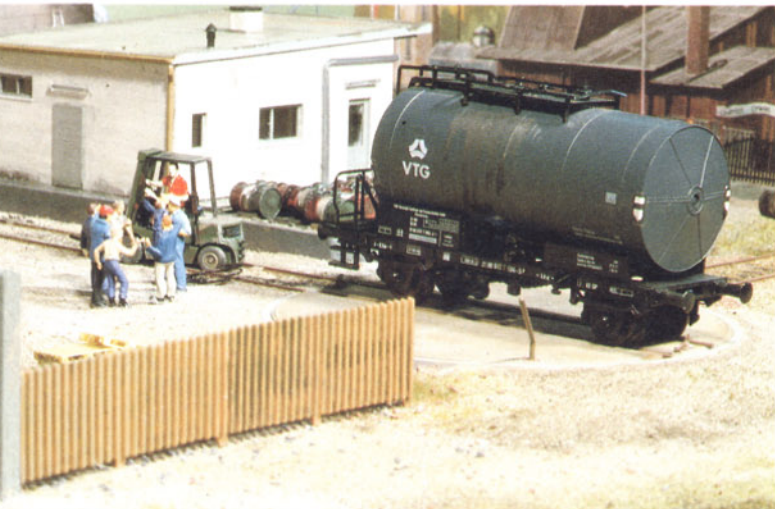
Bild 20: Das Werk ist vollbracht! Der Kesselwagen wurde um 90 Grad gedreht, die Schienenstöße stehen exakt übereinander.
