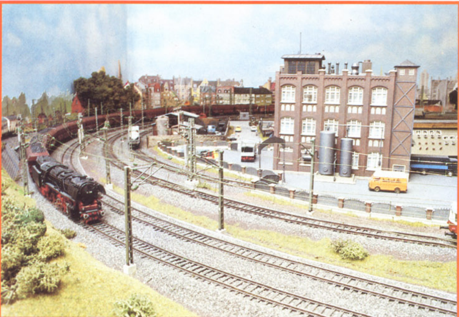
Bild 14: Vor und hinter der 44er sieht man die beiden Mittelmasten mit doppeltem Ausleger der dreifeldrigen Abspannstrecke.
