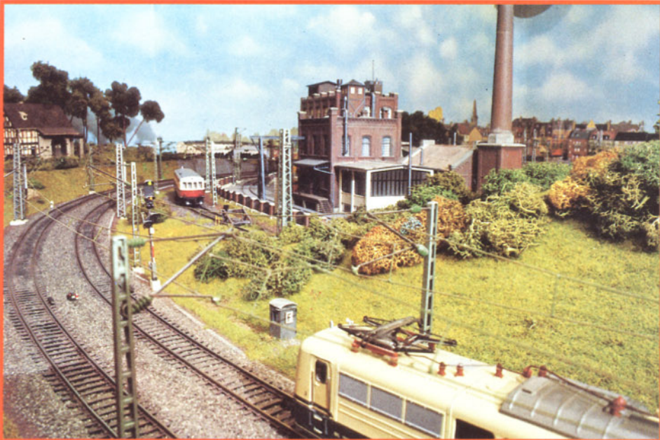
Bild 11: Beachten Sie die Mastausleger im Vordergrund: Einem Mast mit kurzem Ausleger steht ein Mast mit langem Ausleger gegenüber.
