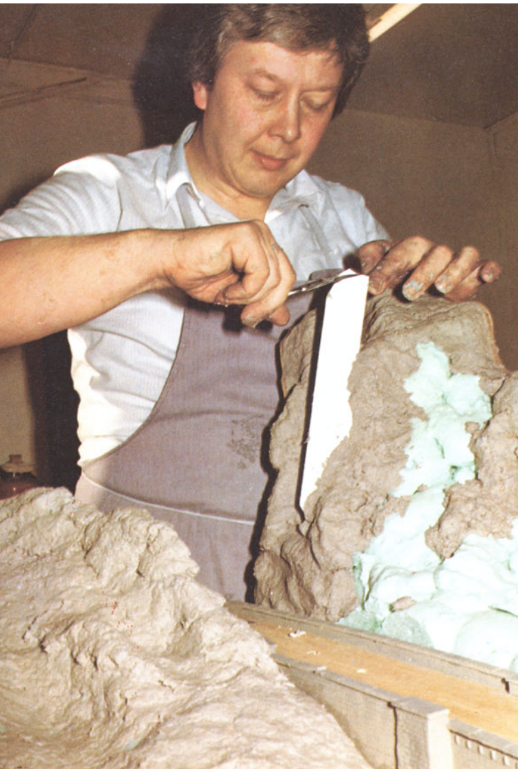
Bild 11: Bei senkrechten Bergkanten werden Streifen aus fester Wellpappe zur Unterstützung mit "eingemauert". Foto: L. Fawet
