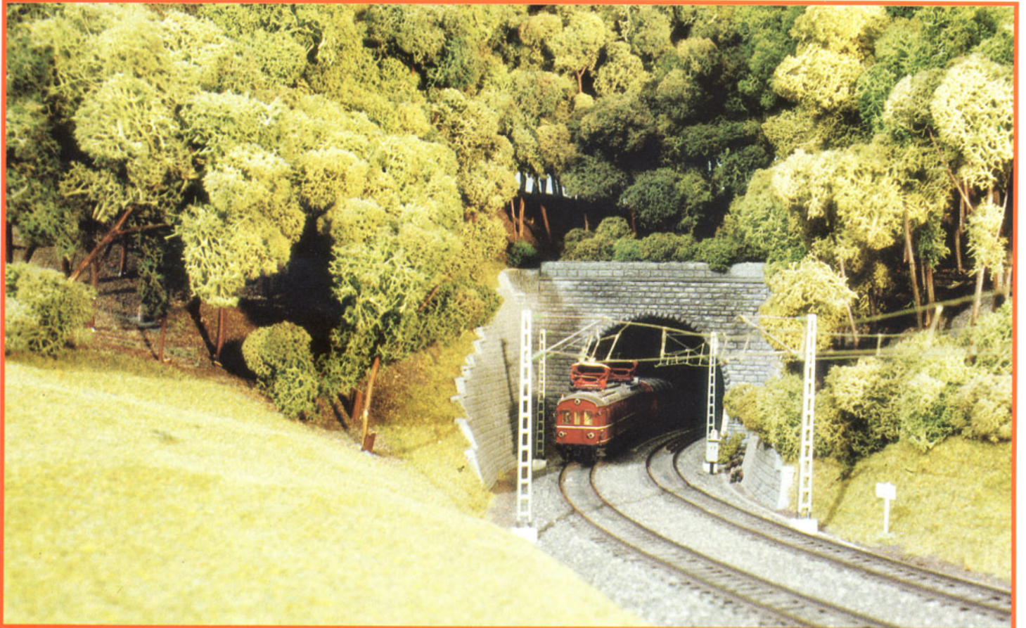
Bild 30: Ein Elektrotriebwagen der Baureihe ET 85 verläßt den "Börstinger Tunnel". Die Fahrleitung wurde im Tunnel tiefer gelegt, d.h. die Systemhöhe wurde reduziert.
