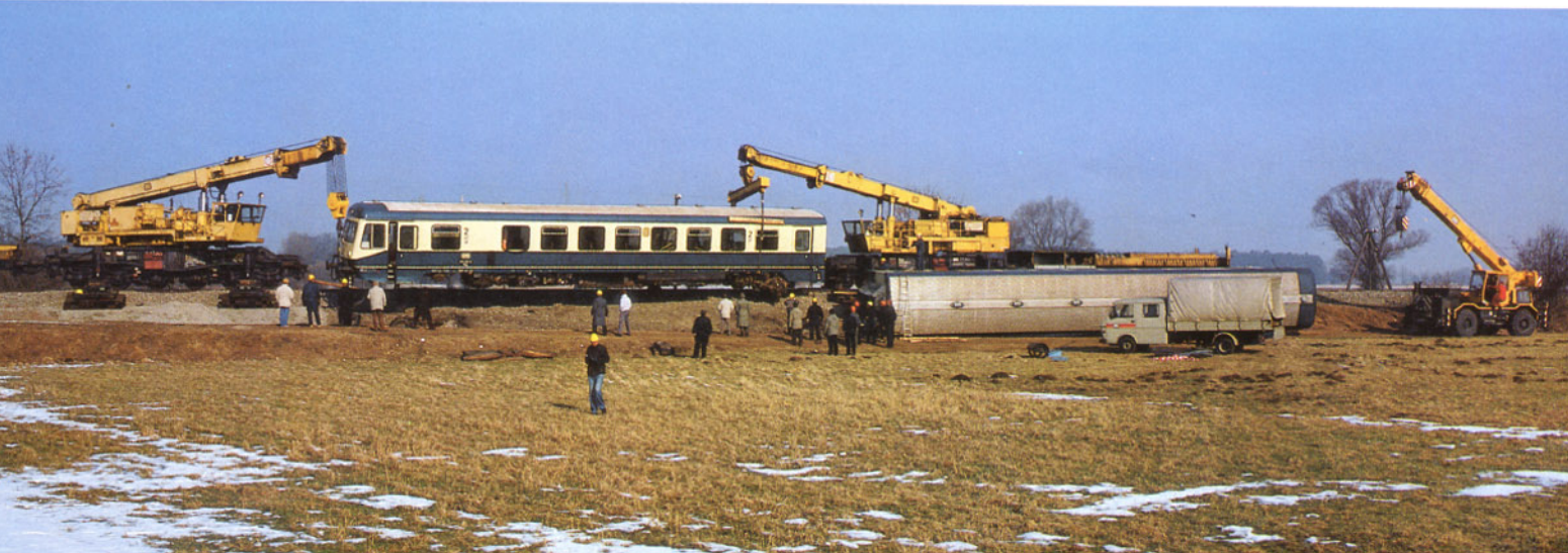
Bild 5: Die beiden Schienenkräne heben den Triebwagen 628 102 an. Im Gegensatz zum Laufgestell (links) verblieb das Triebgestell (rechts) dabei am Triebwagen.
