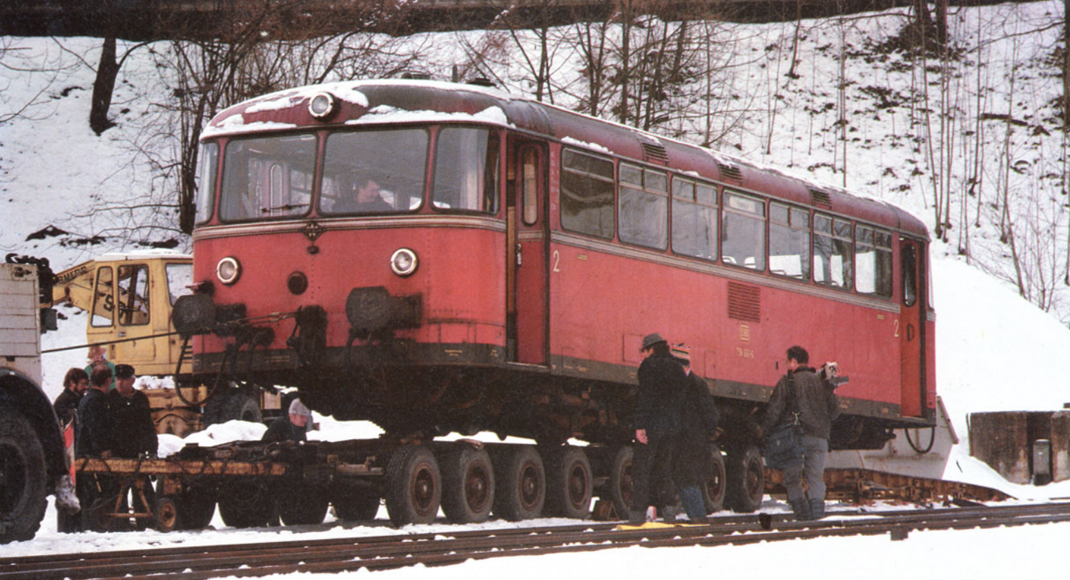
Bild 4: Aufmerksam beobachtet das Bahnpersonal die Räder des 798 651, um ein mögliches Entgleisen während des Aufladevorgangs auf den Straßenroller rechtzeitig zu erkennen.
