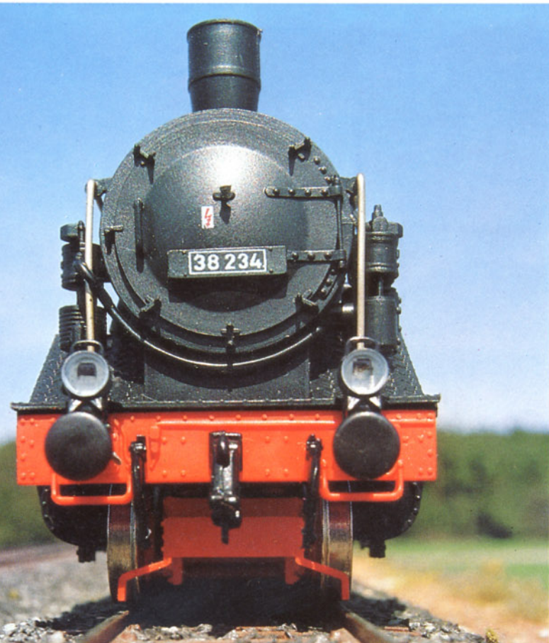
Bild 4: Das "Gesicht" der 38! Man beachte auch die besonders zierlichen Reichsbahnlaternen, die extra aufgesteckt sind.
