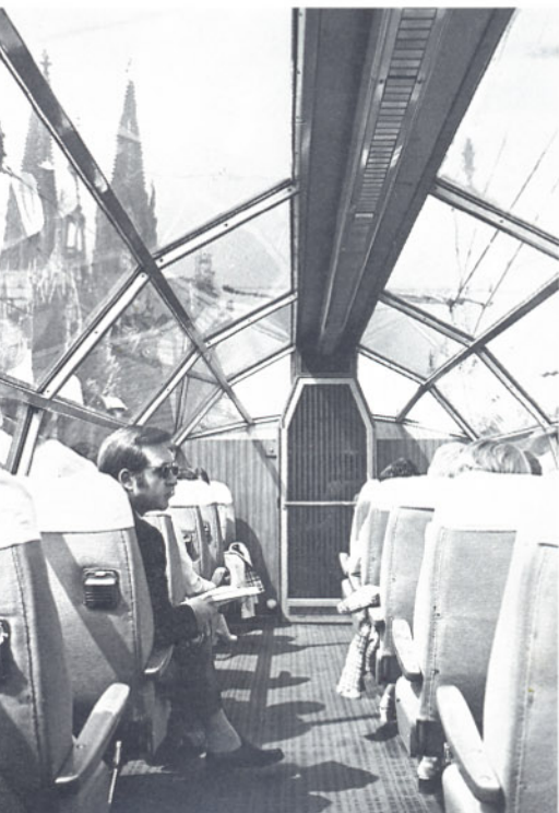
Bild 13: Ab 27. Mai 1962 verkehrten als absolute Neuheit auf deutschen Schienen im "Rheingold" erstmals Wagen mit einem Aussichtsraum im Oberdeck mit Vollsichtverglasung. Foto: H. Säuberlich
