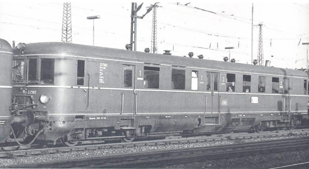
Bild 16: Auffallend sind die Lüftungsschlitze über den beiden Fenstern des Abteils 1. Klasse des VT 33 502, der am 21.02.1962 in Mannheim Hbf im Bild festgehalten wurde.
