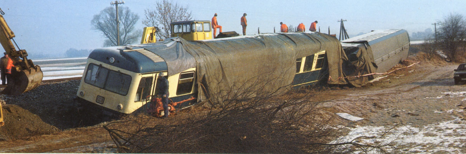
Bild 3: Durch die Wucht des Aufpralls des LKW auf das Schienenfahrzeug wurde der Triebzug aus den Schienen gedrückt und fuhr einen Bahndamm hinunter. Zum Schutz gegen Regen waren Trieb- und Steuerwagen bis zur Bergung teilweise mit Planen abgedeckt. Foto: A. Ritz
