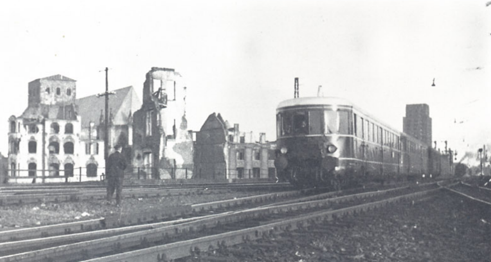
Bild 17: Der Dt 50 fährt am 10.08.1949 in Köln Hbf ein. Das Zugpaar Dt 49/50 verkehrte seinerzeit planmäßig mit zwei VT 33 und einem dazwischengekuppelten VS 145. Bei dem vorderen VT 33 handelt es sich um einen Einheitstriebwagen nach dem "Essener Grundriß".
