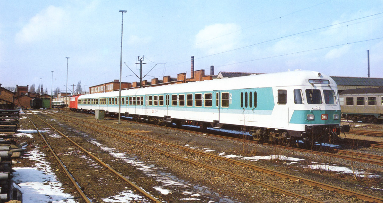
Bild 4: Die Wagen für die neue City-Bahn von Hamburg nach Stade wurden durch Umbau im AW Hannover-Leinhausen in einen Neubauzustand versetzt.
