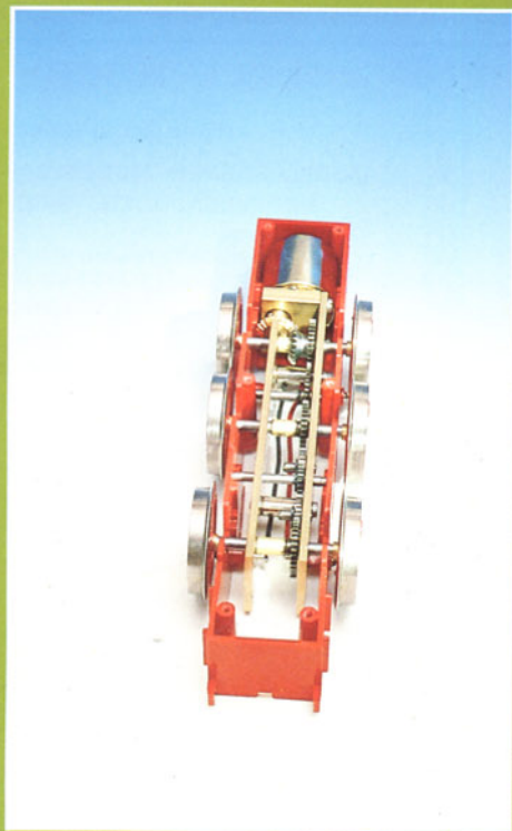
Bild 26: Durch die abgeschraubte Getriebeabdeckung wird das sinnvoll angeordnete Getriebe zugänglich.
